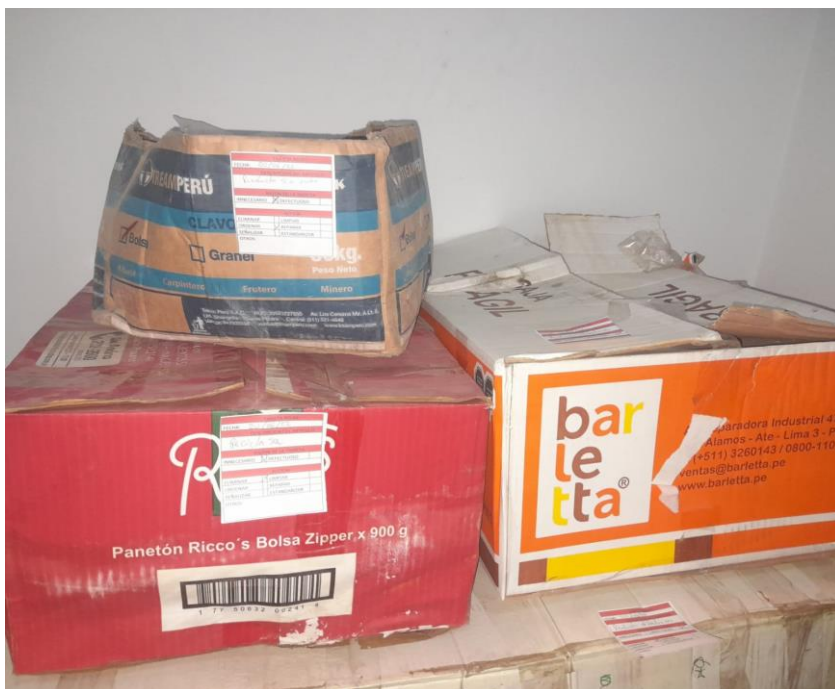
Figura 4: Selección y clasificación de los materiales mediante la etiqueta roja
