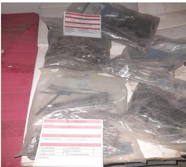
Figura 6: Selección y clasificación de los materiales mediante la etiqueta roja
