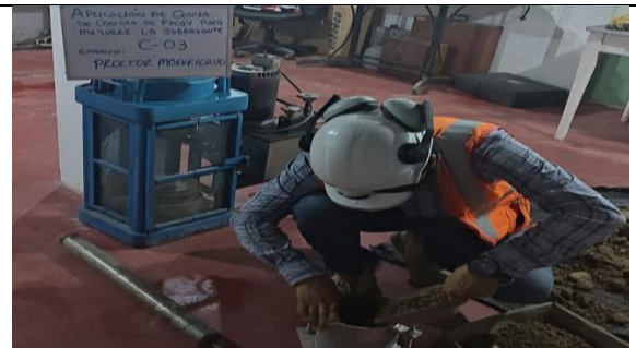
Llenado de material con muestra al 15% de Ceniza de Cascara de Pacay al molde para el Proctor Modificado
