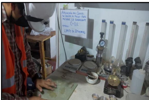
Figura 15. Ensayo del Límite Plástico con la incorporación de la ceniza de cascara de pacay
