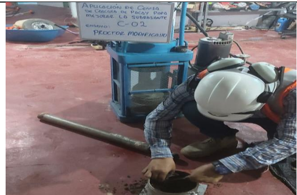
Extracción de muestra del Proctor Modificado al 10% de Ceniza de Cascara de Pacay
