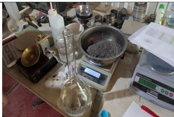
Pesaje de la Ceniza de Cascara de Pacay para la prueba del Peso Específico
