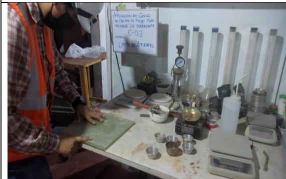
Proceso Final del Límite de Atterberg con muestra al 15% de Ceniza de Cascara de Pacay
