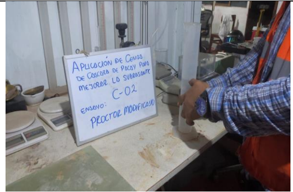
Proceso de cálculo del porcentaje de agua para muestra al 10% de Ceniza de Cascara de Pacay
