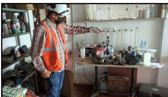
Figura 13. Proceso de Ebullición en busca del Peso Específico
