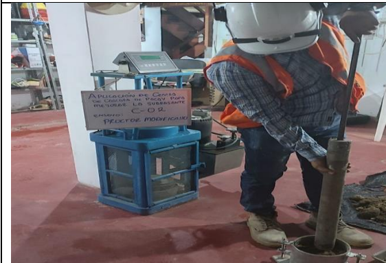
Proceso del Proctor Modificado con muestra al 10% de Ceniza de Cascara de Pacay
