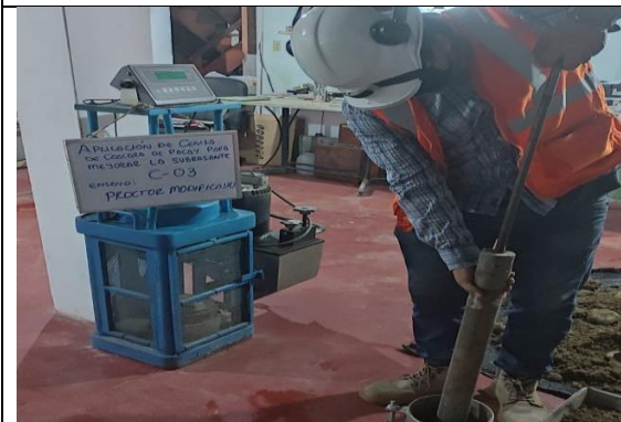
Proceso del Proctor Modificado con muestra al 15% de Ceniza de Cascara de Pacay
