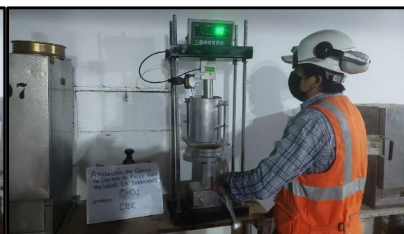
Figura 23. Ensayo del CBR con el 5% de ceniza de cascara de pacay
