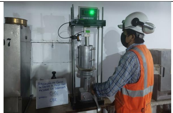
Proceso del CBR con muestra al 5% de Ceniza de Cascara de Pacay
