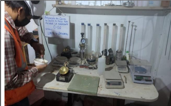
Proceso de Límite de Atterberg con muestra al 10% de Ceniza de Cascara de Pacay
