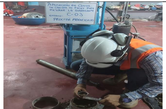
Extracción de muestra del Proctor Modificado al 15% de Ceniza de Cascara de Pacay
