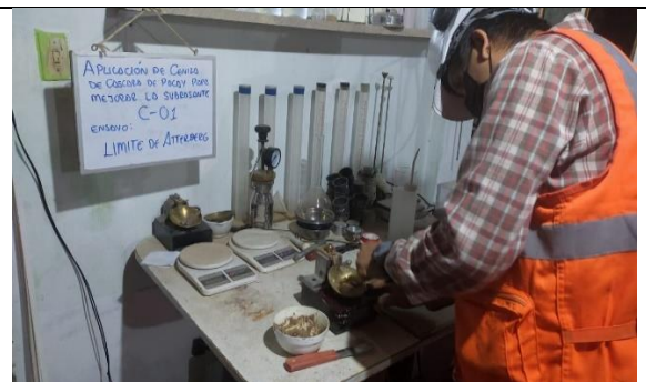
Proceso de Limite de Atterberg con muestra al 5% de Ceniza de Cascara de Pacay
