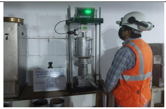
Proceso del CBR con muestra al 15% de Ceniza de Cascara de Pacay
