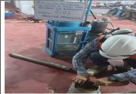
Extracción de muestra del Proctor Modificado al 5% de Ceniza de Cascara de Pacay
