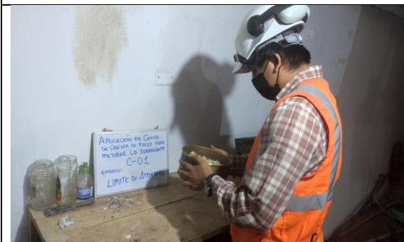
Proceso de Selección de muestra al 5% de Ceniza de Cascara de Pacay para Limite de Atterberg
