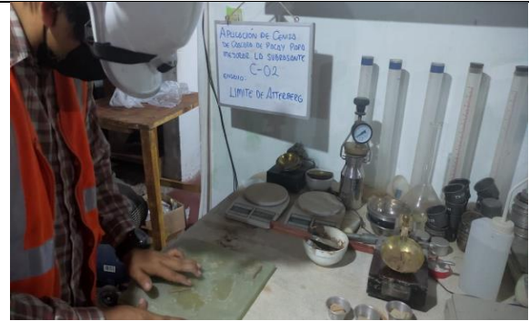
Proceso Final del Límite de Atterberg con muestra al 10% de Ceniza de Cascara de Pacay
