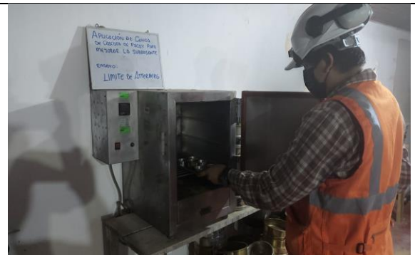
Puesta de Muestra al Horno de los Límites de Atterberg de Ceniza de Cascara de Pacay al 5%, 10% y 15%
