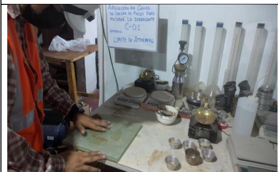
Proceso Final del Limite de Atterberg con muestra al 5% de Ceniza de Cascara de Pacay
