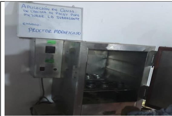
Puesta de Muestra al Horno del Proctor Modificado de Ceniza de Cascara de Pacay al 5%, 10% y 15%
