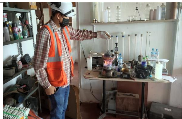
Proceso de la Prueba del Peso Específico
