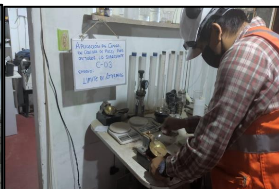
Figura 16. Ensayo con Casa Grande incorporado al material la ceniza de cascara de pacay
