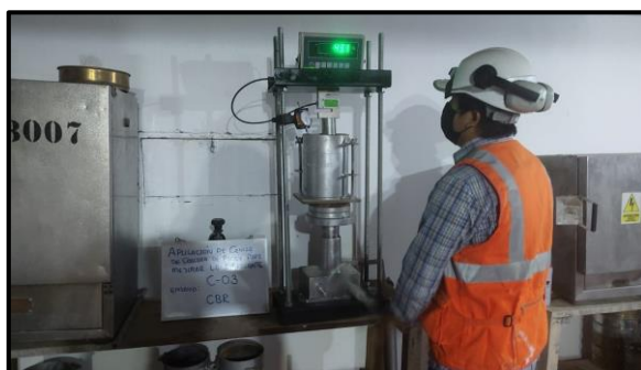
Figura 22. Ensayo del CBR con el 15% de ceniza de cascara de pacay
