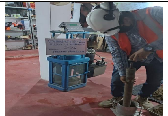
Proceso del Proctor Modificado con muestra al 5% de Ceniza de Cascara de Pacay
