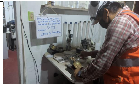
Proceso de Límite de Atterberg con muestra al 15% de Ceniza de Cascara de Pacay
