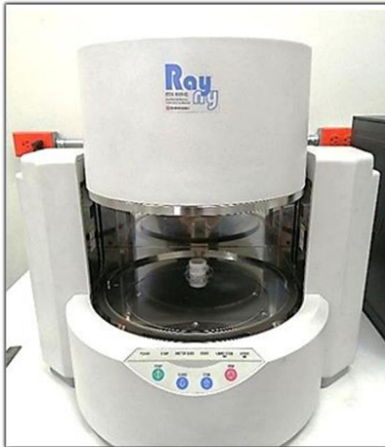
*Figura 32.* Espectrómetro de Fluorescencia de rayos x
