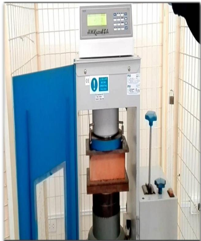
*Figura 12. Prueba de resistencia a la compresión*
