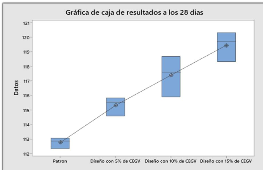
Figura 62. Gráfico cajón de resistencia a compresión en pilas
