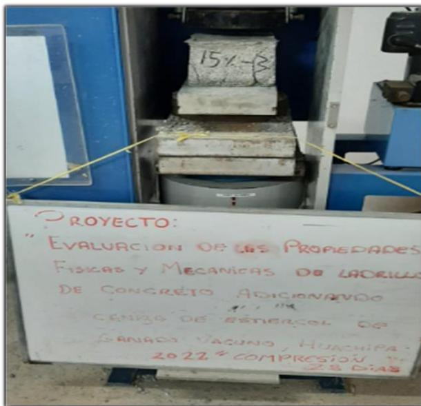
**Fotografía 15.** . Rotura de ladrillos con 15% CEV
