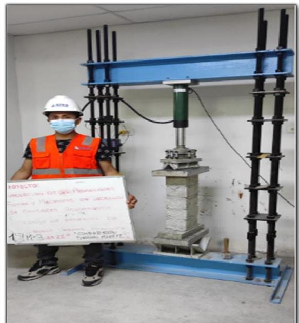
**Fotografía 16.** Rotura de resistencia a compresion en pilas a 28 días
