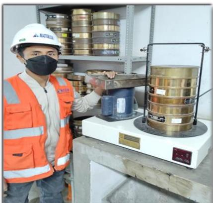
**Fotografía 5. Tamizado del agregado**
