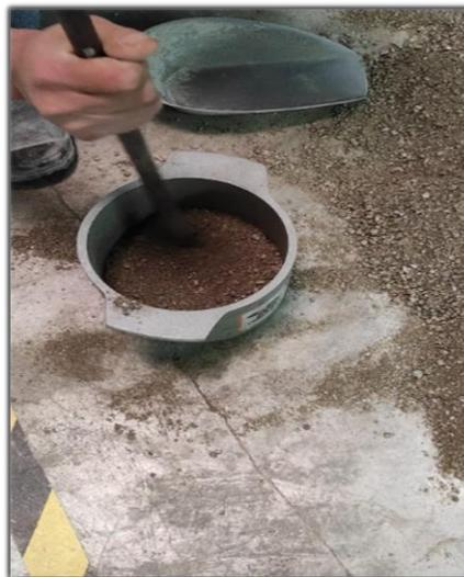
*Figura 27.* Ensayo de peso unitario compactado
