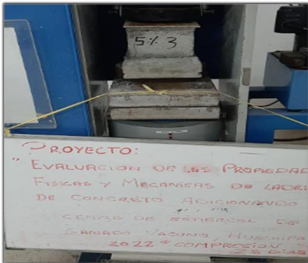
**Fotografía 13.** Rotura de ladrillos con 5% CEV
