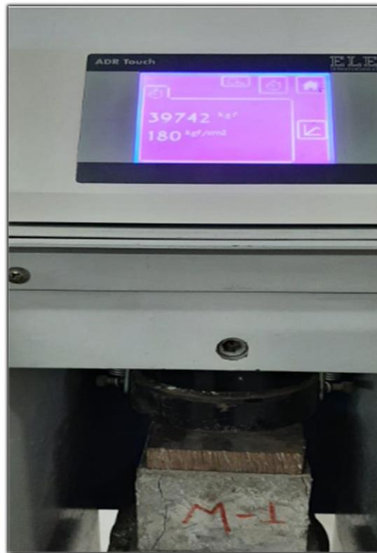
Figura 37. Ensayo de compresión en unidades a 14 días
