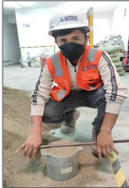
*Figura 26.* Ensayo de peso unitario suelto
