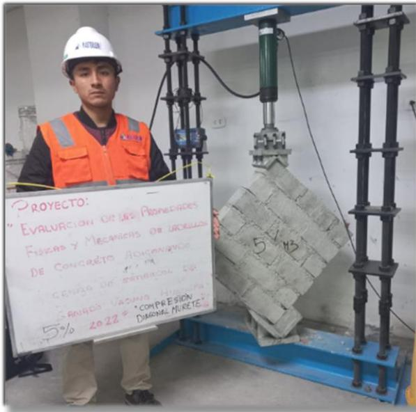
**Fotografía 17.** Rotura de resistencia a compresión en muretes a 28 días
