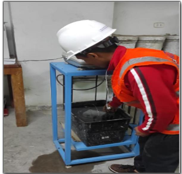
**Fotografía 18.** Ensayo de Absorción
