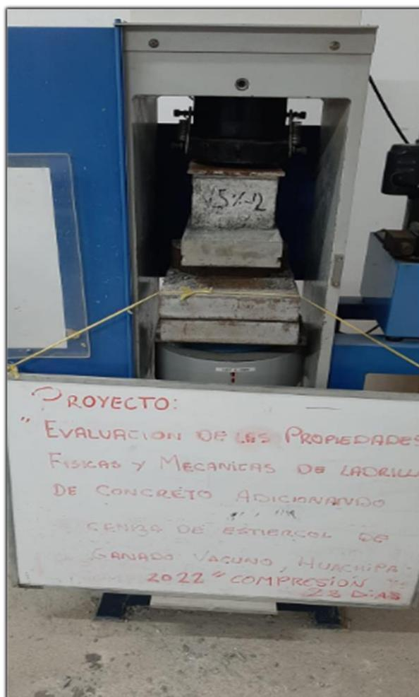
Figura 40. Ensayo de compresión en unidades a los 28 días
