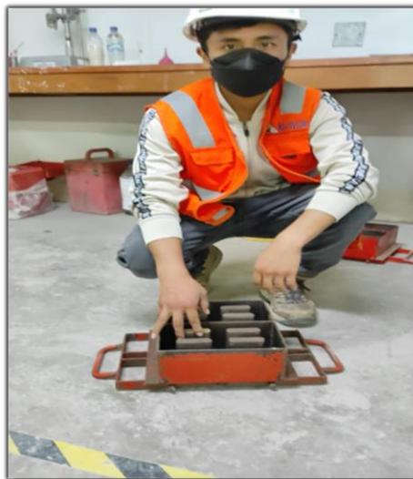
*Figura 29.* Molde del ladrillo
