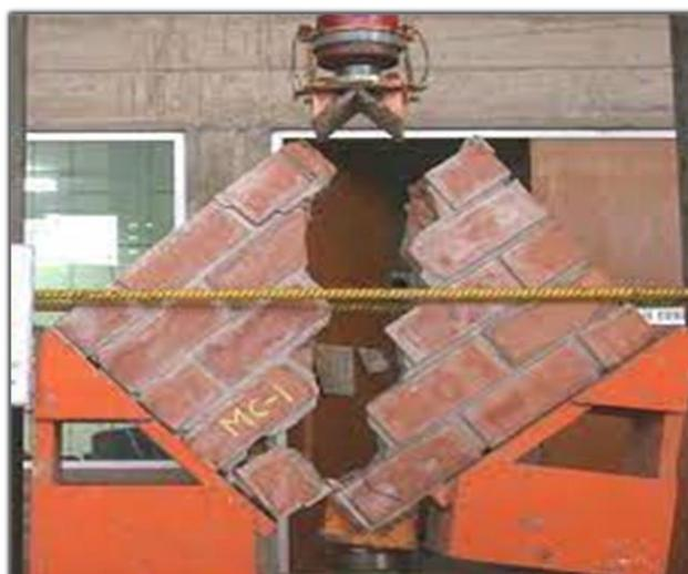
*Figura 14. Ensayo de compresión diagonal.*
