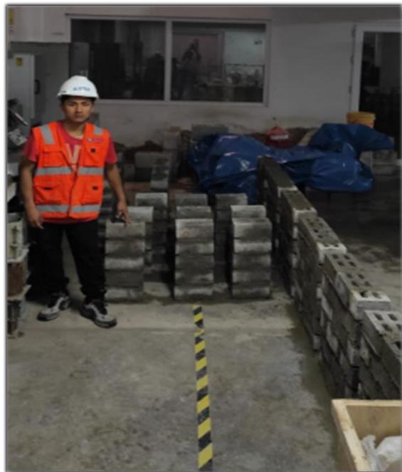
*Figura 31.* Muestras de pilas y muretes
