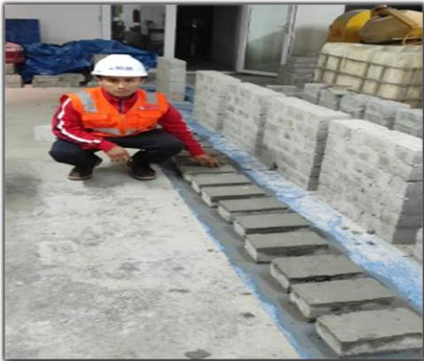
**Fotografía 11.** Preparación para el ensayo a compresión en unidades
