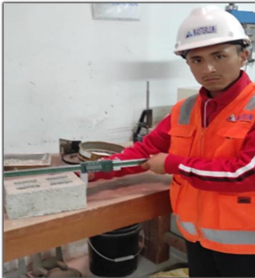
**Fotografía 19.** Ensayo de dimensionamiento
