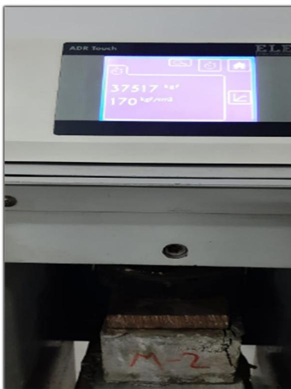
Figura 34. Ensayo de compresión en unidades a 7 días
