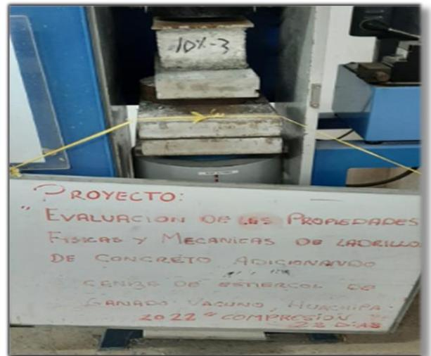
**Fotografía 14.** Rotura de ladrillos con 10% CEV
