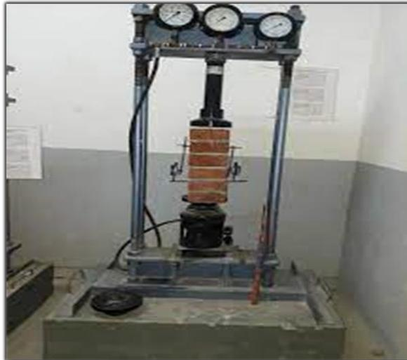
*Figura 13. Prueba de compresión por pilas*
