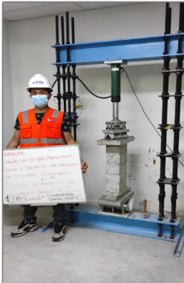
Figura 50. Ensayo de compresión en pilas
