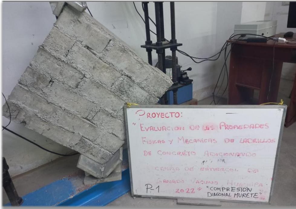
Figura 52. Ensayo de compresión en muretes.
