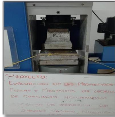
**Fotografía 12.** Rotura de Ladrillos patrón
