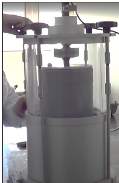
Figura 6: Ensayo de módulo resiliente.
