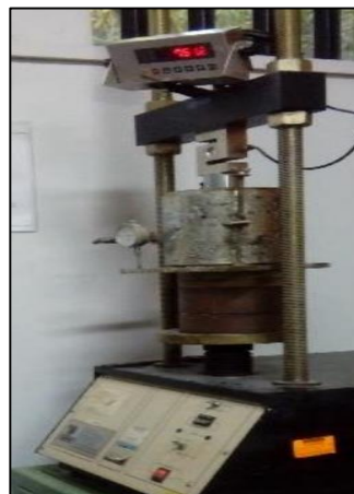
Figura 5: Ensayo de CBR.
