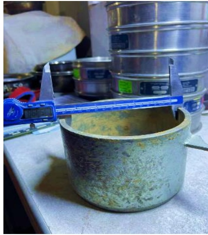
Figura 24: Toma de medidas del molde de 6" para el ensayo de Proctor Modificado.
