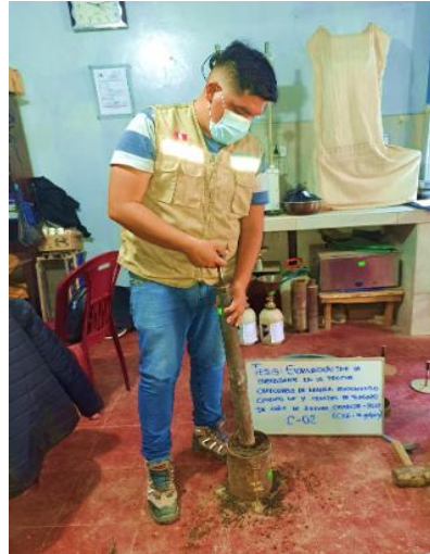
Figura 28: Compactación con martillo manual para CBR
