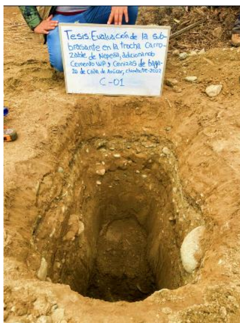
Figura 11: Estratos de la calicata 1 (C-01)
