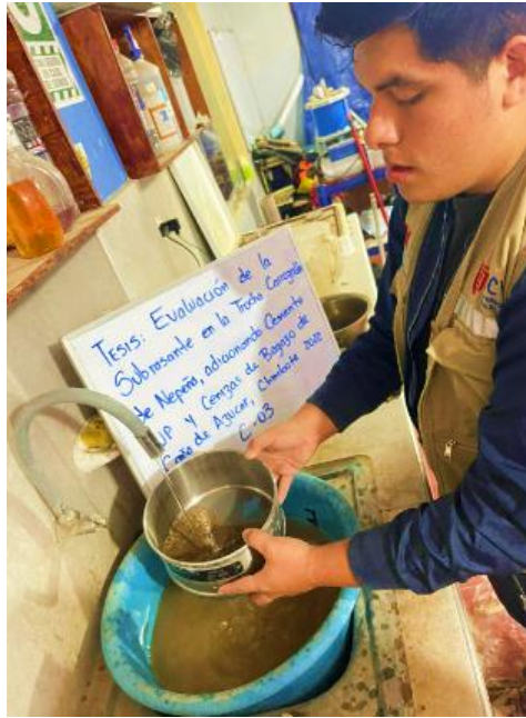
Figura 18: Lavado de agregado fino para eliminación de arcillas y limos
