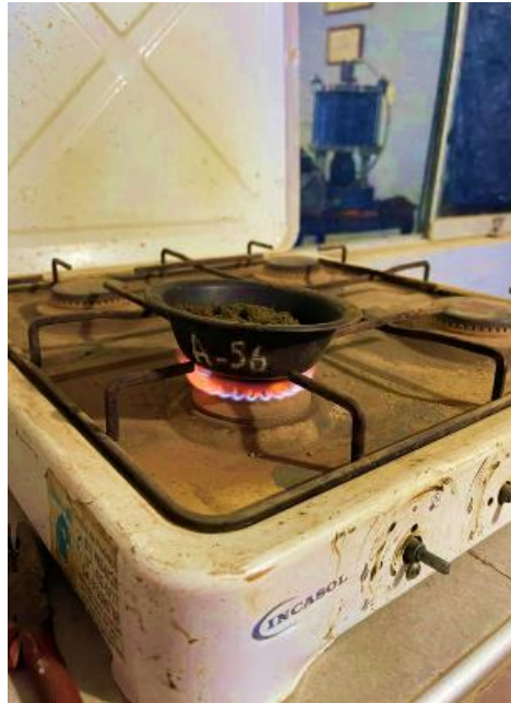
Figura 26: Secado de material compactado en estufa para contenido de humedad
