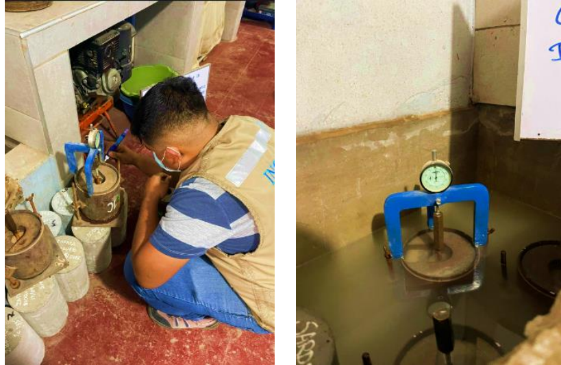
Figura 30: Toma de expansión
