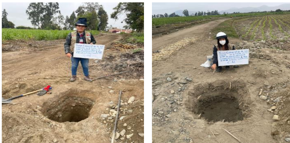
Figura 2: Realización de calicatas
