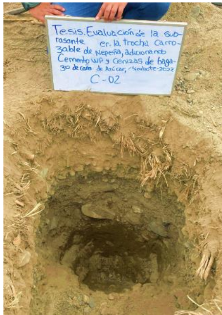
Figura 13: Estratos de la calicata 2 (C-02)
