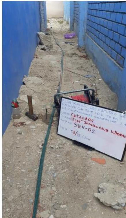
Figura 30. Ejecución de la inducción de corriente al suelo SEV-02
