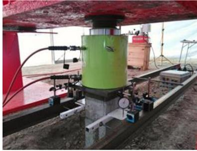
*Figura 16.* Instrumentación de prueba de carga a compresión.
