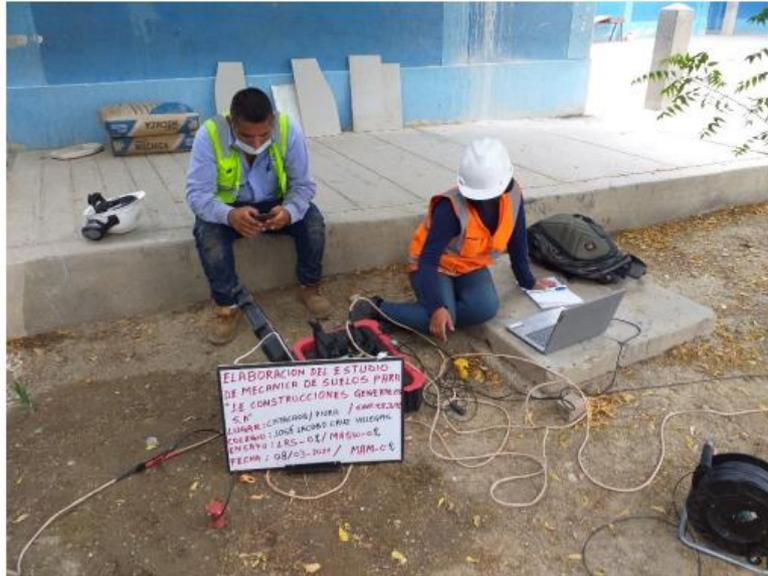
Figura 29. Ejecución del Shot del Sondaje MAM-02
