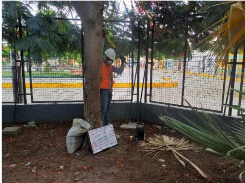
*Figura 27. Ejecución del Shot del Sondaje MASW-01*
