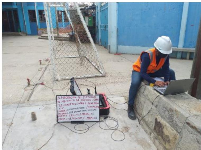
*Figura 28. Ejecución del Shot del Sondaje MAM-01*
