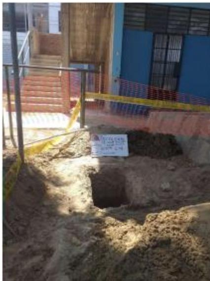
Figura 7. Calicata identificada como C-4. Se realizó una inspección visual del estrato y se procedió a su descripción para luego tomar muestras para los diferentes ensayos.
