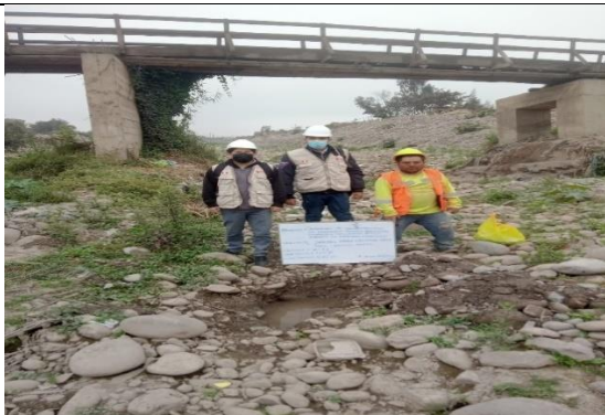
Imagen 11. Toma de muestra calicata 1
