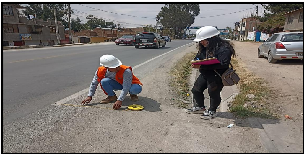
FOTOGRAFIA 4: Tomando la medida de las condiciones geométricas de la vía: ancho de hombrera o berma de la intersección Las Américas y Necochea
