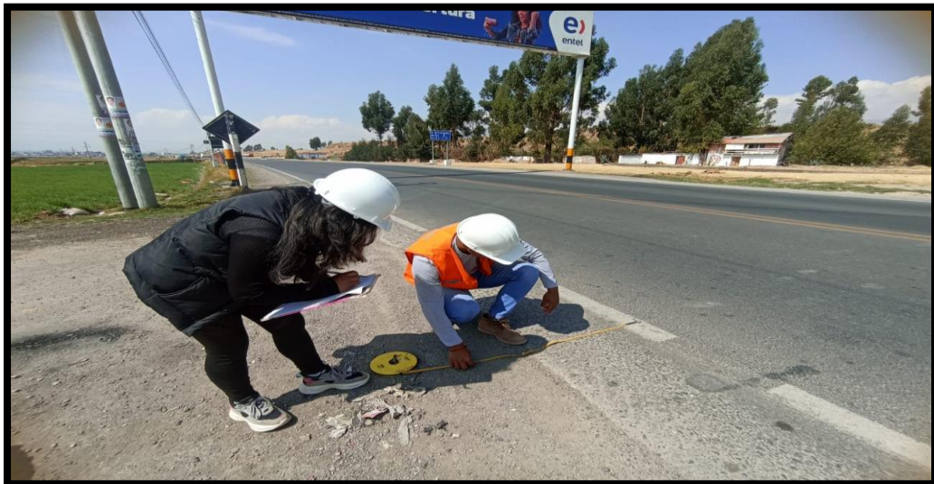
FOTOGRAFIA 12: Tomando la medida de las condiciones geométricas de la vía: ancho de hombrera o berma de la intersección Las Américas y Cruce con Sicaya
