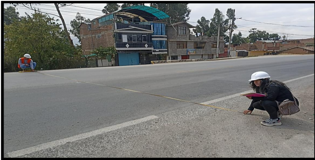
FOTOGRAFIA 3: Tomando la medida de las condiciones geométricas de la vía: sección transversal de la intersección Las Américas y Necochea
