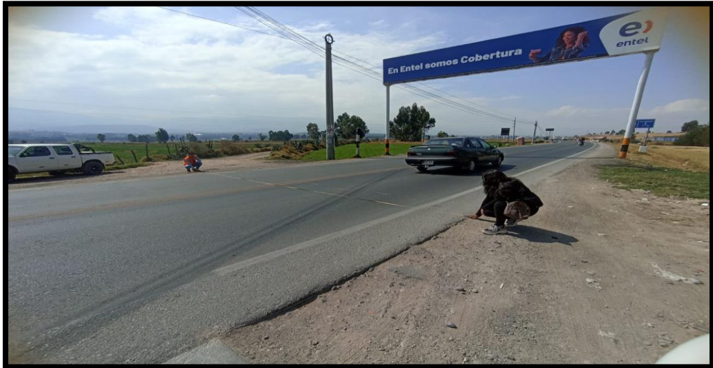
FOTOGRAFIA 11: Tomando la medida de las condiciones geométricas de la vía: sección transversal de la intersección Las Américas y Cruce con Sicaya
