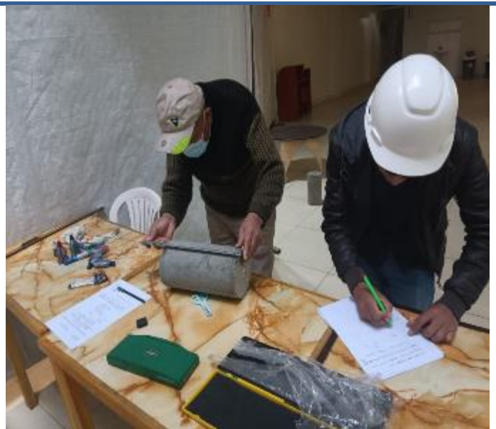
Medición de Diámetro y longitud de probeta para ensayo de resistencia tracción
