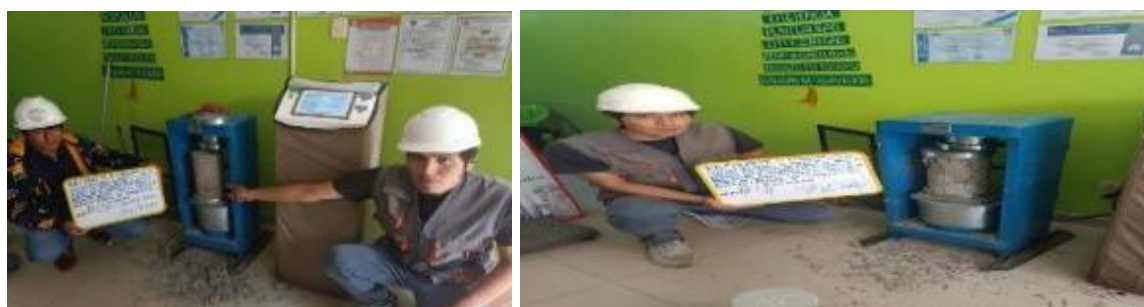
Figura 119. Determinación de rotura en resistencia axial de compresión de 7 días
