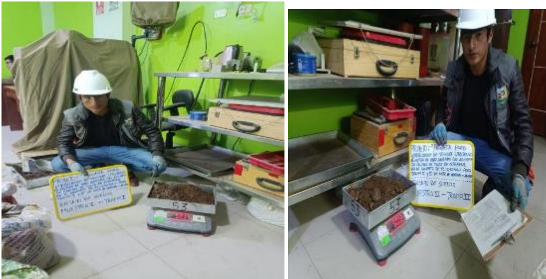
Figura 84. Pesado en el recipiente la muestra obtenida sin lavar P.1905.O gr.
