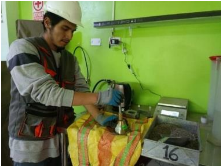
FIGURA 44. Cono Truncado ensayo al agregado fino
