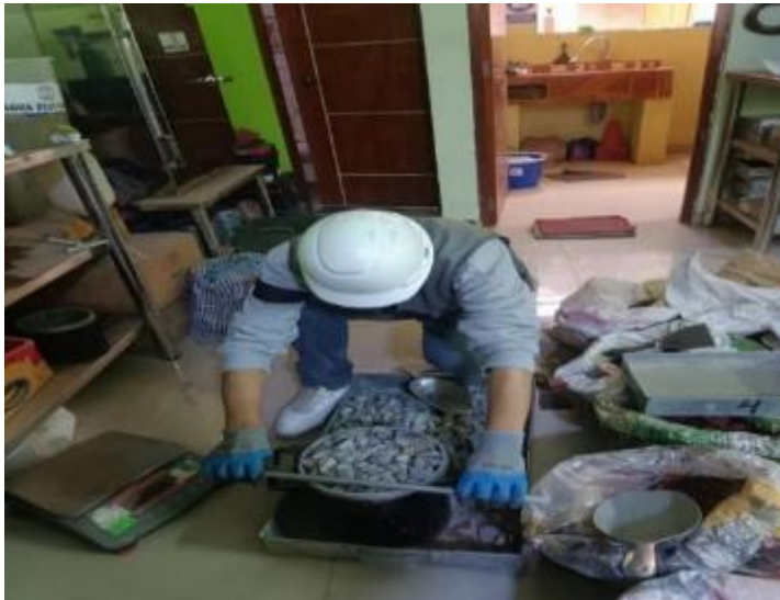
Figura 55. Enrasado del agregado fino corregido sobrante con la varilla de acero
