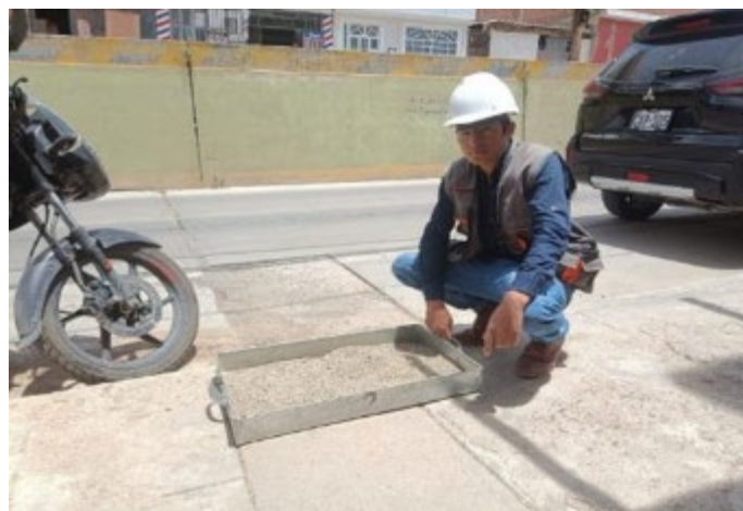
FIGURA 34. Secar previamente la muestra del agregado al sol
