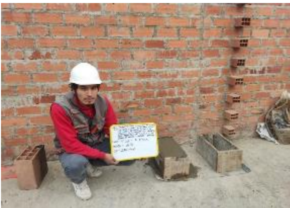
Vigas de Flexión de adición de CTA de 3%, 6% y 9% para 28 días de edad
