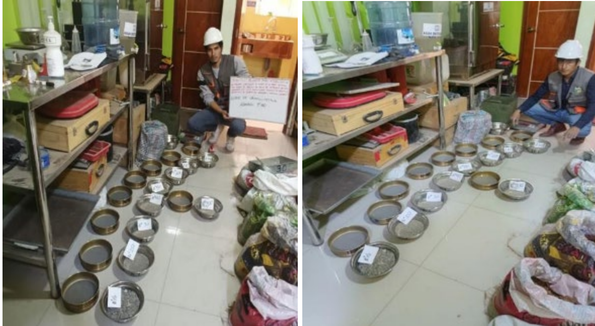
FIGURA 37 .Agregado fino retenido en cada tamiz para calcular Granulometría
