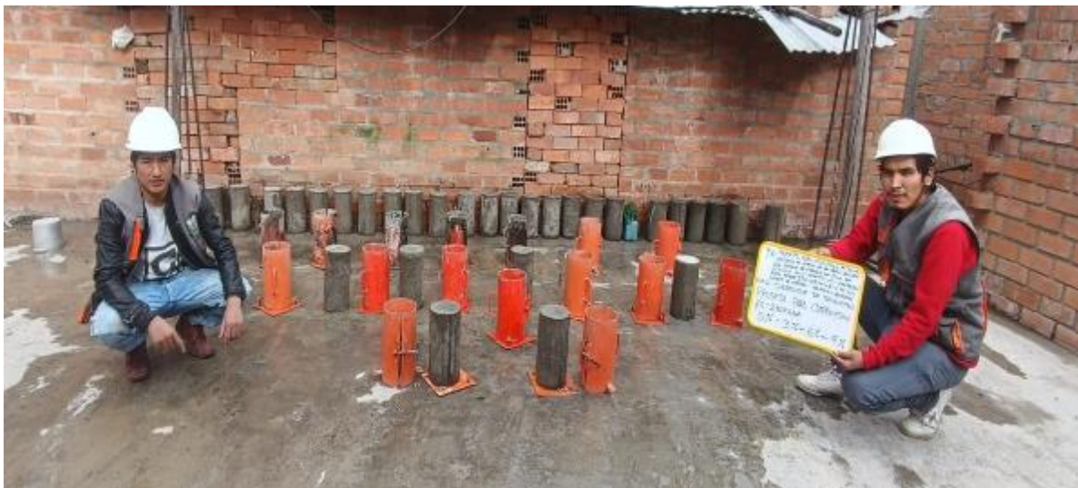
Figura 75. Desmolde de briquetas de 0 % 3% 6 % 9% para ensayo de tracción
