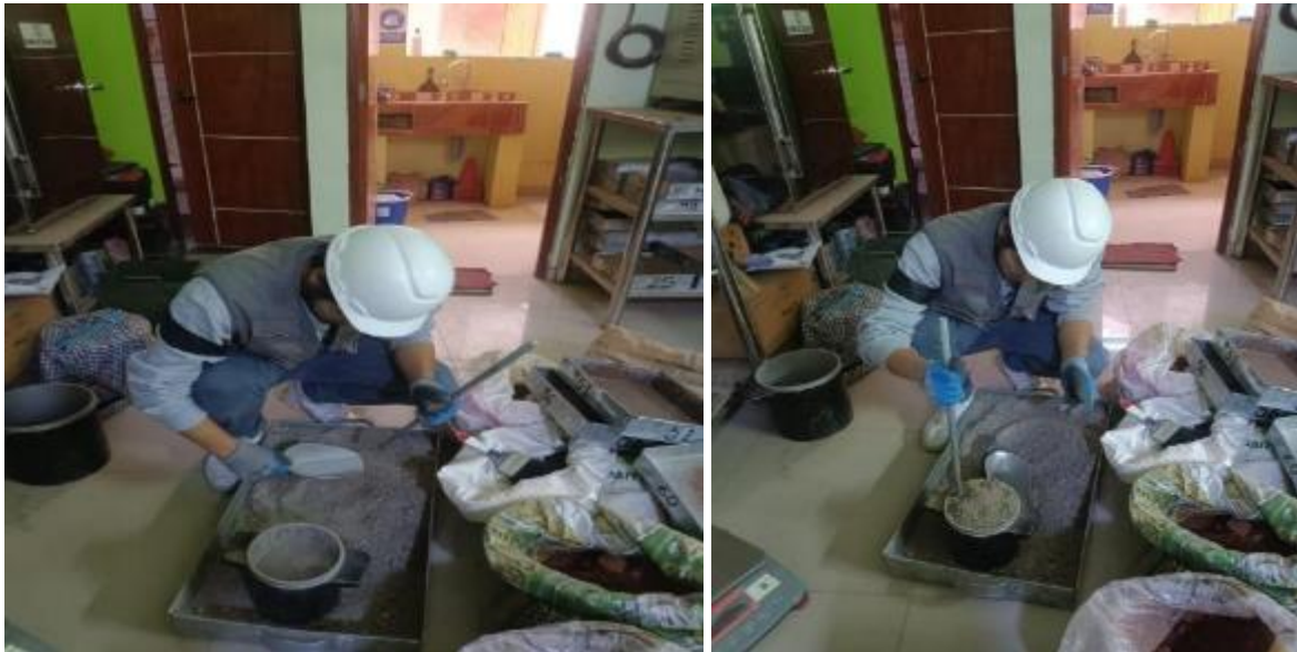
Figura 53 .Llenado y apisonado del agregado fino en el Proctor modificado
