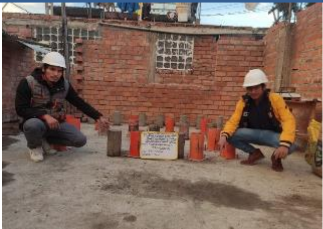
Vigas de Flexión de adición de CTA de 3%, 6% y 9% para 28 días de edad
