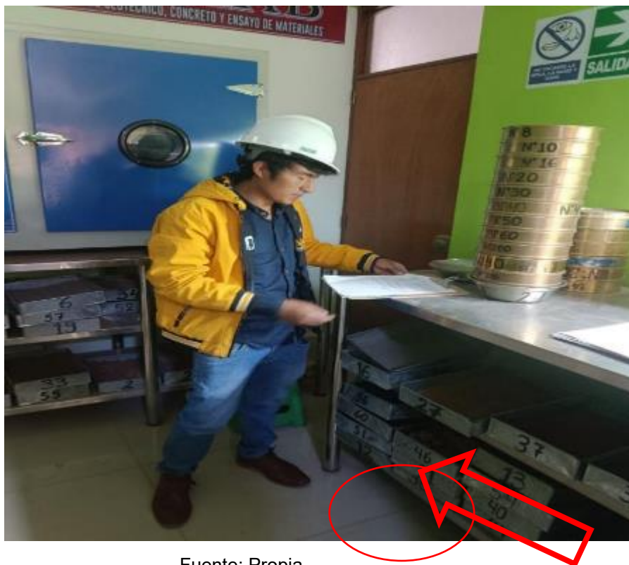
FIGURA 45. se realizó seco media por un corriente e aire y sol de agregado fino
