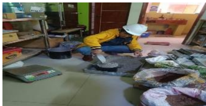
FIGURA 48 .Llenado del Proctor modificado con agregado fino
