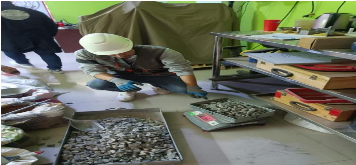
FIGURA 42. Pesado de Taras de agregado grueso.
