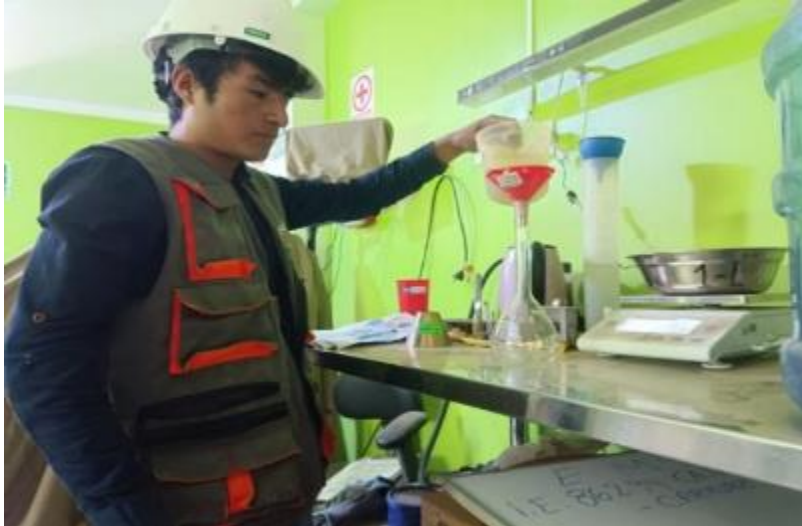
FIGURA 44. Cono Truncado ensayo al agregado fino
