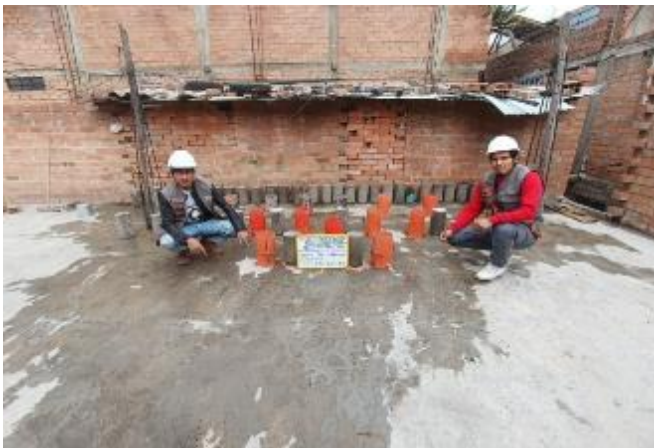
Vigas de Flexión de adición de CTA de 3%, 6% y 9% para 28 días de edad
