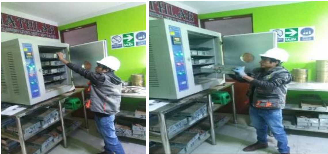
Figura 86. Colocación en el Horno
