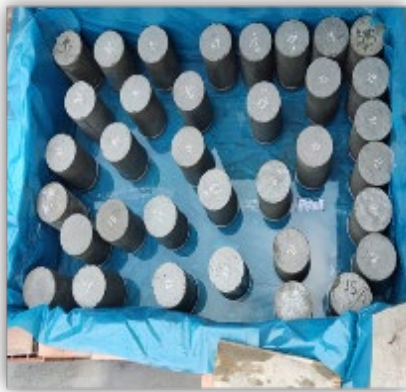
Desmolde de las probetas y vigas de flexión
