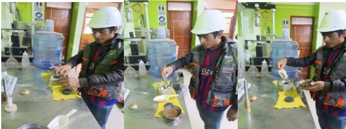
Figura 102. Se ensambla la caja de corte
