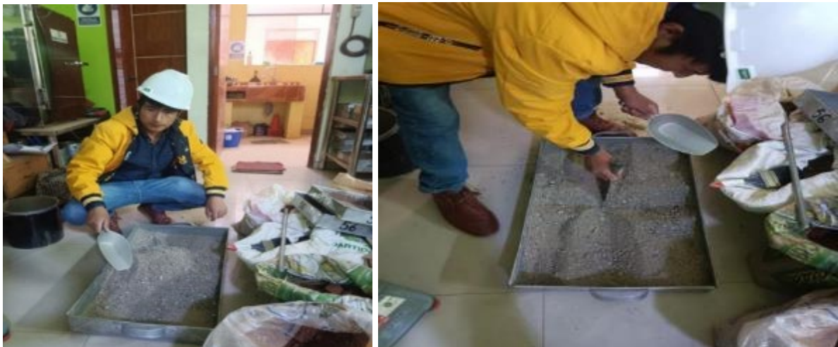
FIGURA 35. Cuarteo del Agregado Fino (arena gruesa).
