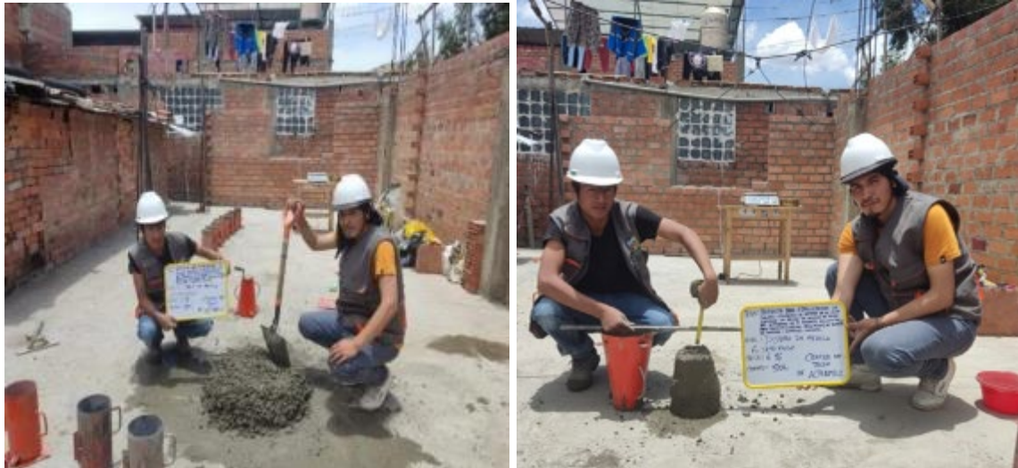
Figura 66. Proceso de mezclado de concreta adición de 6% tallo de altramuz y Prueba de revenimiento
