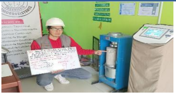
Rotura de compresión Axial de 14 días de 6.00%, 9.00%
