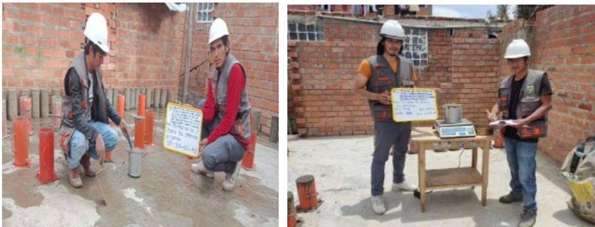
Figura 58.Temperatura la mezcla y Peso unitario de Concreto
