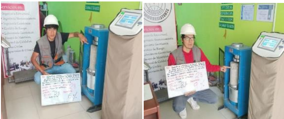
Figura 125. Rotura de resistencia de compresión de 28 días
