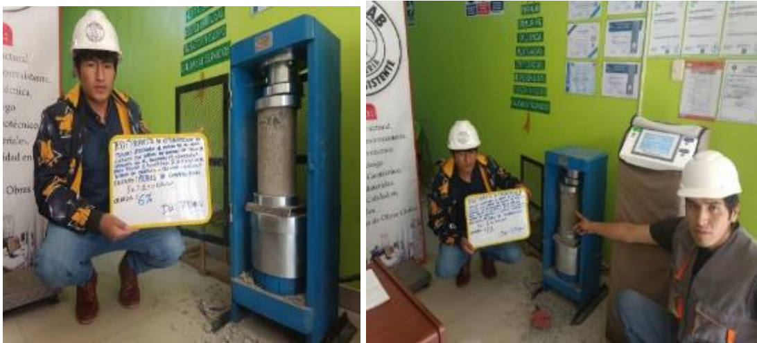
Figura 120. Probetas rotas en resistencia en compresión de 7 días
