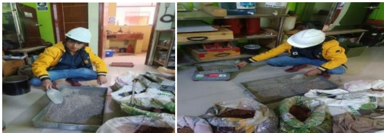
FIGURA 38. Muestreo del agregado grueso
