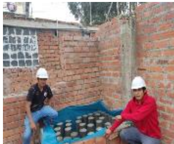
Curado de probetas y vigas de concreto
