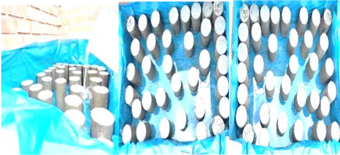
Figura 76. Curado de probetas de Compresión y Tracción para 7 días, 14 días, 28 días.
