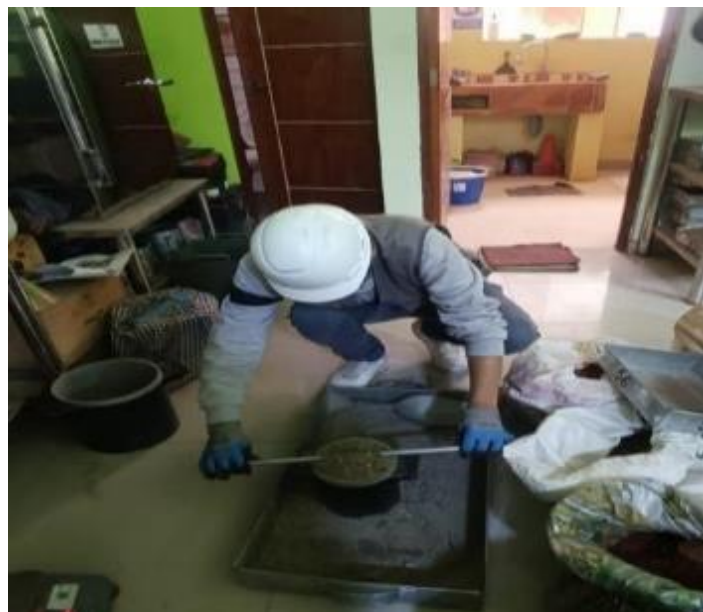
Figura 50 . Enrasado del agregado fino corregido
