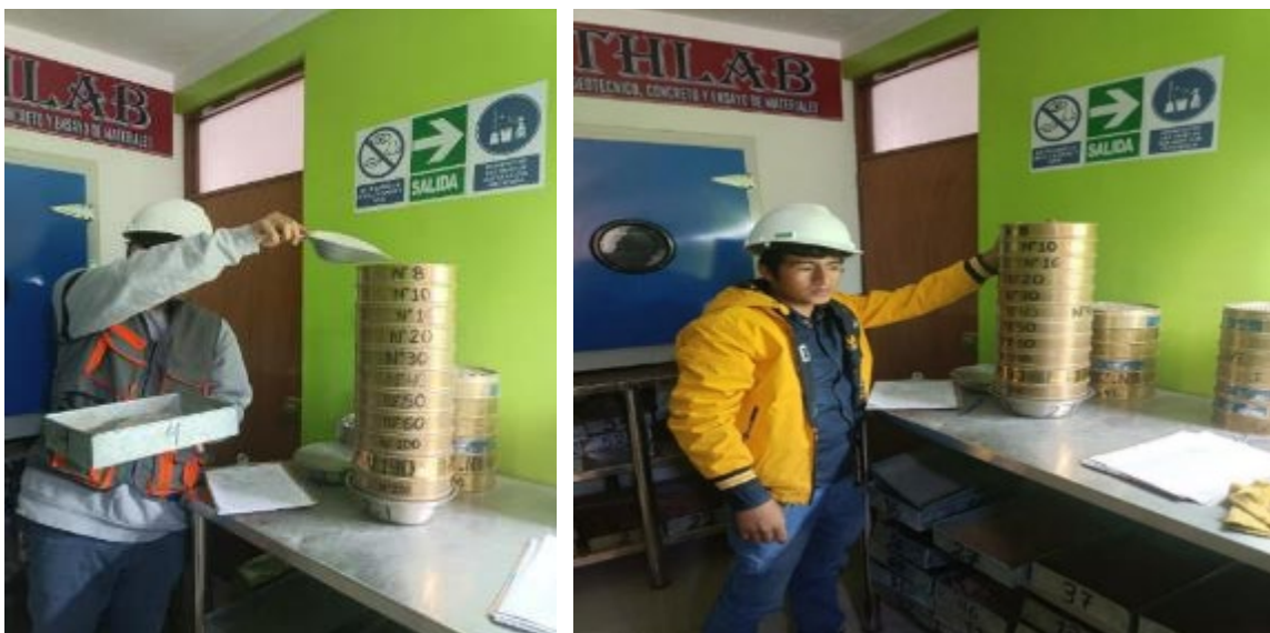
FIGURA 36. Columna de tamices de tamaños: 3/8", N° 4, N° 8, N° 16, N° 30, N° 50, N° 100 y N° 200.
