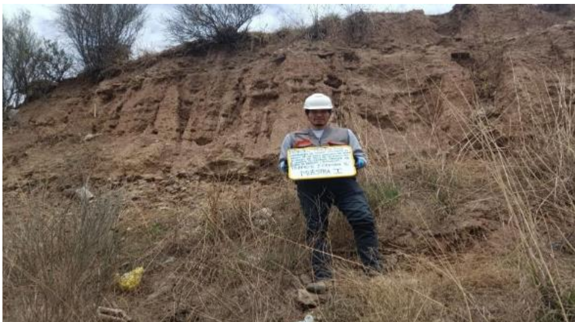
FIGURA 80. Extracción de muestra Uno de parte media del talud
