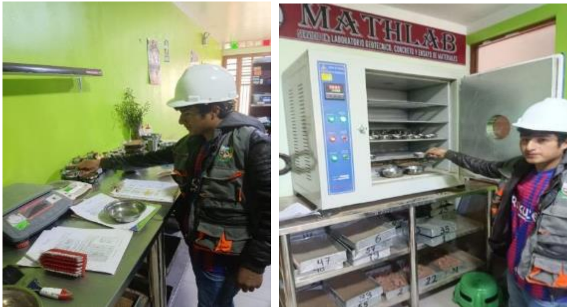
Figura 107. Pesado y colocación de muestra de corte directo
