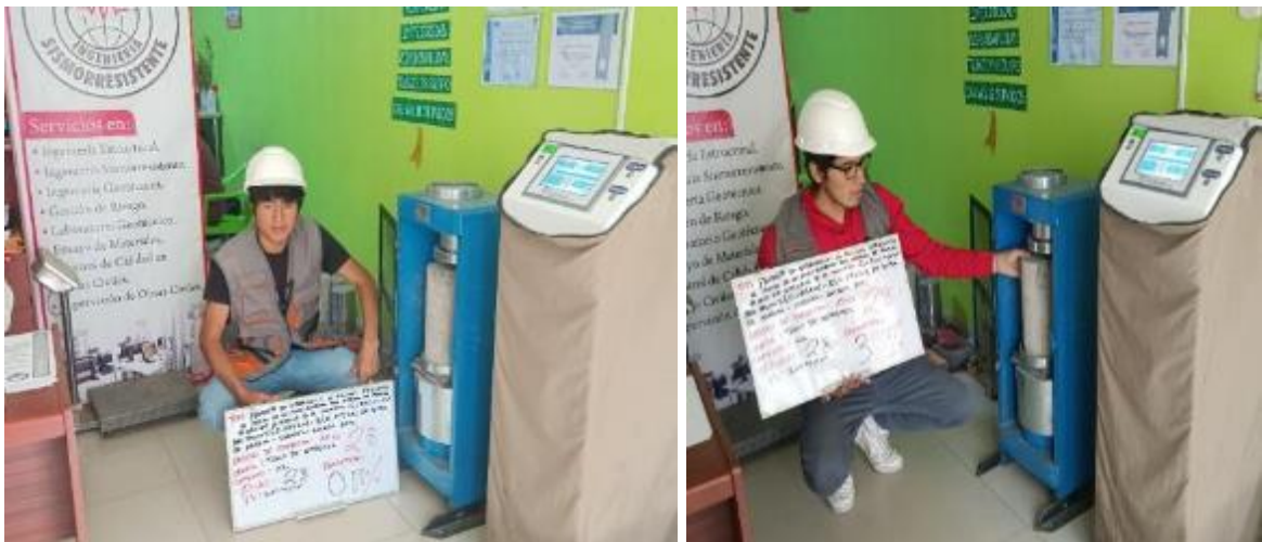
Figura 124. Rotura de resistencia de compresión de 28 días
