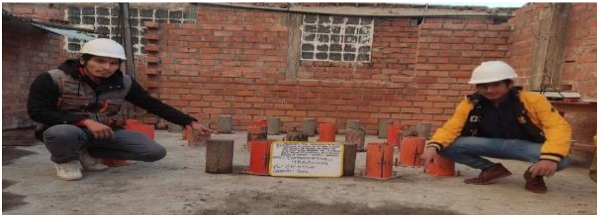
Figura 75. Desmolde de briquetas de 0 % 3% 6 % 9% para ensayo de tracción
