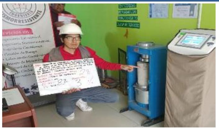
Rotura de compresión Axial de 14 días de 0.00%, 3.00%
