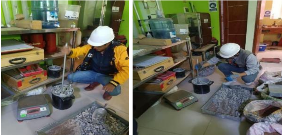
Figura 51. Llenado y apisonado del agregado grueso en Proctor
