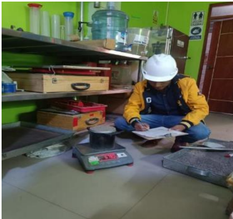
Figura 54.Pesado de tres muestras de arena gruesa
