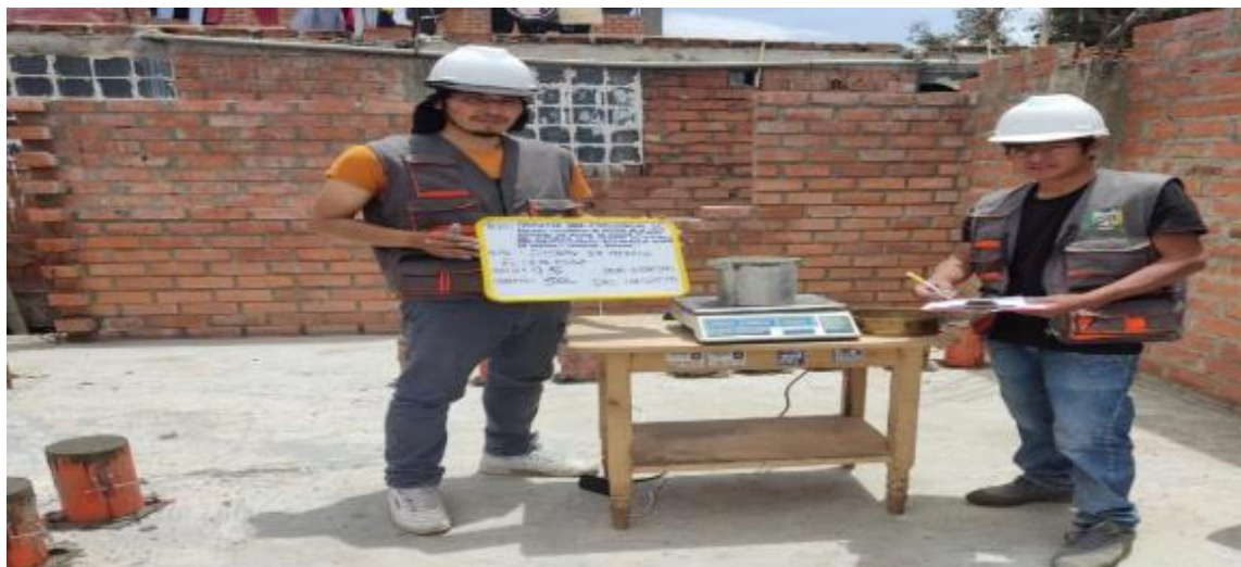
Figura 118. Olla de Washington con concreto fresco
