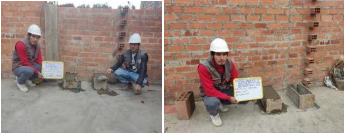
Figura 73. llenado de los moldes cilíndricos
