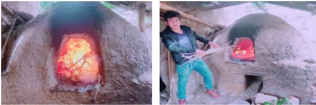
Figura 21 .Se procedió al quemado del tallo de altramuz mediante un horno artesanal.
