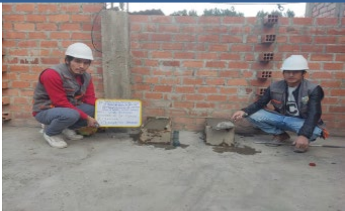
Vigas de Flexión de adición de CTA de 3%, 6% y 9% para 28 días de edad
