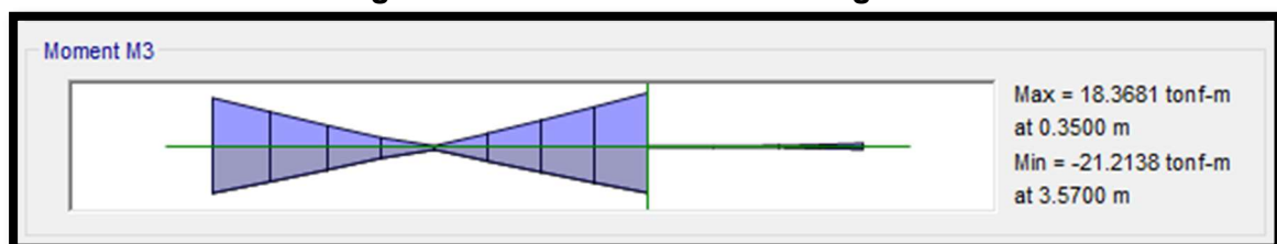
Figura N°24 Momento máximo negativo
