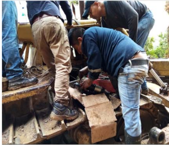
Figura 8. Lubricación del Tractor Oruga D7
