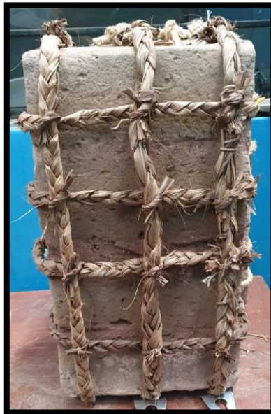
Pila con geomalla biaxial de hoja de palmera de 5 cm
