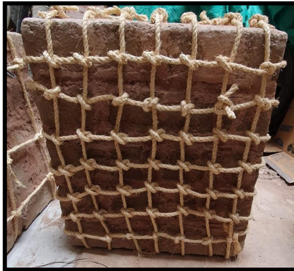
Murete con geomalla biaxial de fibra de cabuya cocada 5cm x 5cm
