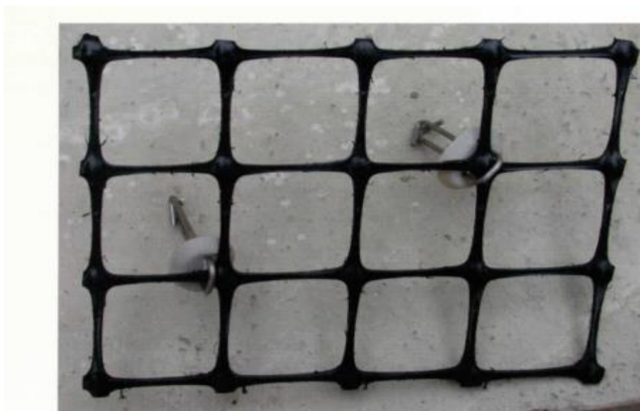
Figura 6. Geomalla biaxial de nudos rígidos.
