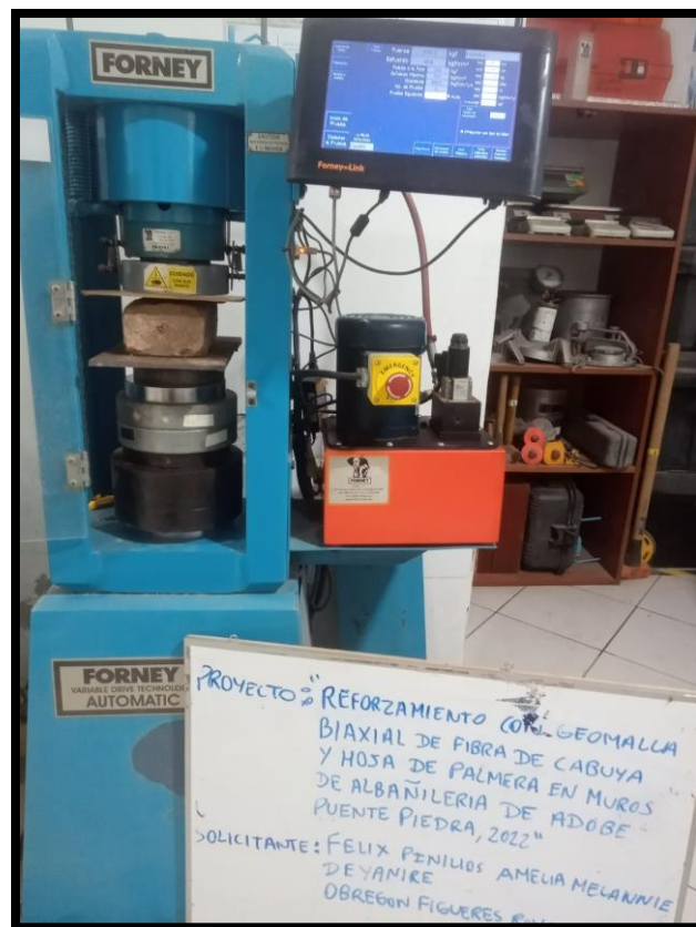
Figura 16. Ensayo compresión en cubos de adobe
