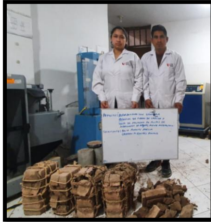
Figura 19. Ensayo de compresión axial – pilas patrón
