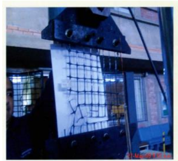
Figura 7. Geomalla biaxial de nudos rígidos
