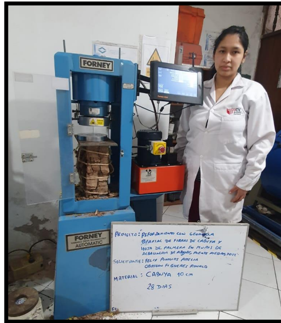
Ensayo compresión axial de pila con geomalla biaxial de fibra de cabuya cocada 5cm x 5cm
