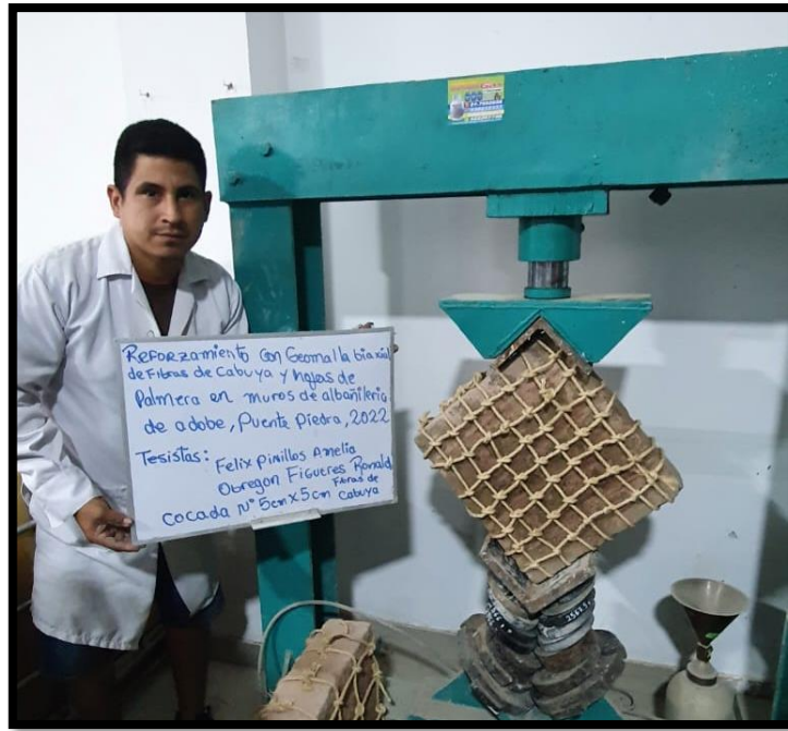
Ensayo corte diagonal Murete con geomalla biaxial de fibra de cabuya cocada 5cm x 5cm
