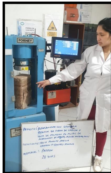
Ensayo compresión diagonal de pila patrón
