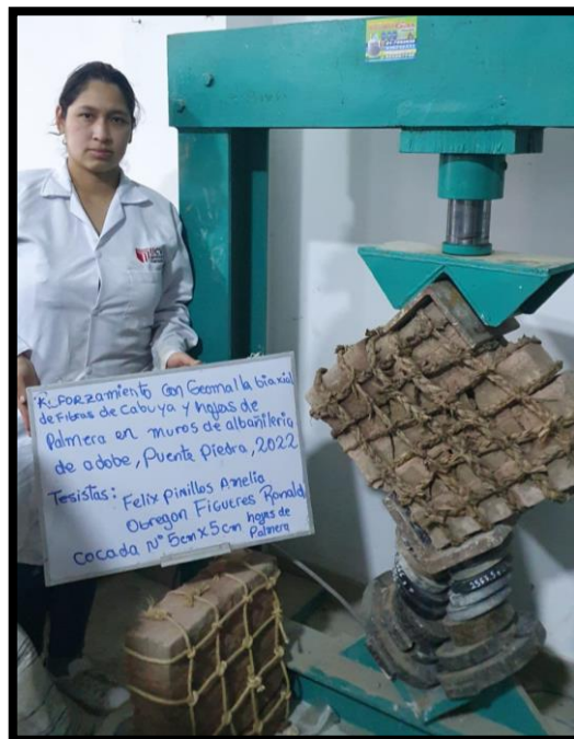
Ensayo corte diagonal Murete con geomalla biaxial de hoja de palmera cocada 5cm x 5cm
