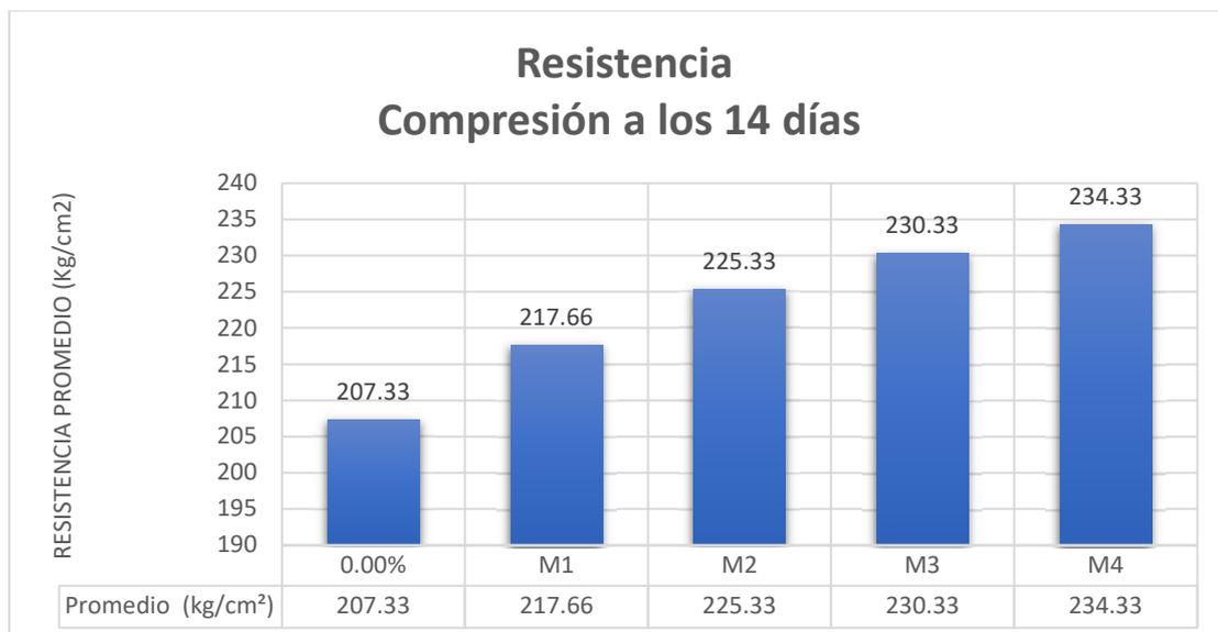
Figura 29. R´C a 14 días de la muestra patrón y M1, M2, M3 y M4
