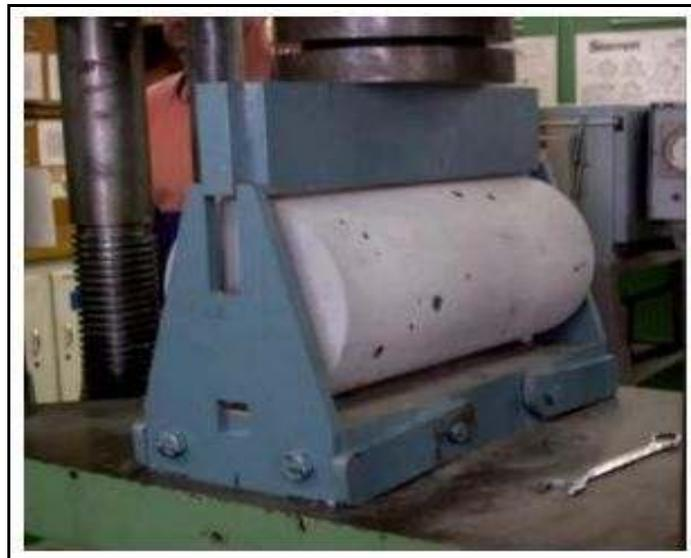
Figura 11. Ensayo tracción
