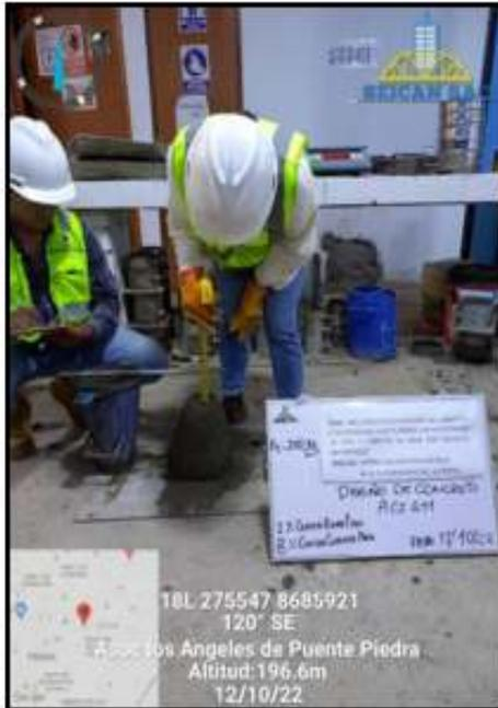
Temperatura del concreto -NTP
