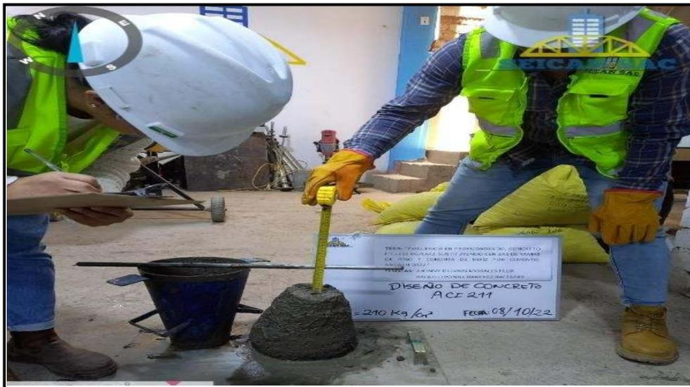
Figura 21. Asentamiento del concreto diseño convencional
