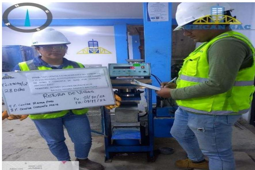
Figura 37: Resistencia a flexión
