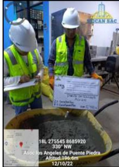
Probetas cilíndricas 6"x 12"-NTP 339.033/ASTM
