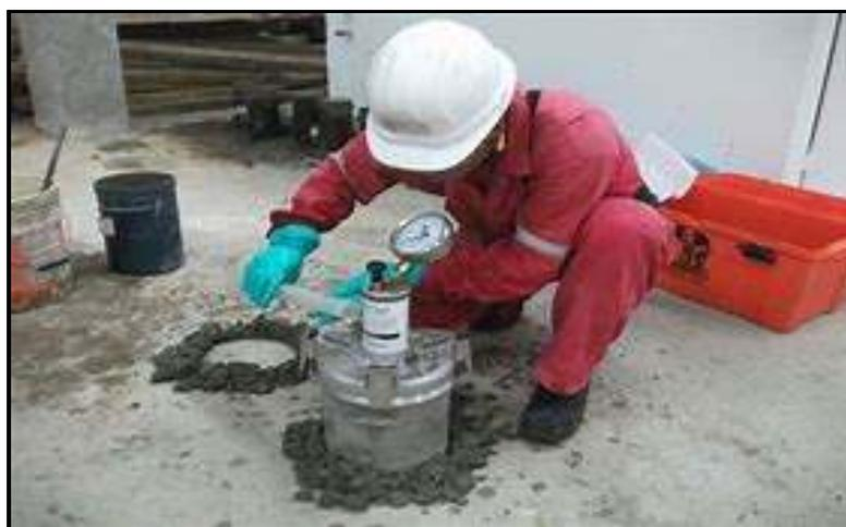
Figura 1. Contenido de Aire del Concreto
