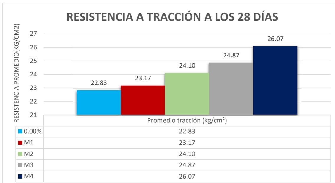
Figura 35: R´T a 28 días de la muestra patrón y M1, M2, M3 y M4
