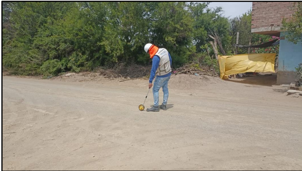
Anexo 8.2.9. Tesista Cesar Vela Alvarado midiendo la longitud total del tramo Huancaquito Alto-LI1153-Viru con un odómetro digital
