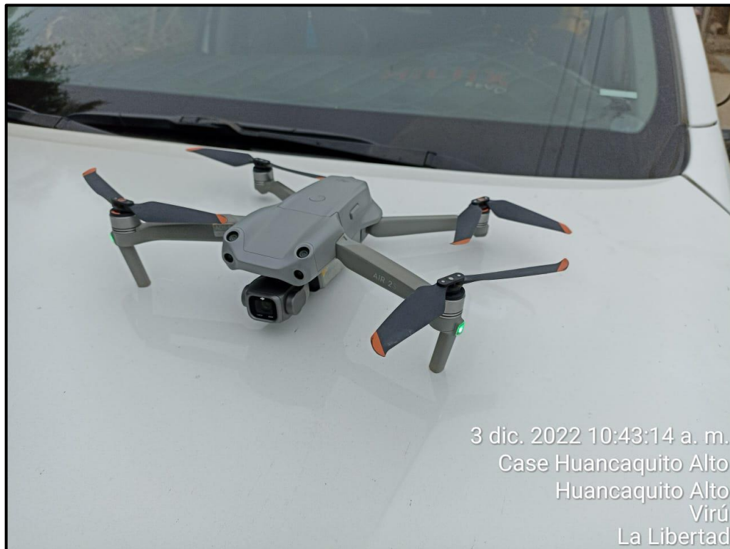
Anexo 8.2.13. Levantamiento por fotogrametría por medio de Dron DJI mini 2.
