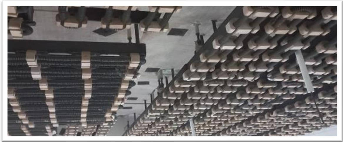
Porta resistencias y resistencias (bobinas de alambre nicromo)
