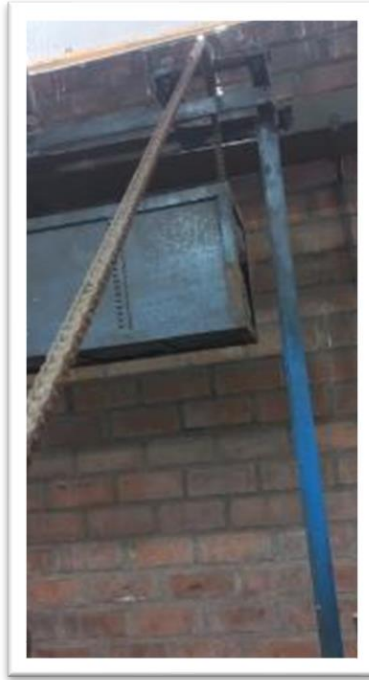
Diferentes sistemas de izajes de las tapas de los hornos
