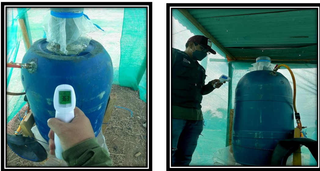
Figura N°13: Medición de temperatura del biodigestor
