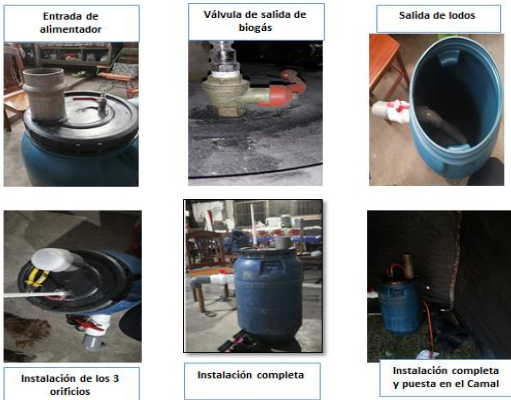
Figura N°8: Construcción del biodigestor tipo batch
