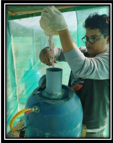
Figura N°9: Llenado del interior del biodigestor con la mezcla: estiércol, vísceras y sangre.
