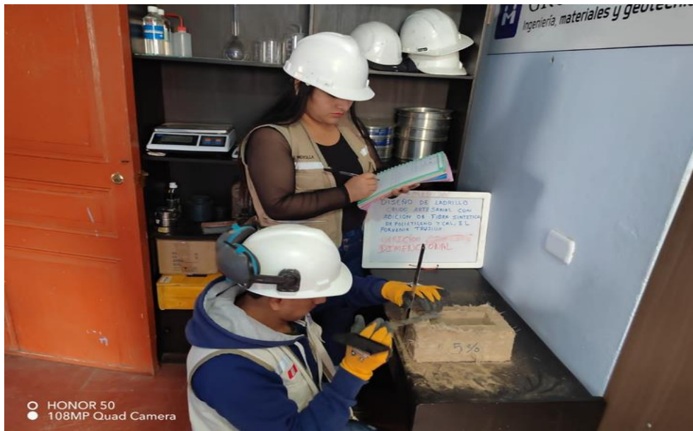
figura 38. Medimos la altura de la muestra para obtener resultado promedio de la variación dimensional
