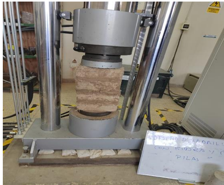
figura 61. Ensayo de resistencia a compresión de pilas mejor porcentaje
