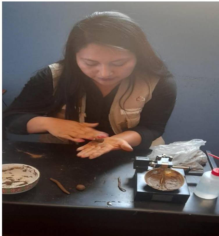
figura 27. Comprobación de presencia de arcilla.
