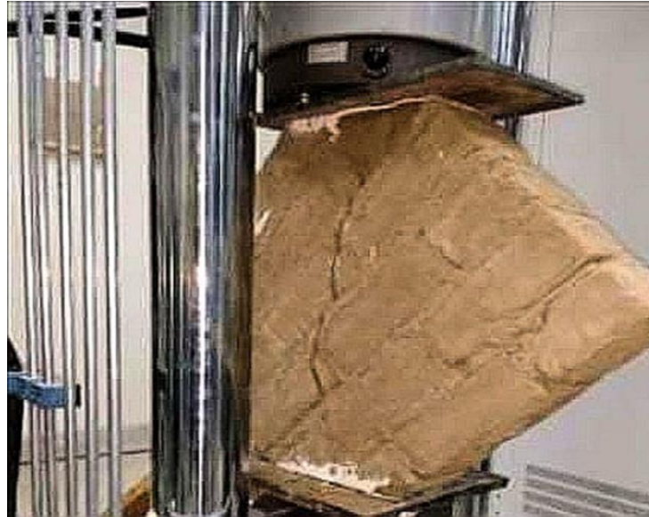
figura 59. muestras de las fisuras de la muestra ensayada
