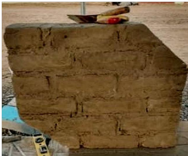
figura 56. Recortado de las esquinas del murete para facilitar el ensayo.
