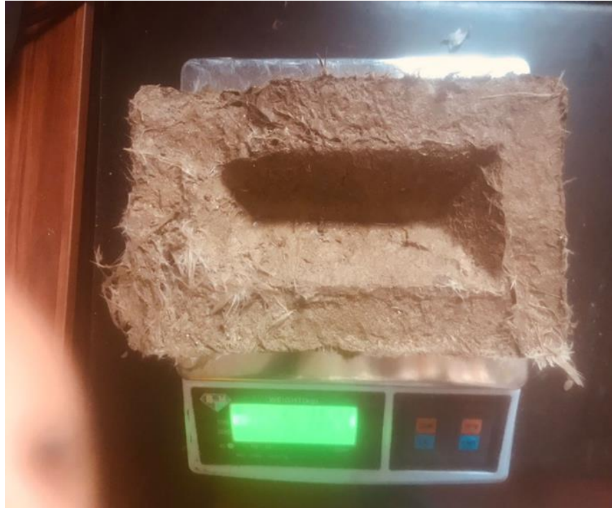
figura 48. Pesamos la muestra para obtener el peso saturado y obtener el porcentaje de absorción.
