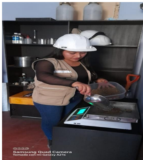
figura 20. Peso de la muestra seca del horno, para realizar el tamizado.
