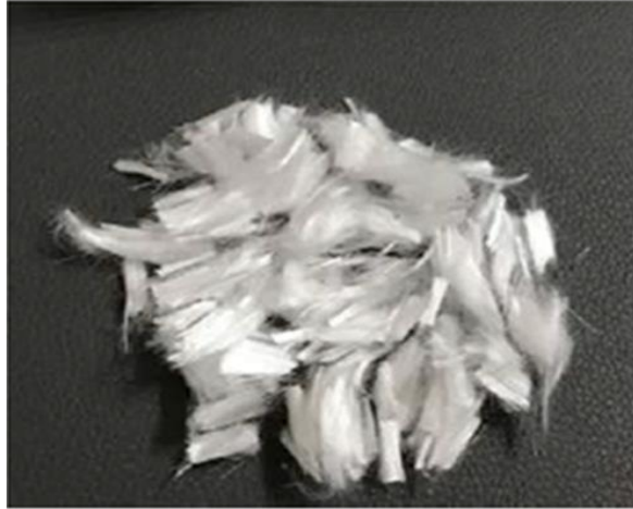
figura 1. Fibra sintética de polietileno.
