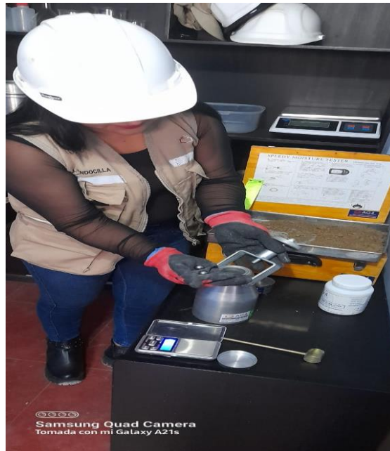
figura 24. Incorporación de las esferas para el ensayo de contenido de humedad en el SPPEYD.
