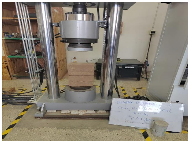
figura 60. Ensayo a compresión axial en pilas
