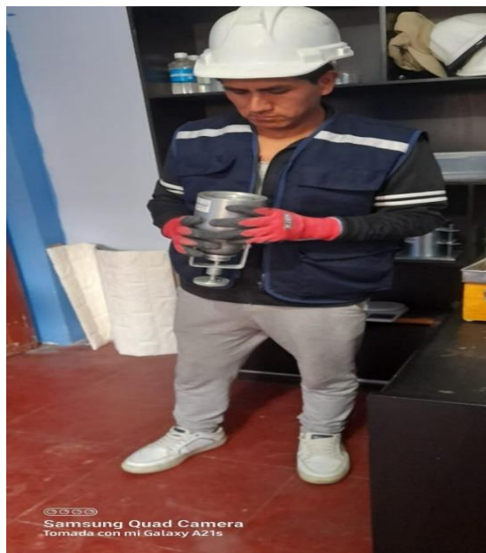
figura 25. Se añade 1 cucharada de carburo y bolas de esferas al Speedy más la muestra para poder determinar el contenido de humedad.
