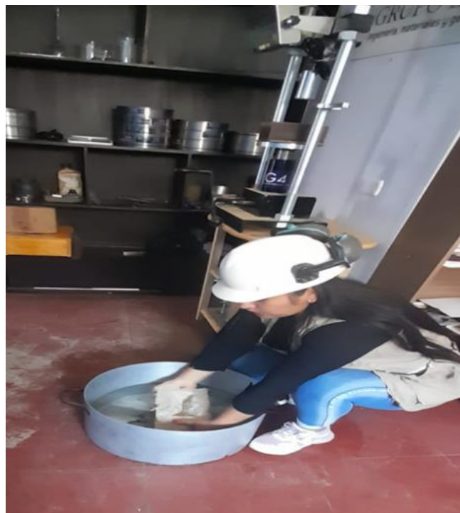
figura 47. Ingreso de la muestra al agua
