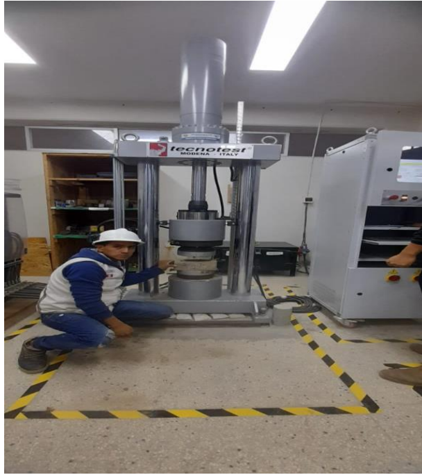
figura 42. Ensayo de las muestras modificadas a resistencia compresión unidades
