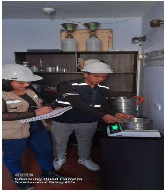
figura 22. fotografías de ensayo de contenido de humedad.
