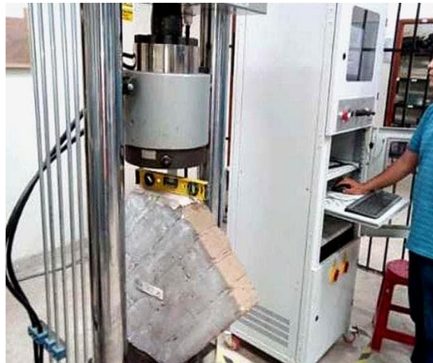
figura 58. Ensayo de murete a resistencia a compresión diagonal.
