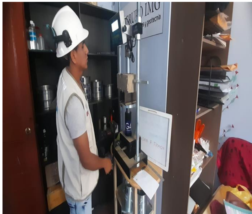
figura 49. Sometiendo cargas a la muestra a ensayo de resistencia a la flexión.
