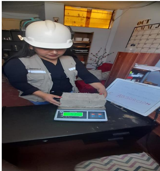
figura 46. peso de la muestra en seco antes de ser sumergida al agua
