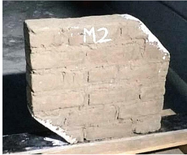
figura 57. Refrenamos con yeso para nivelar las caras del murete
