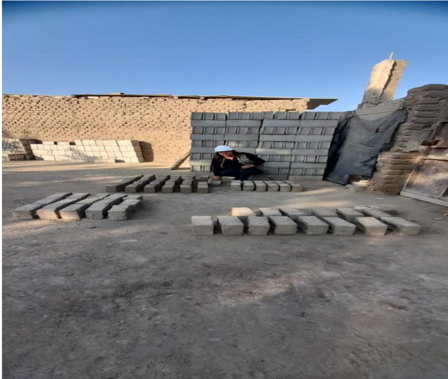
figura 36. Proceso de Secado de las muestras, para realizar los ensayos pasando los 20 días.
