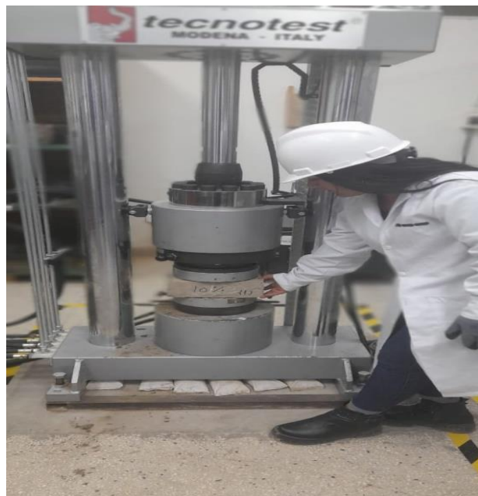
figura 43. retirado de la muestra después de ser ensaya a Resistencia a la compresión.
