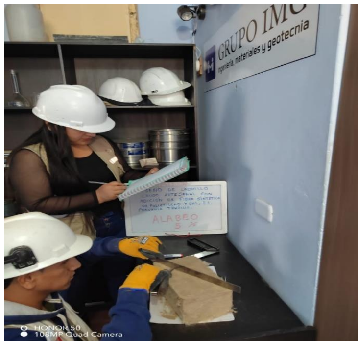
figura 39. medimos la cara inferior de la muestra para obtener los resultados de alabeo.
