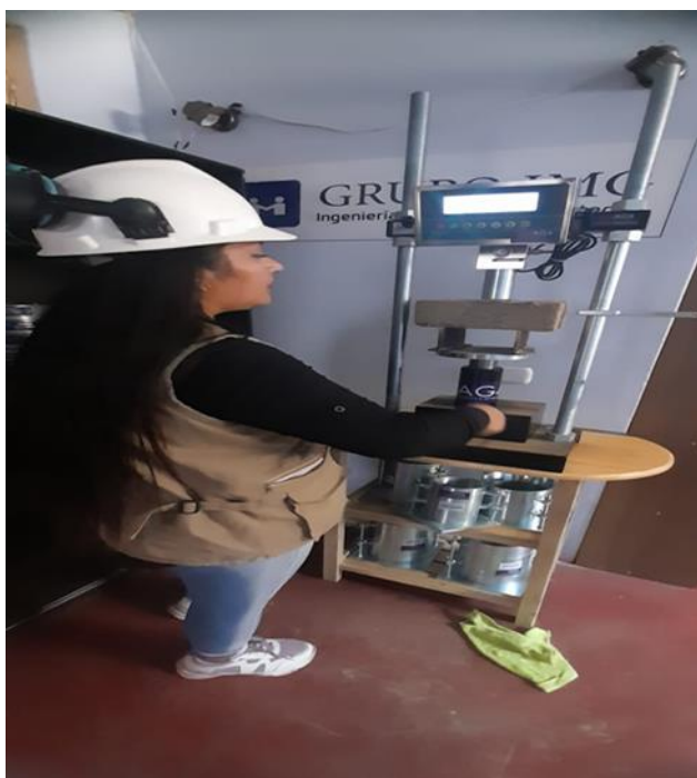
figura 50. Realizando el ensayo de flexión a la muestra
