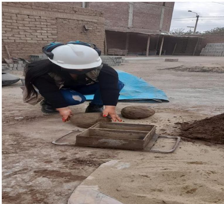
figura 33. Elaboración de los ladrillos crudos patrón y modificados con dimensiones de ladrillo fue de 24x12x9cm.
