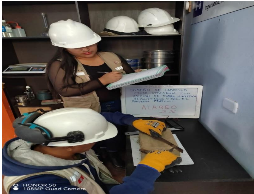
figura 40. se toma las medidas de las caras de la muestra para determinar si el ensayo de Alabeo es de tipo convexa o cóncava.
