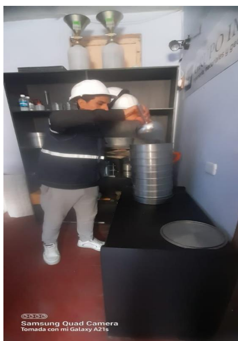
figura 21. Incorporación del material a los tamices, para agitarlo y obtener los porcentajes retenidos.
