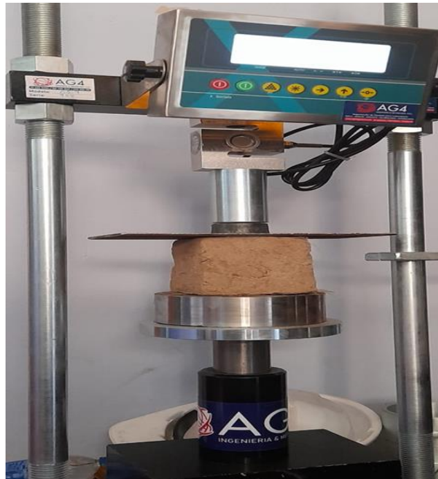
figura 44. Ensayo de resistencia a la compresión en cubos
