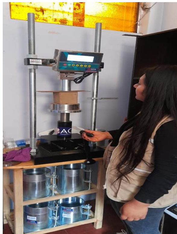
figura 45. Aplicando cargas a la muestra cubos.
