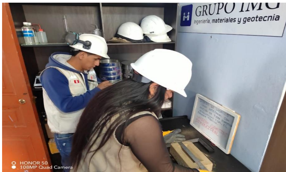
figura 37. Midiendo el largo de la muestra para obtener promedio de variación dimensional.
