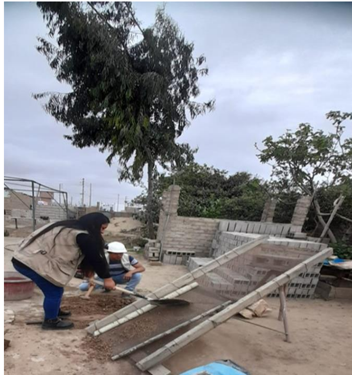
figura 28. preparación tierra para la muestra.
