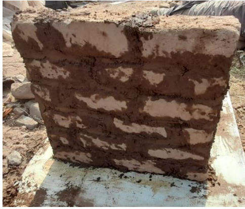
figura 54. Murete listo para el secado
