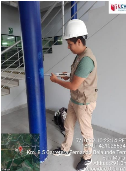
ANEXO N°14: Prueba de Esclerometría.
