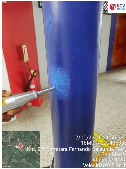
ANEXO N°15: Prueba de Esclerometría.
