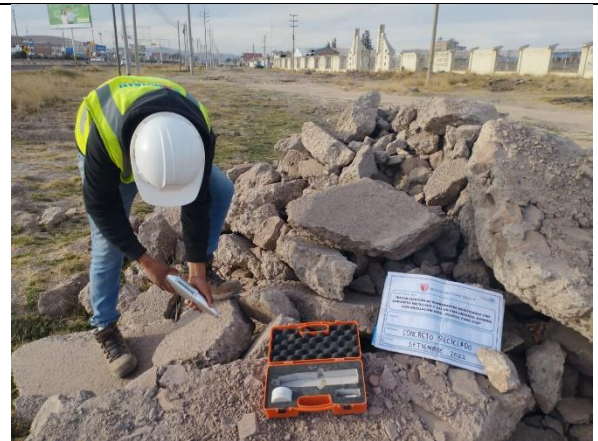
Fotografía 6. Medición de resistencia con el esclerómetro.
