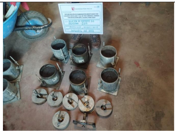
Fotografía 10. Equipos para el ensayo de CBR.
