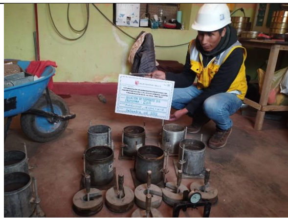
Fotografía 9. Equipos para el ensayo de CBR.
