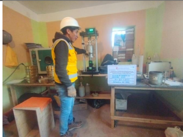
Fotografía 11. Aplicación de cargas en la prensa CBR.
