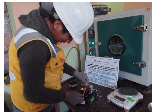
Fotografía 15. Ensayo de límite líquido con la cuchara de Casagrande.
