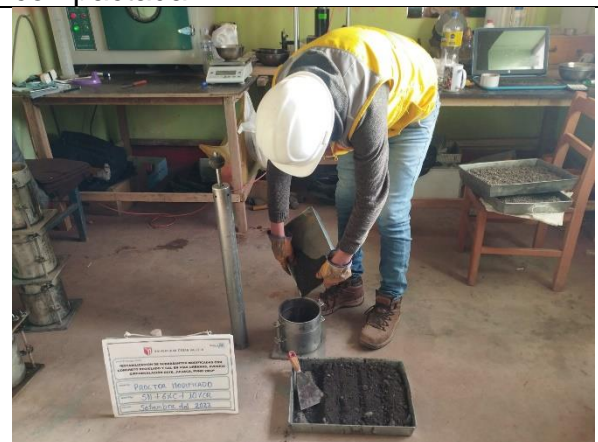
Fotografía 22. Ensayo de Proctor modificado.
