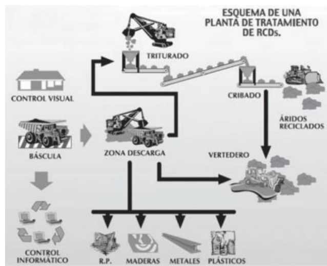
Figura 3. Esquema de una planta de tratamiento de RCDs
