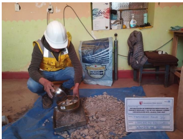
Figura 8. Tamizado del concreto reciclado
