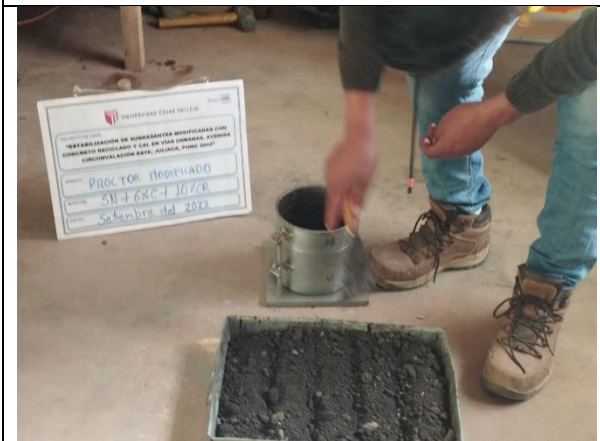
Fotografía 23. Ensayo de Proctor modificado.
