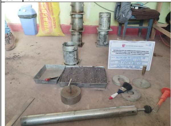
Fotografía 21. Ensayo de Proctor modificado.
