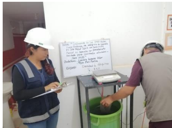
Foto 26: Peso sumergido de adoquín
