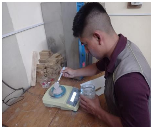
Foto 08: Pesado de material para el ensayo de finura del polvo de porcelanato
