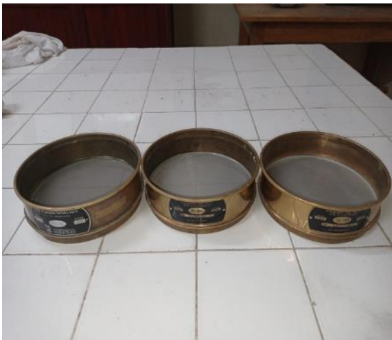
Foto 07: Mallas utilizadas para ensayo de finura
