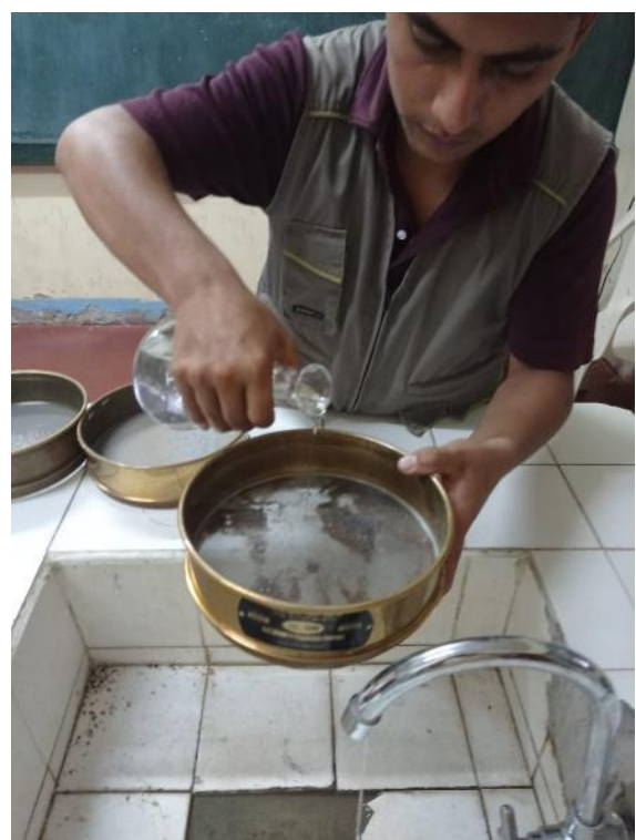
Foto 12: Lavado de porcelanato con agua destilada
