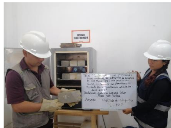
Foto 27: Secado de adoquines en horno
