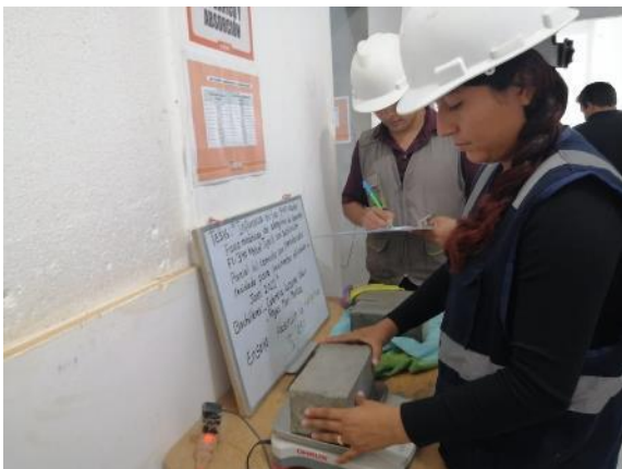
Foto 25: Peso saturado de adoquín, absorción
