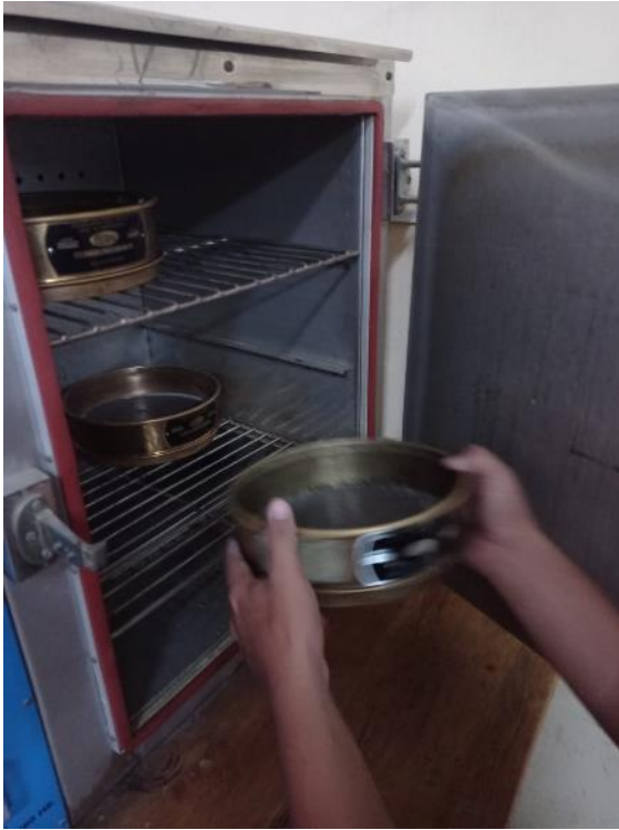
Foto 13: Secado en estufa de mallas con porcelanato
