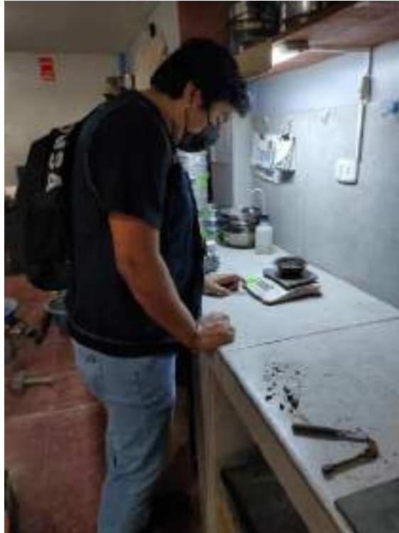
Figura 82. Se verifica el peso de la muestra para la determinación del contenido de humedad
