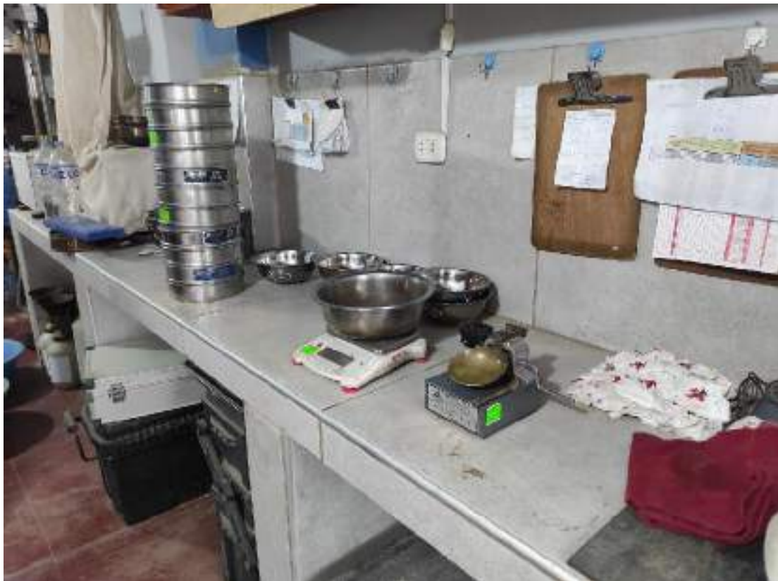
Figura 81. Se realiza el pesado de la muestra para su determinación del contenido de humedad
