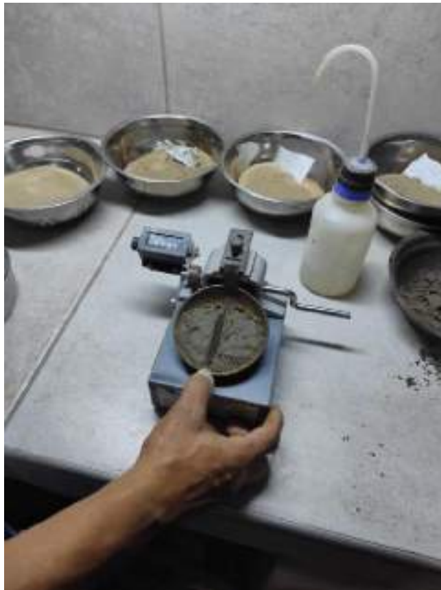
Figura 87. Se observa la muestra que ha sido sometida a ensayo para determinación de límites de consistencia
