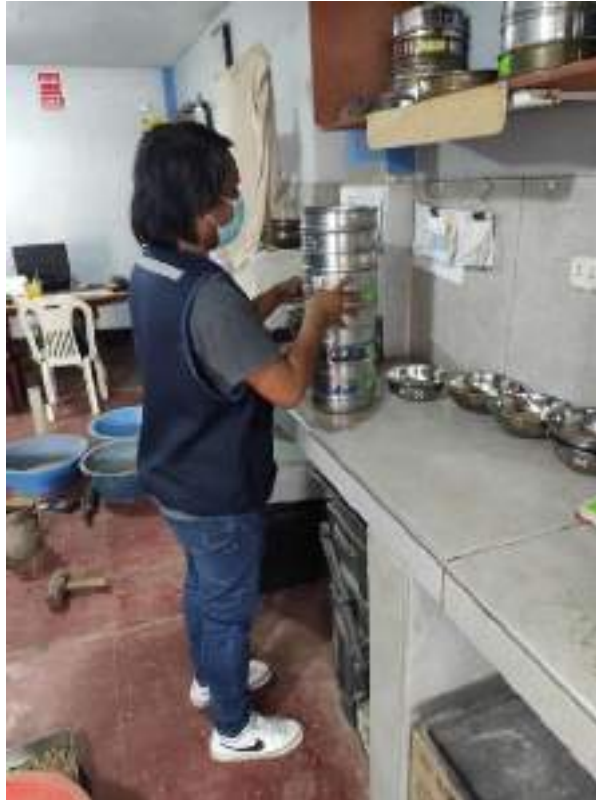
Figura 80. Se realiza el tamizado para determinar la granulometría de la muestra
