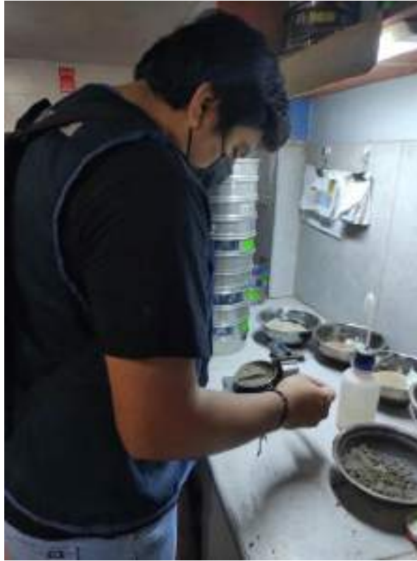
Figura 86. Se realiza el ensayo para determinación de límites de consistencia.
