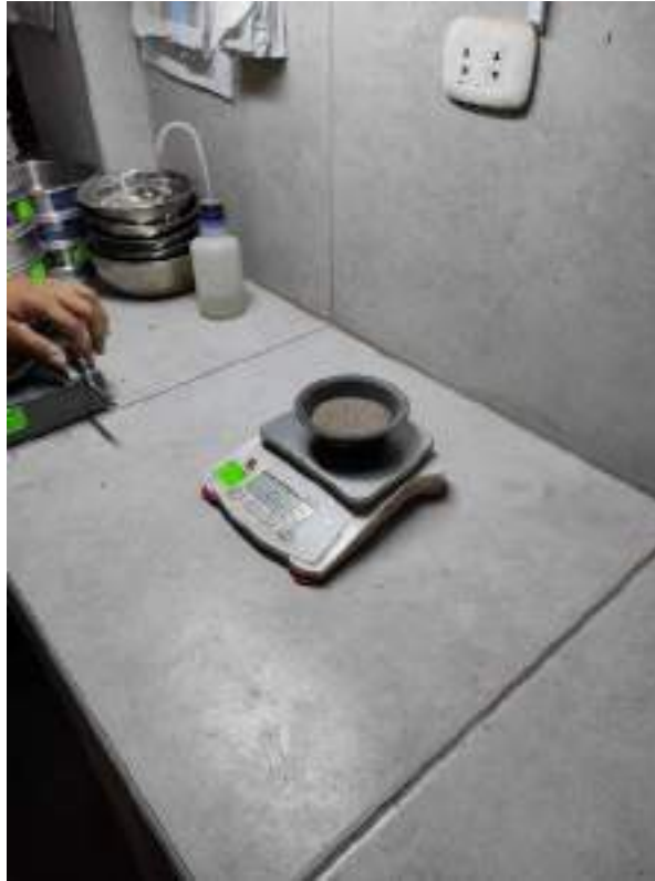
Figura 84. Se realiza el peso seco de la muestra para la determinación del contenido de humedad
