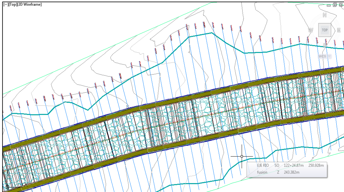
Figura 51. Corredor creado para la descolmatación del río con sus respectivas secciones.
