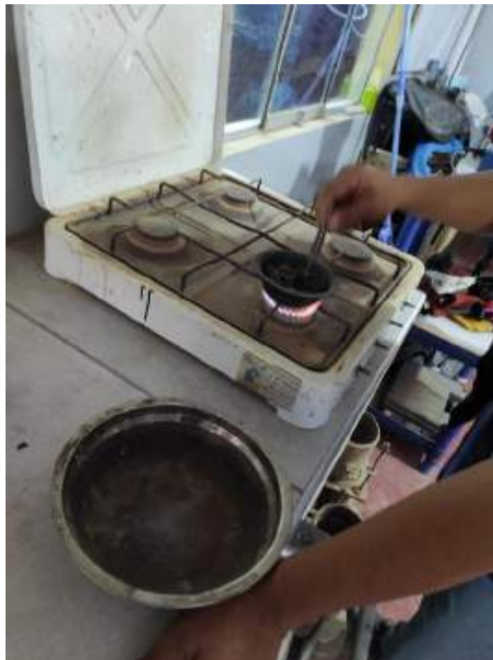
Figura 83. Se pone la muestra al horno para quitarle el contenido de humedad
