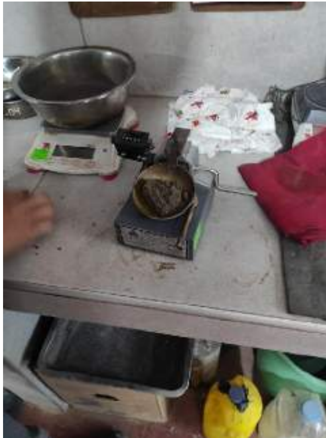
Figura 85. Se observa la muestra que será sometida a ensayo para determinación de límites de consistencia.
