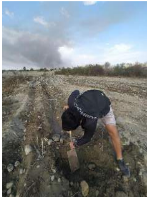
Figura 79. Se continúan realizando los trabajos para la excavación de calicatas
