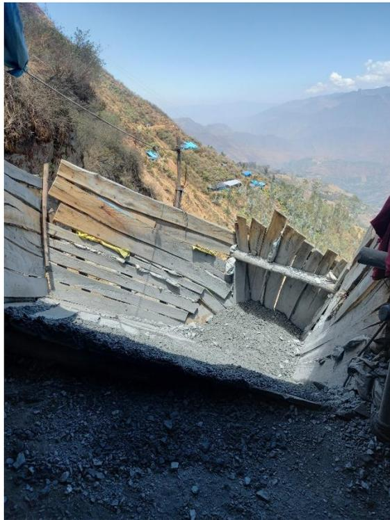
Fotografía 12: Desmontera para material de descarte.
