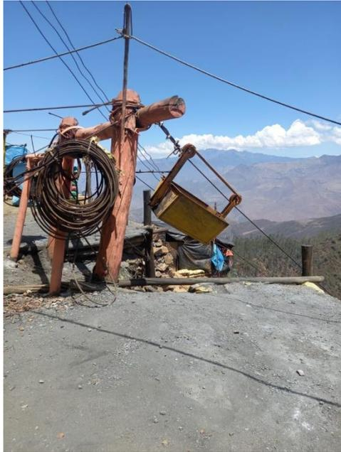
Fotografía 13: Winche para transporte del mineral hacia la zona de carga.
