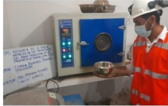
Figura 7. Secado de muestra 110°C. Fuente: Propia.
