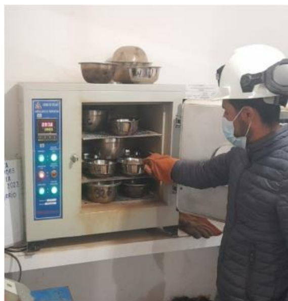
Figura 5. Secado de muestra 110°C. Fuente: Propia.
