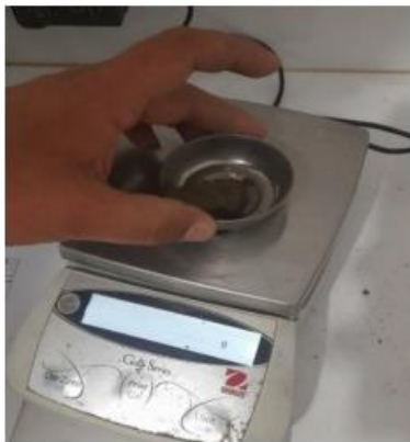
Figura 17. Toma de muestra 40 gr. Fuente: Propia.
