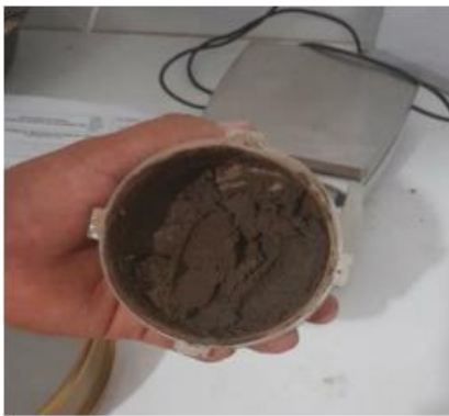
Figura 12. Homogenización de la mezcla. Fuente: Propia.
