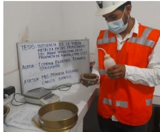
Ensayo límites de consistencia
