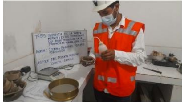
Figura 11. Adición de agua con pipeta. Fuente: Propia.
