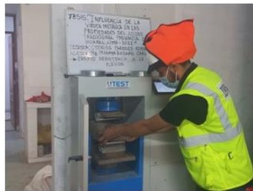
Figura 31. Resistencia a la flexión. Fuente: Propia.
