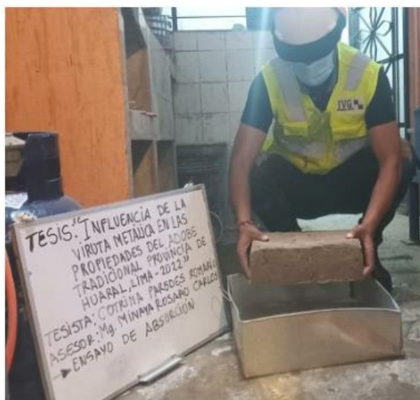
Figura 34. Muestra sumergida al agua. Fuente: Propia.
