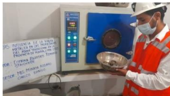
Figura 20. proceso de secado a 110°C. Fuente: Propia.
