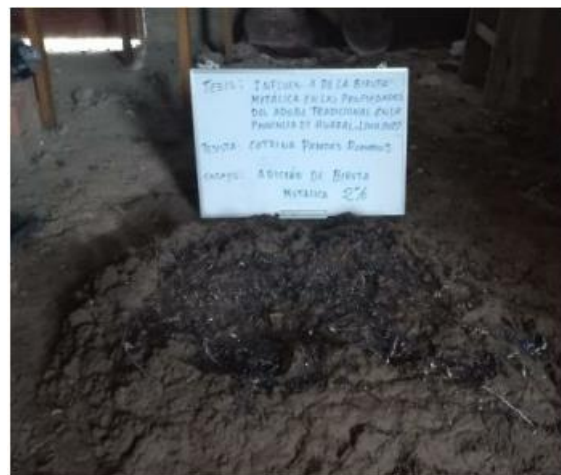
Figura 26. Adición de 2% de viruta. Fuente: Propia.
