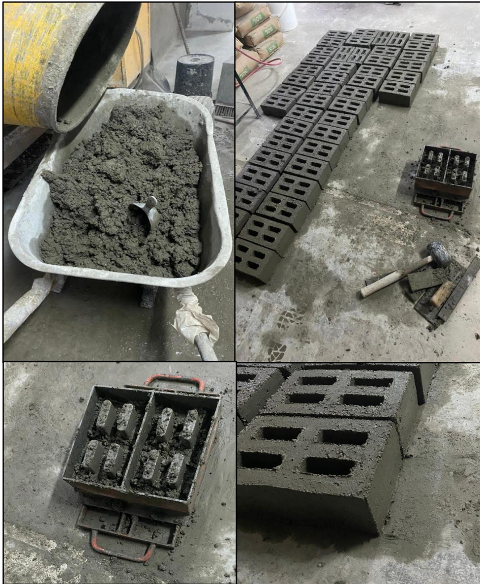
Figura 23. Ladrillos elaborados, plantillados y seleccionados de muestras.
