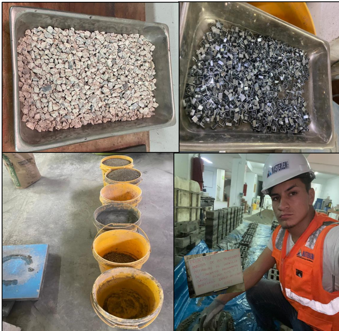
Figura 22. Clavos blywo tipo u, agregado grueso reciclado, cemento, arena y agua.
