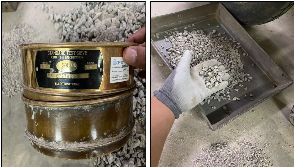
Figura 12. Procedimiento en las etapas de tamizaje 3/8" y 4".
