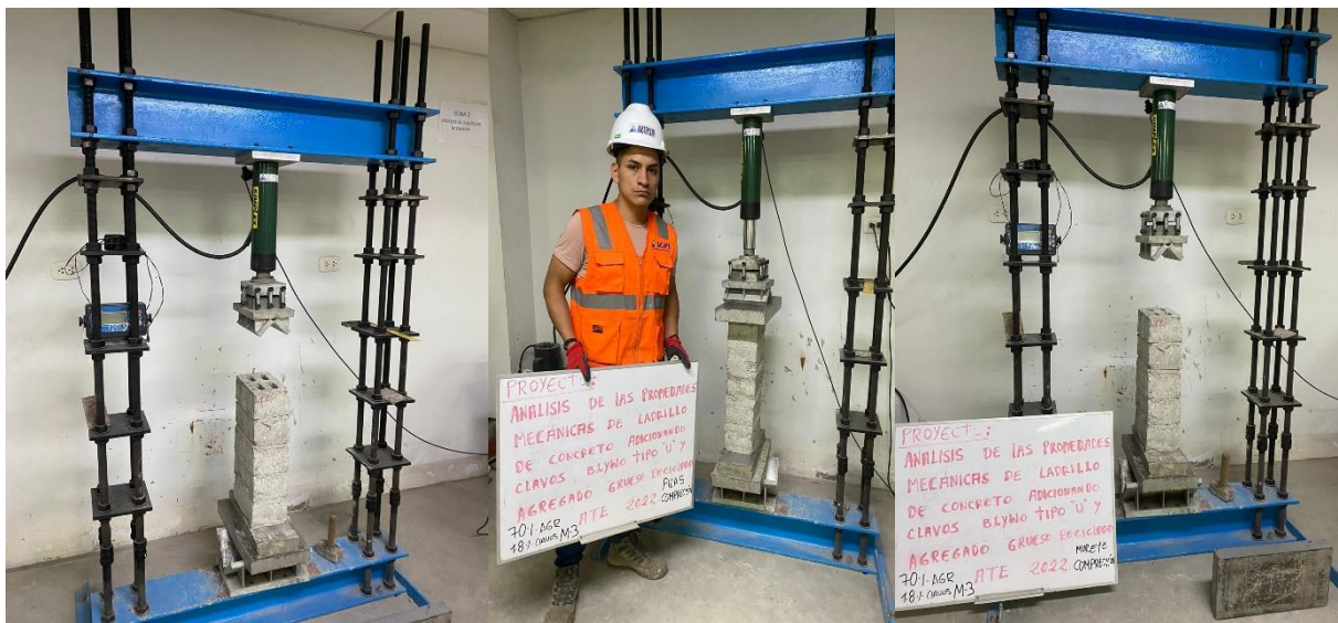
Figura 34. Compresión en pilas de 5 unidades de ladrillo de concreto.
