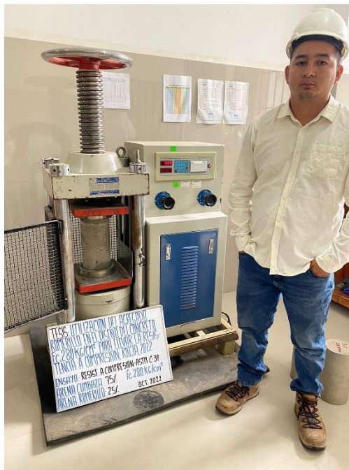
Foto 14: Rotura de probetas a los 7 días, 25% de AR.
