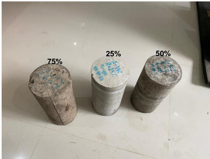
Foto 13: Probetas con adición de AG en 25%, 50% y 75%.
