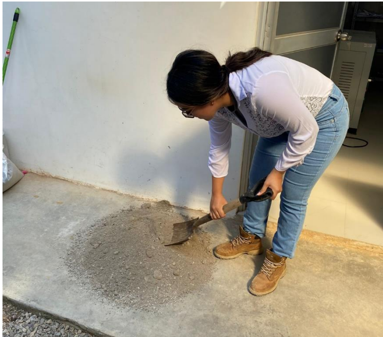
Foto 04: Mezclado del agregado romerillo para ensayo de análisis granulométrico.
