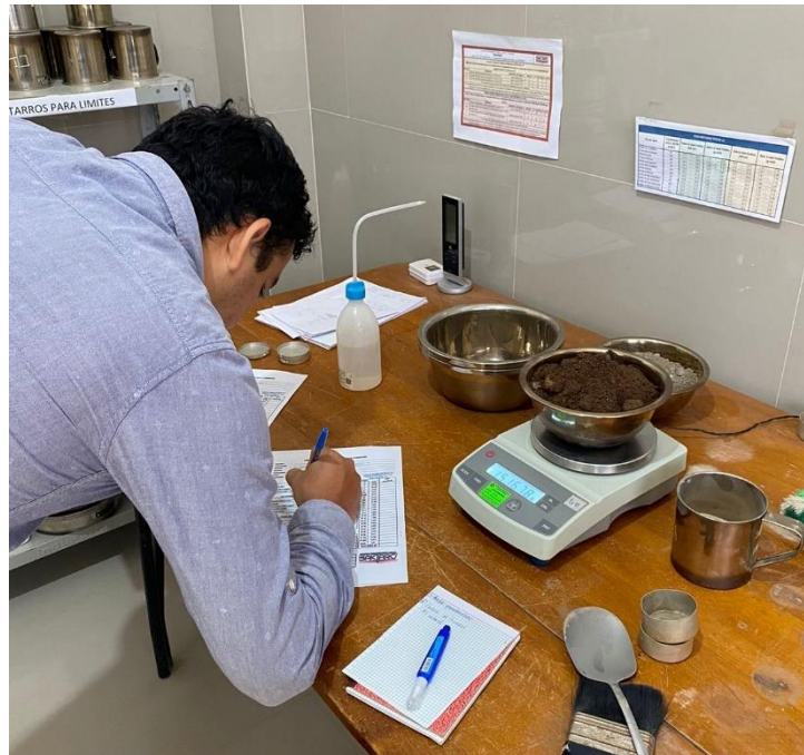
Foto 02: Ensayo de contenido de humedad.
