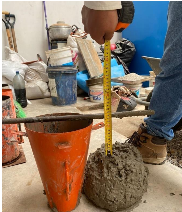
Foto 10: Ensayo del cono de Abrams.
