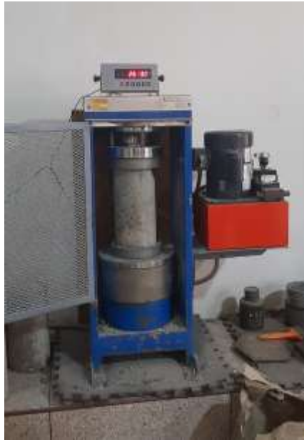
Figura 35: Probetas dentro de la prensa hidráulica NTP 399.611. Fuente. Elaboración propia.
