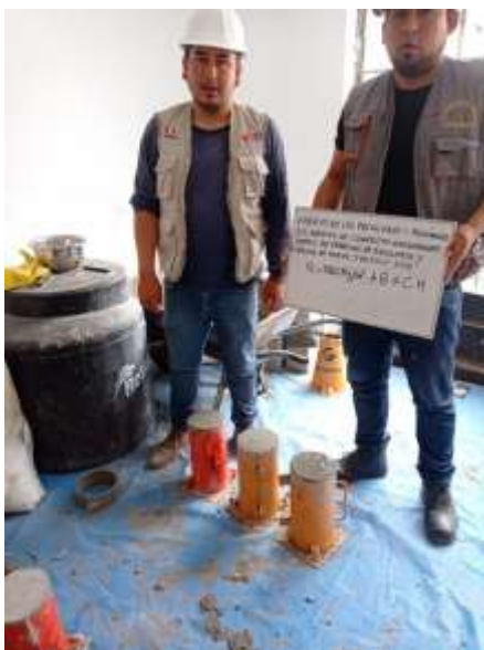
Figura 28: Llenado de probetas de control para ensayo de resistencia a la compresión.
