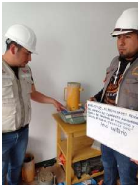
Figura 12: Pesado de recipiente con material granular para el análisis de peso unitario.
