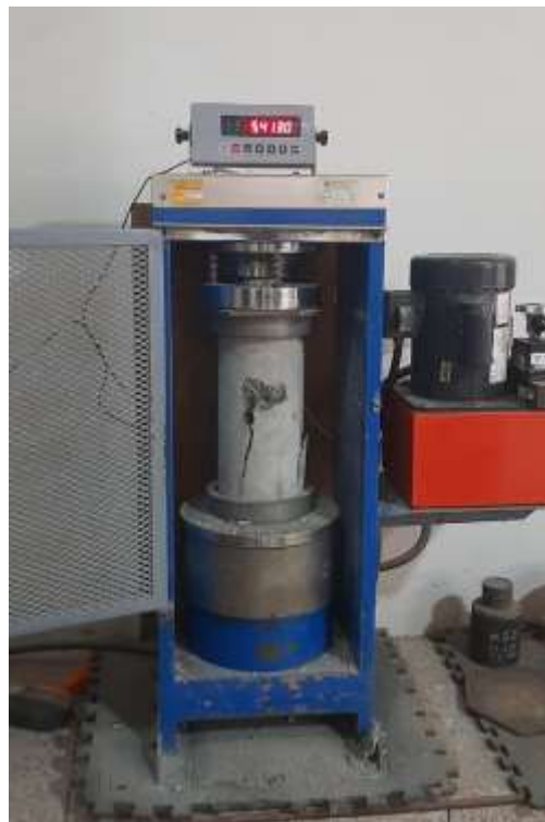
Figura 34: Probetas dentro de la prensa hidráulica NTP 399.611.
