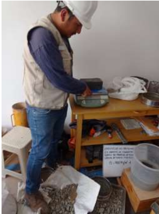
Figura 31: Adoquín hidratado con agua, siendo pesado el ensayo de absorción.
