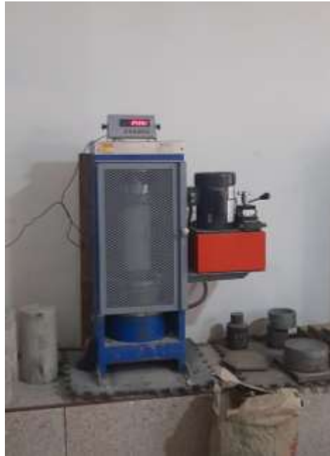
Figura 33: Probetas dentro de la prensa hidráulica NTP 399.611.
