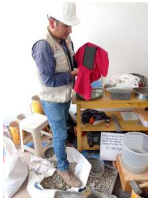
Figura 30: Adoquín hidratado con agua, para determinar el ensayo de absorción
