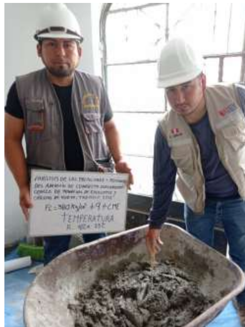
Figura 20: Control de temperatura en la mezcla de concreto entre 18° C a 25° C.
