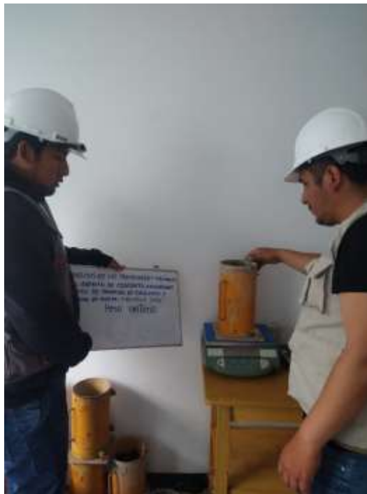
Figura 10: Peso de probeta circular para el análisis de peso unitario. Fuente. Elaboración propia.
