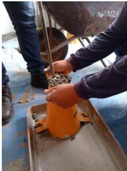
Figura 22: Ensayo de Slump con su llenado en capas y 25 golpes. Fuente. Elaboración propia.
