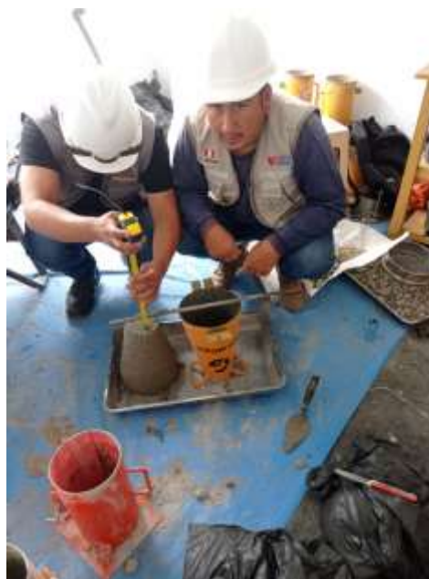
Figura 24: Ensayo de Slump con el enrazado del concreto.
