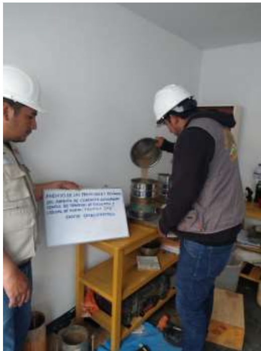
Figura 14: Ensayo granulométrico, proceso de tamizado de material granular.
