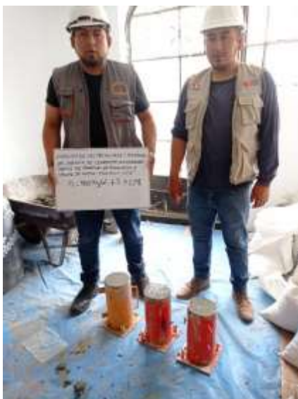
Figura 27: Llenado de probetas de control para ensayo de resistencia a la compresión.
