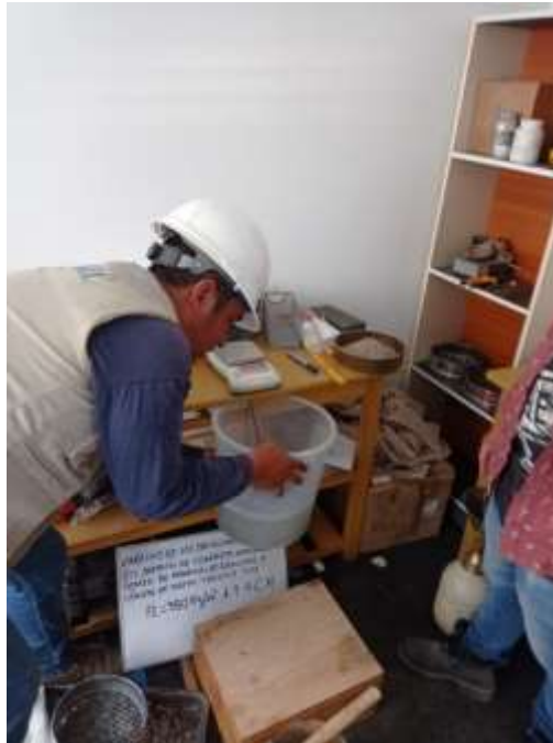
Figura 29: Pesado de adoquín sumergido en agua, para determinar el ensayo de absorción
