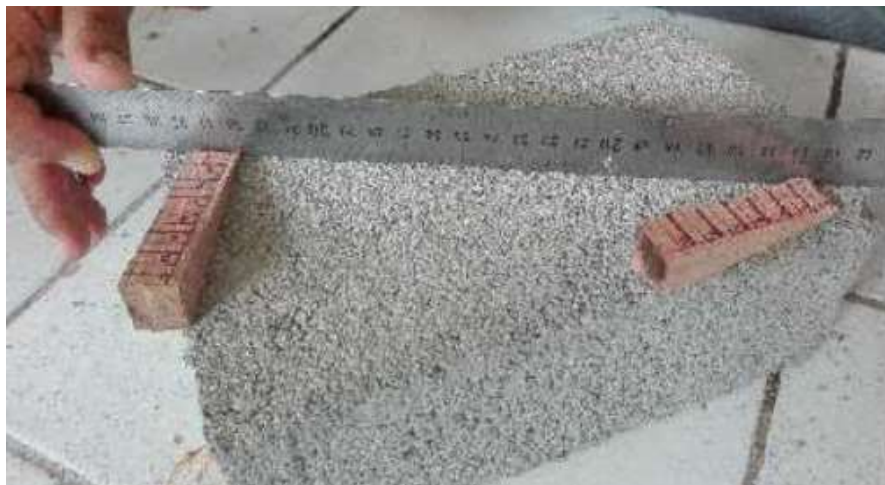
Figura 40: Ensayo de alabeo en adoquines. Fuente. Elaboración propia.
