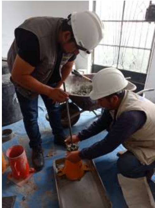
Figura 23: Ensayo de Slump con realizando los 25 golpes.
