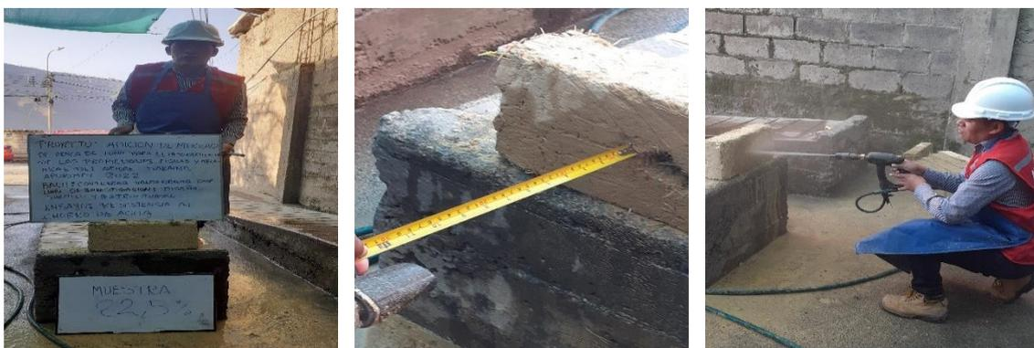
*Figura 12.* Ensayo de durabilidad del adobe al chorro de agua.
