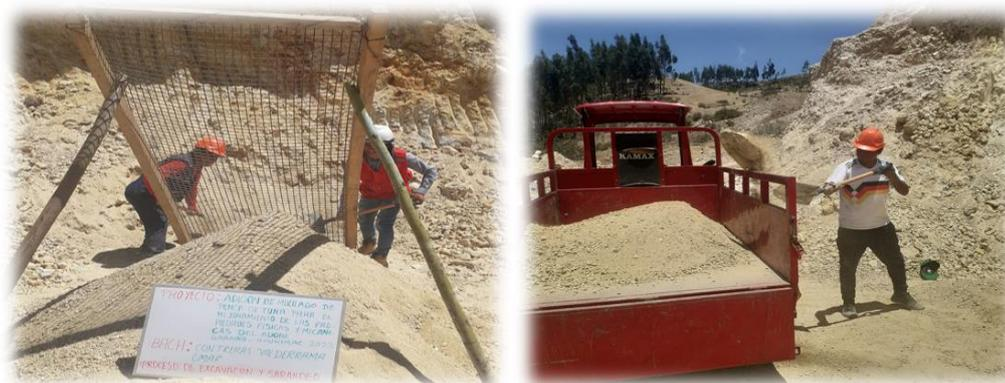
*Ilustración 12. Zarandeo y recopilación de material del suelo.*
