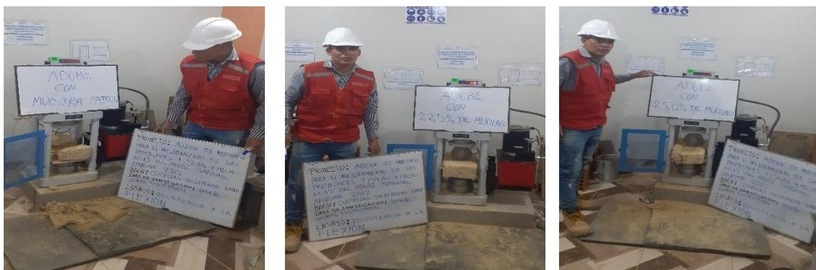
*Figura 16. Ensayo de resistencia a la flexión.*
