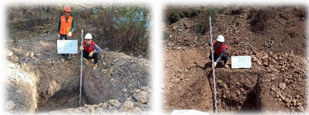
*Ilustración 4. Excavación calicatas sector Pantipata y Niño Mocco.*
