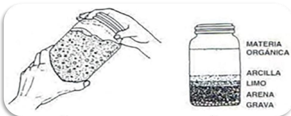
*Figura 4. Ensayo de la botella*
