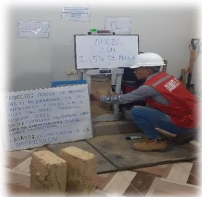
*Ilustración 16. Ensayo de laboratorio (compresión).*
