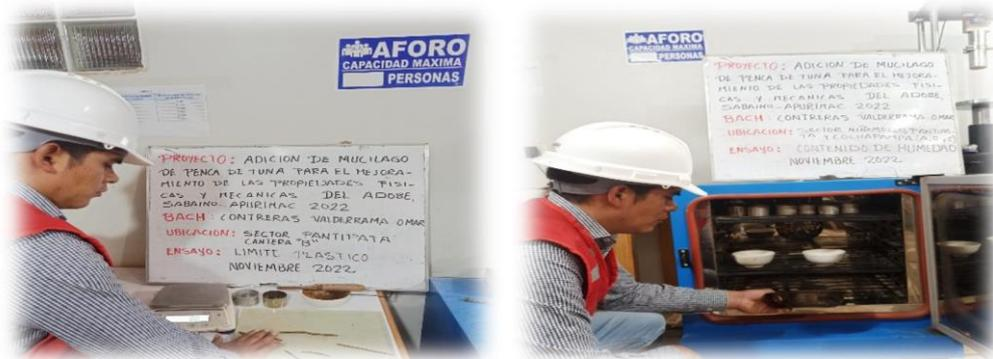
*Ilustración 9. Ensayos de límites de consistencia y humedad del suelo.*
