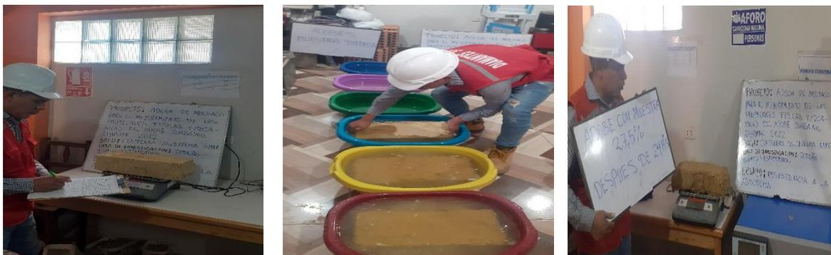
Figura 10. Ensayo de capacidad de absorción del agua.
