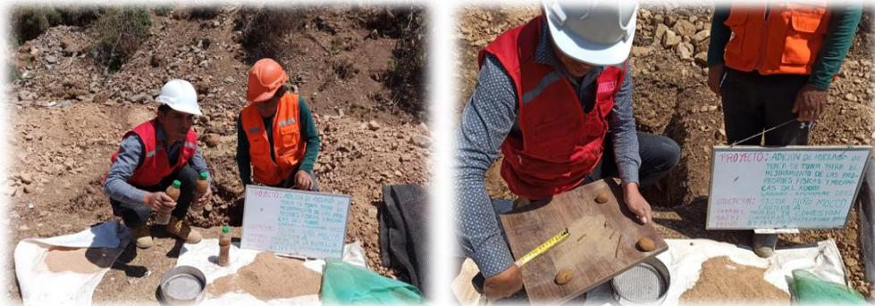
Ilustración 6. Prueba de la botella y cohesión del suelo.
