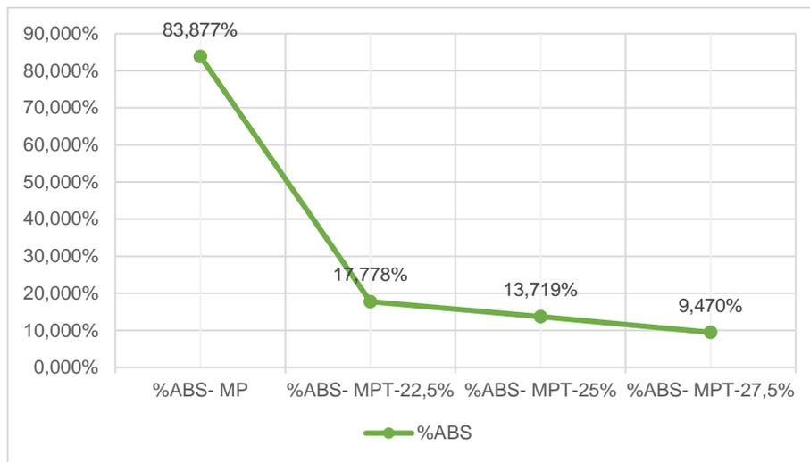
*Figura 11.* Gráfico del ensayo de capacidad de absorción del agua.
