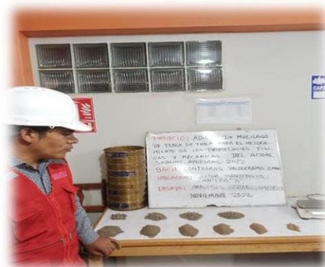
Ilustración 8. Ensayos de granulometría por tamizado del suelo.
