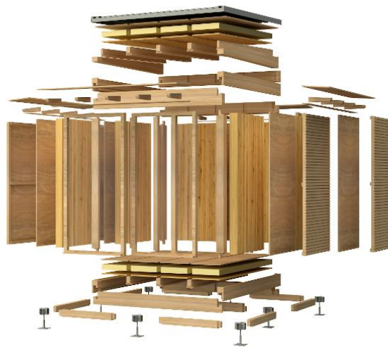
Sistema de construcción modular en madera
