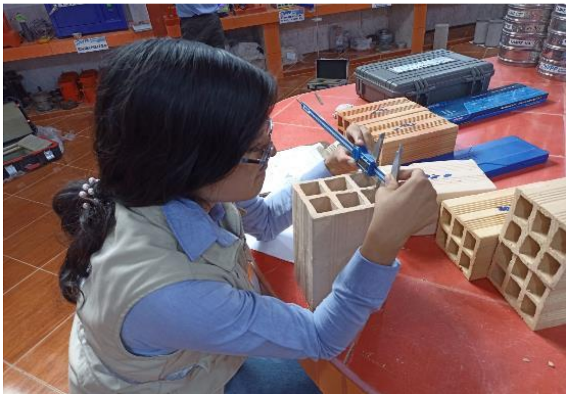
Foto N° 21: Medimos la dimensión de los ladrillos para ensayo de variabliada dimensional.
