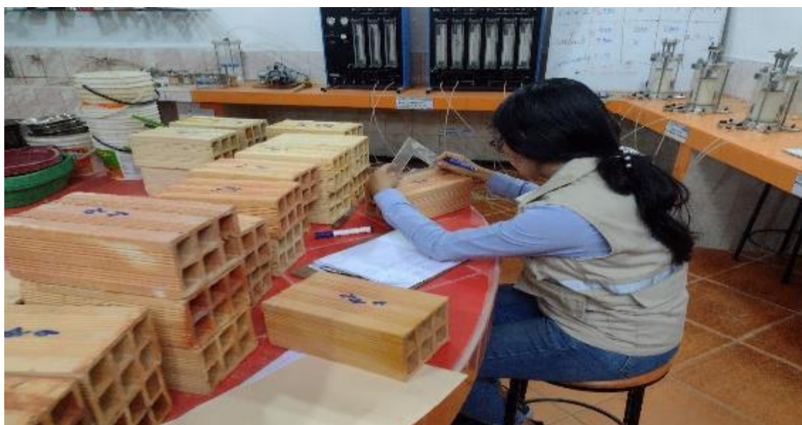
Foto N° 16: Medimos con una regla para el ensayo de alabeo a cada ladrillo a los 28 días.
