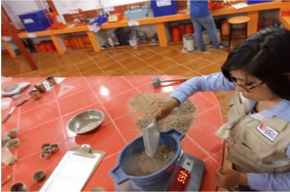
Foto N° 07: Pesando la muestra de arcilla seca para ensayo granulométrico.
