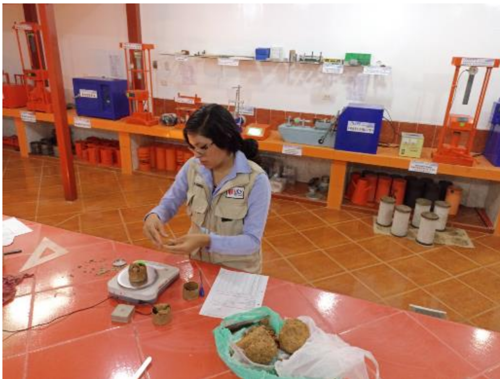
Foto N° 10: Pesamos la muestra de arcilla para sacar el límite líquido poniendo en las taras 250 gr cada uno.
