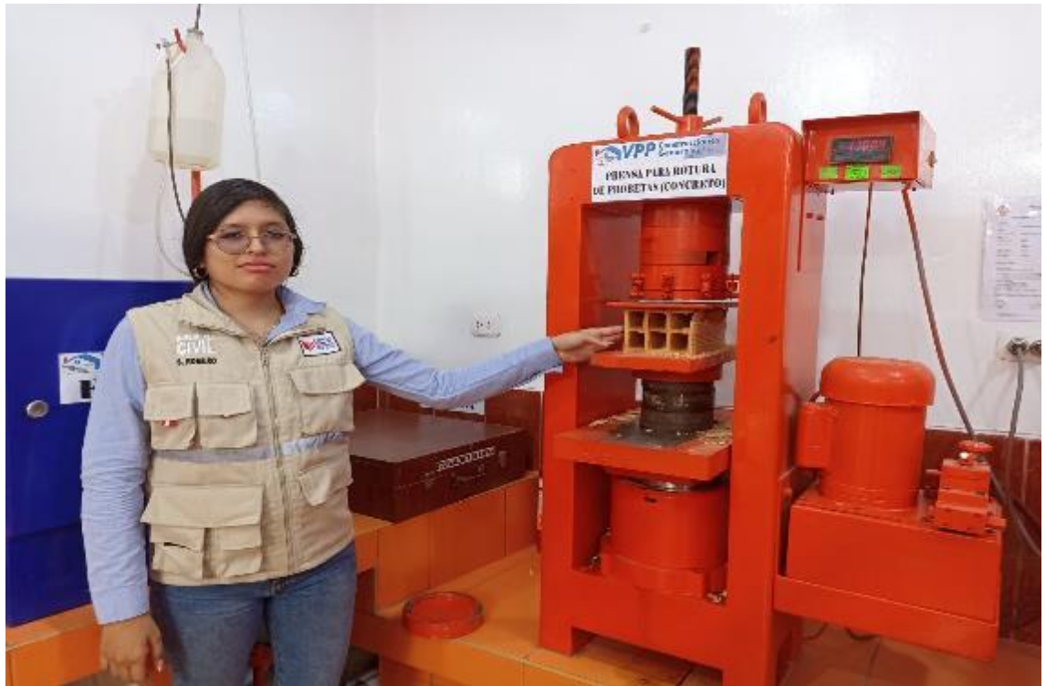
Foto N° 23: Se muestra el ensayo de resistencia a la compresión con las muestra de cada ladrillo a los 28 días.
