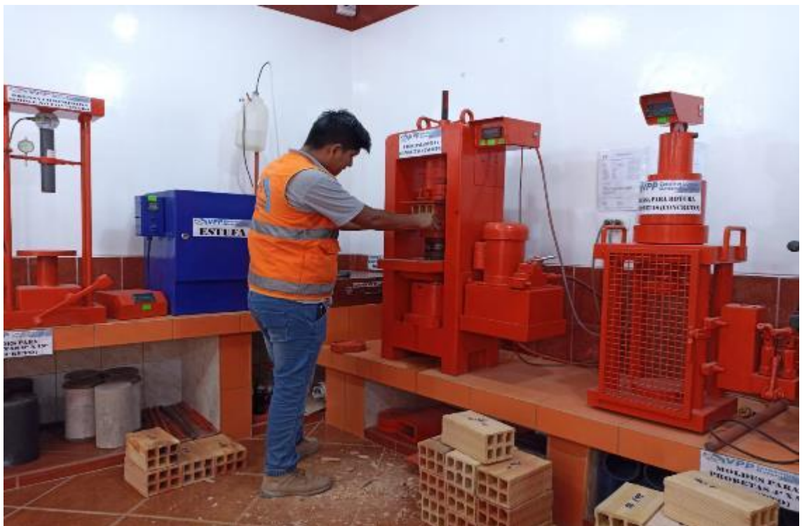
Foto N° 24: Personal técnico colocando el ladrillo de arcilla para el ensayo de resistencia a la compresión.
