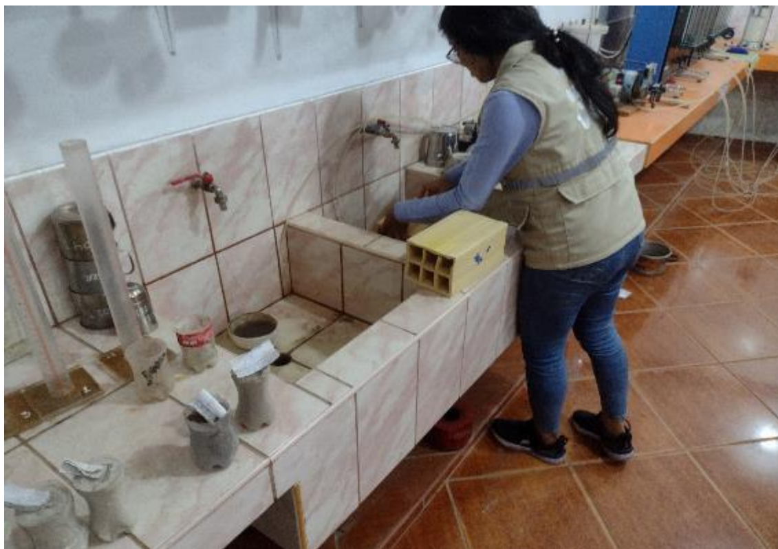
Foto N° 17: Cubrimos cada ladrillo de 3mm con para el ensayo de succión a los 14 días.
