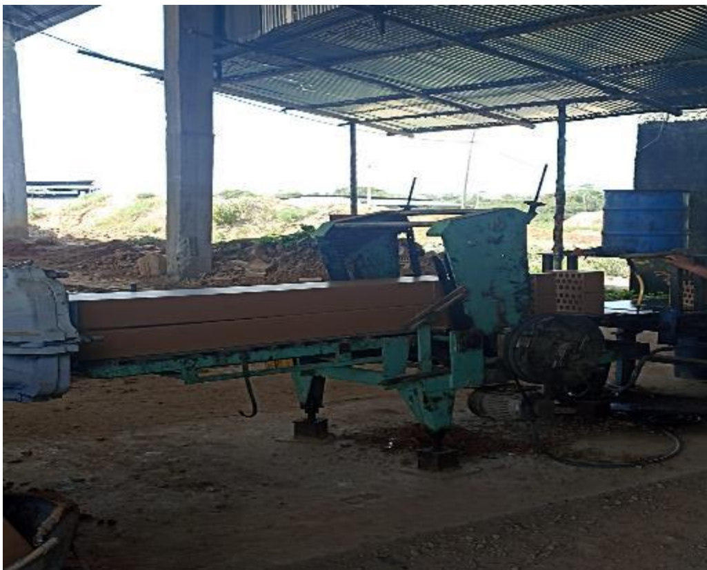
Foto N° 04: Maquina de ladrillo fabricando los ladrillos de arcilla.
