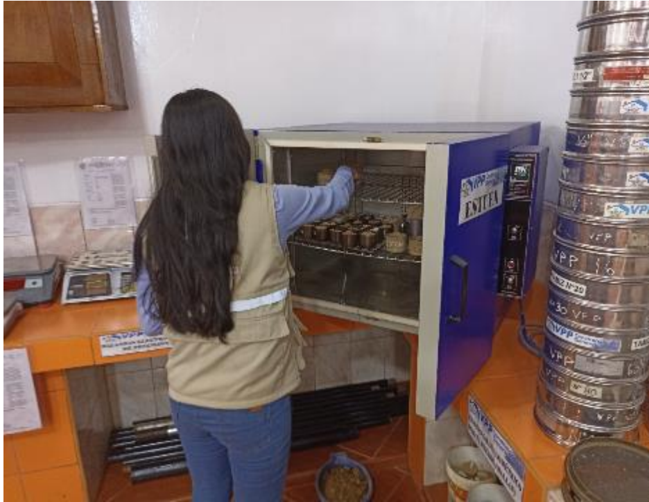
Foto N° 11: Ponemos en el horno las taras con la arcilla para el proceso de secado de 24 horas para el límite líquido.
