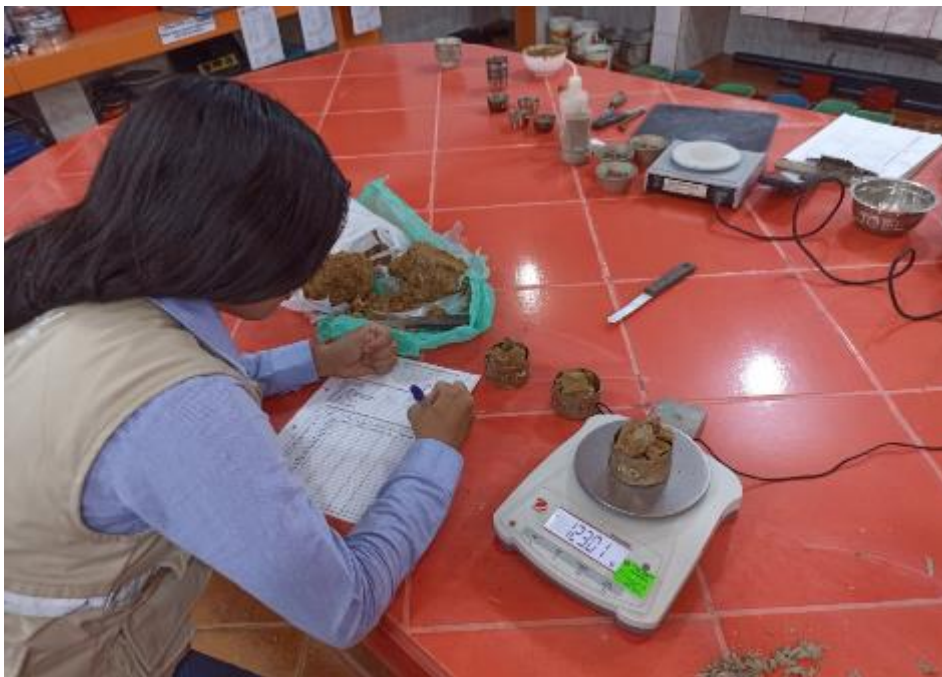
Foto N° 12: Anotamos el peso de la arcilla después del secado de las 24 horas para el proceso del límite líquido.
