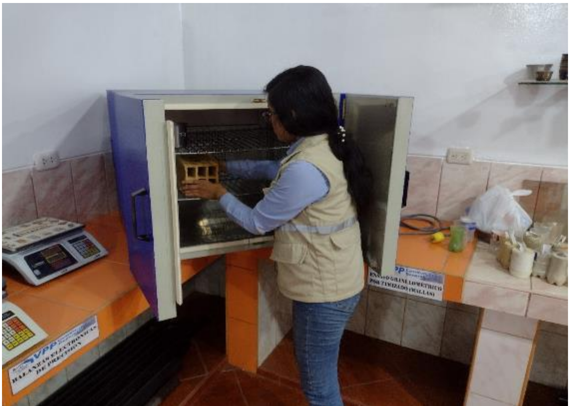
Foto N° 19: Colocamos cada ladrillo en el horno después del ensayo de succión, para el ensayo de absorción a los 14 días.
