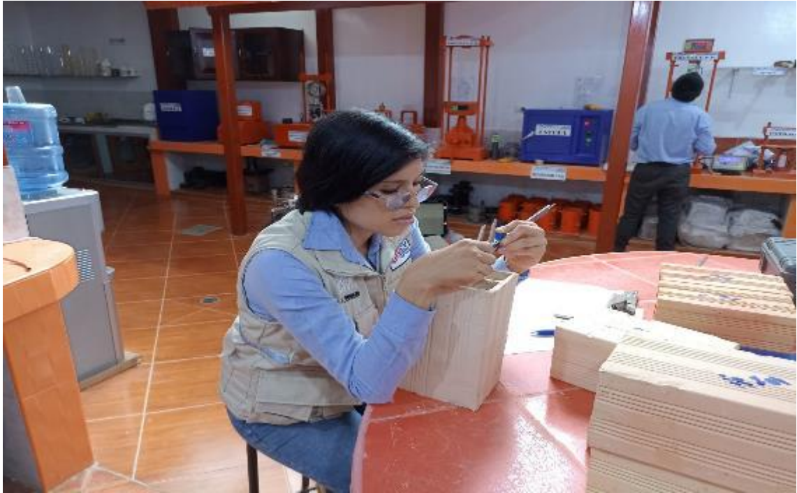
Foto N° 21: Medimos la dimensión de los ladrillos para ensayo de variabliada dimensional.
