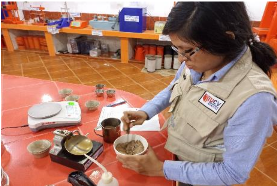
Foto N° 14: Agregamos a la arcilla agua destilada y removemos para el ensayo del límite plástico.
