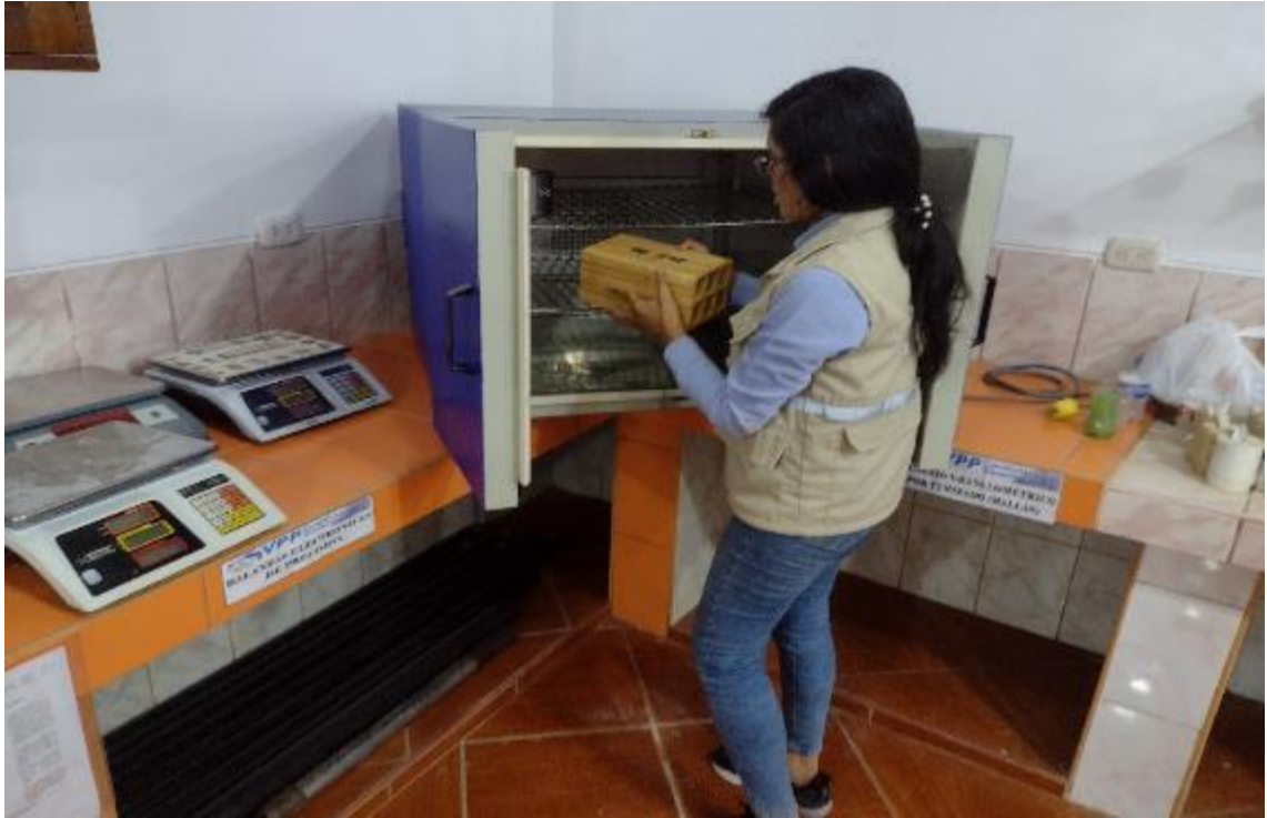
Foto N° 19: Colocamos cada ladrillo en el horno después del ensayo de succión, para el ensayo de absorción a los 14 días.
