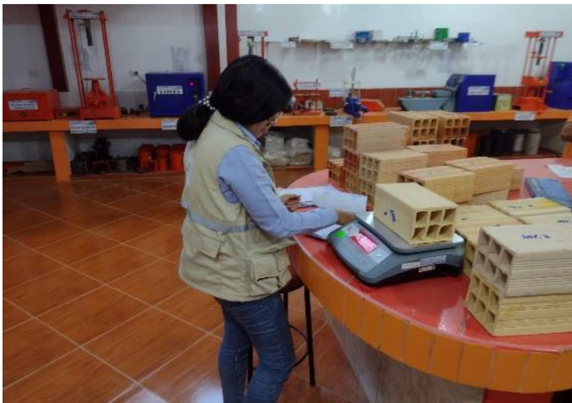
Foto N° 15: Pesamos cada ladrillo para el ensayo de succión pesado a los 7 días.
