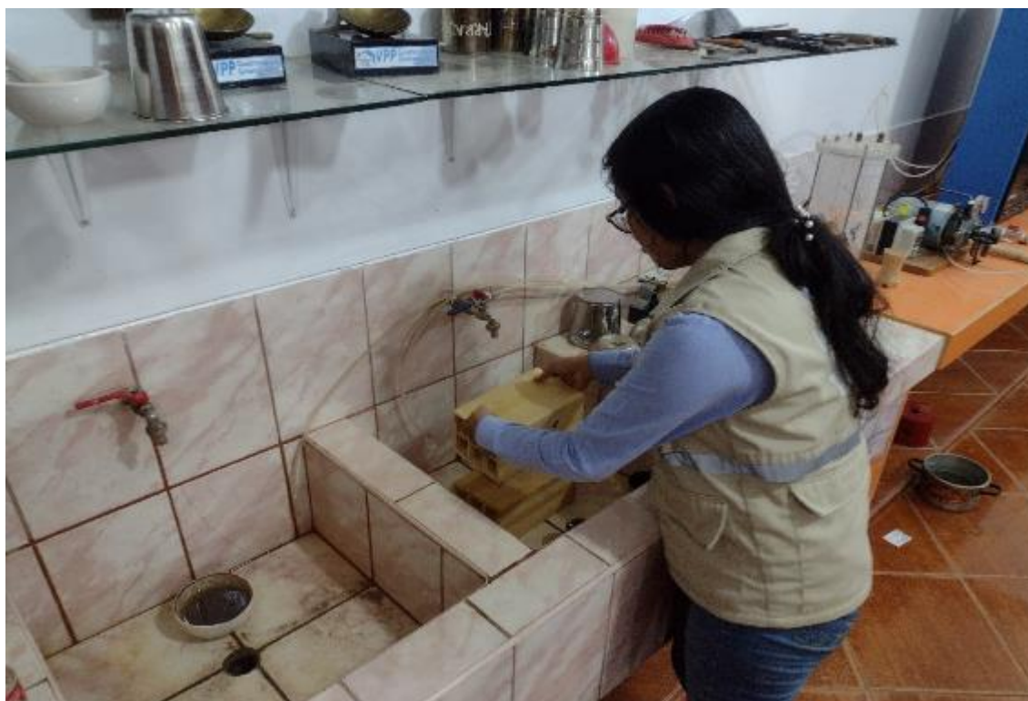
Foto N° 18: Cubrimos cada ladrillo de 3mm con para el ensayo de succión a los 28 días.
