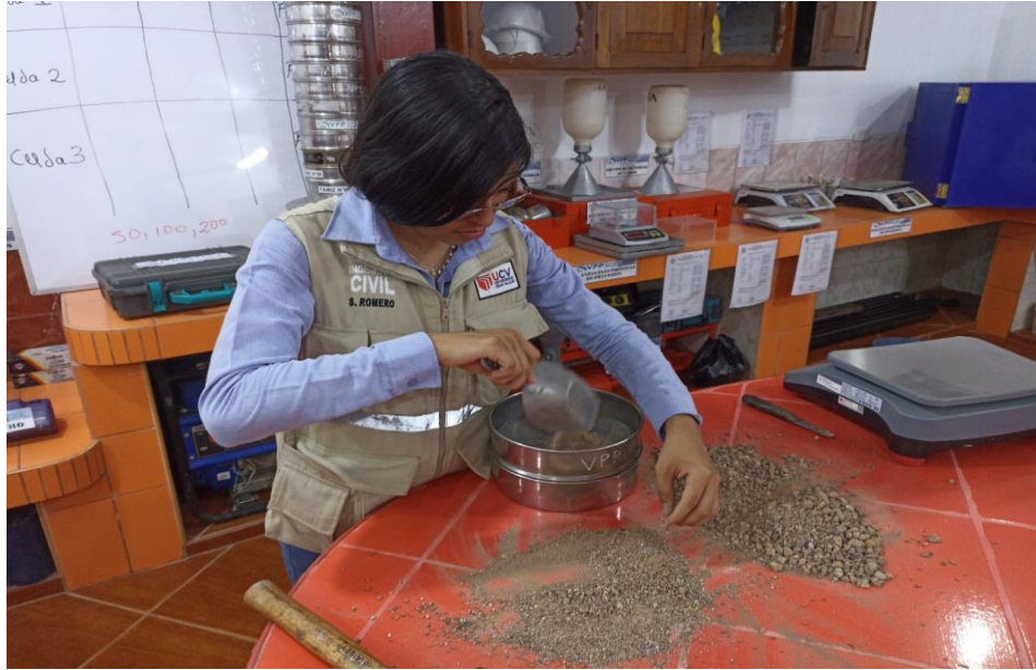
Foto N° 13: Pasamos la arcilla seca por el tamiz N #40 para el ensayo del límite plástico.
