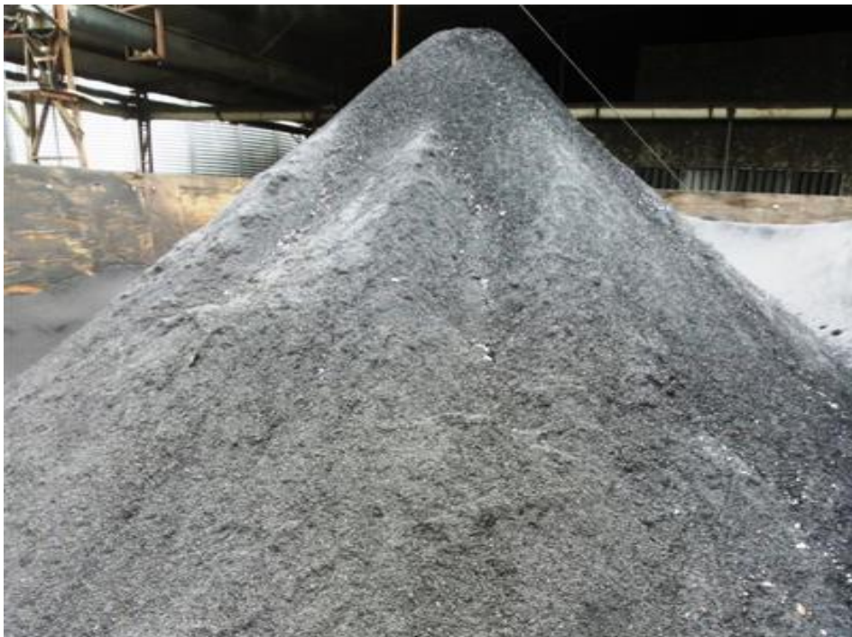
Foto N° 02: Selección de ceniza de cascarilla de arroz en el acopio de la ladrillera "Alto Mayo" para la elaboración de los ladrillos.
