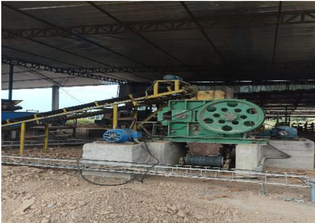
Foto N° 03: Maquina de ladrillo para la elaboración de los ladrillos de arcilla.
