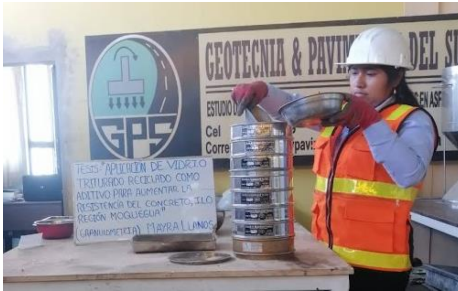
Ilustración 21 Granulometría de agregado grueso y fino
