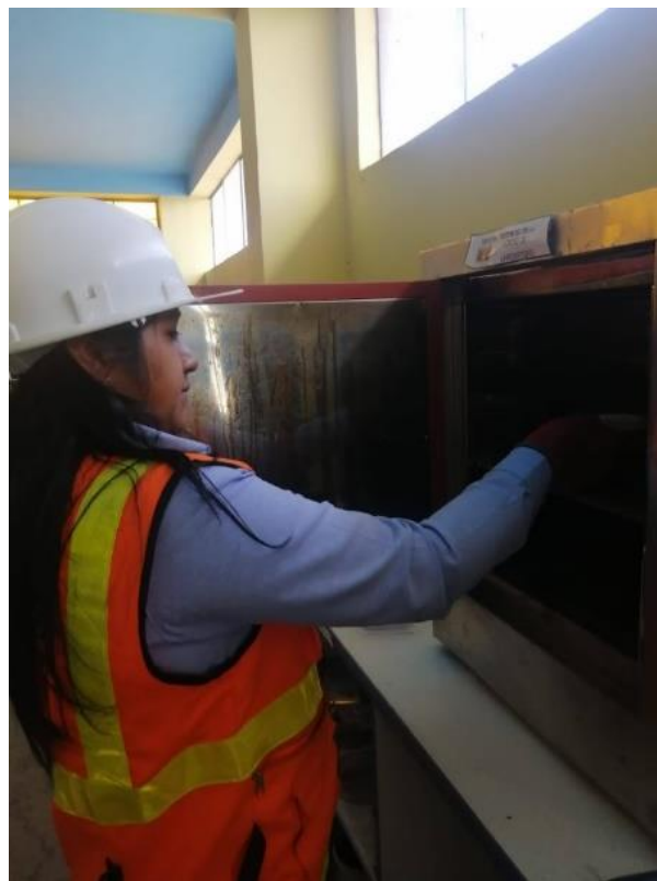
Ilustración 24 Ingreso de agregado al horno
