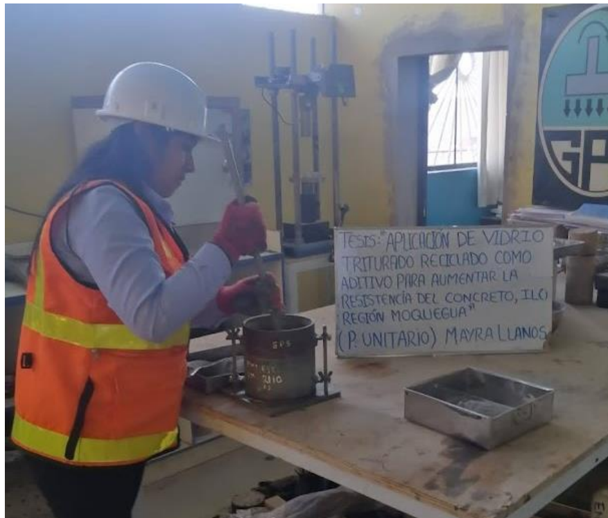
Ilustración 26 Ensayo de peso unitario
