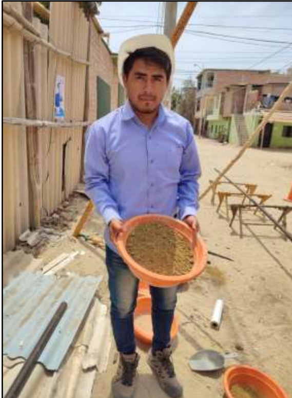
Descripción: Toma de muestras por cada metro Ensayo SPT, en sondeo "SPT-2" 07 Foto N°
