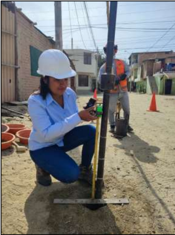
Descripción: Marcado de los 45 cm del Ensayo SPT, en sondeo "SPT-2" 04 Foto N°
