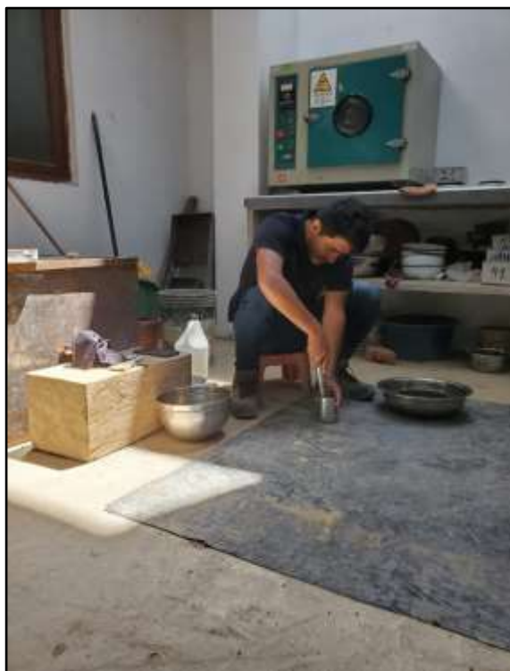
Descripción: Trituración de la muestra secada en el horno con la ayuda del mortero. 20 Foto N°
