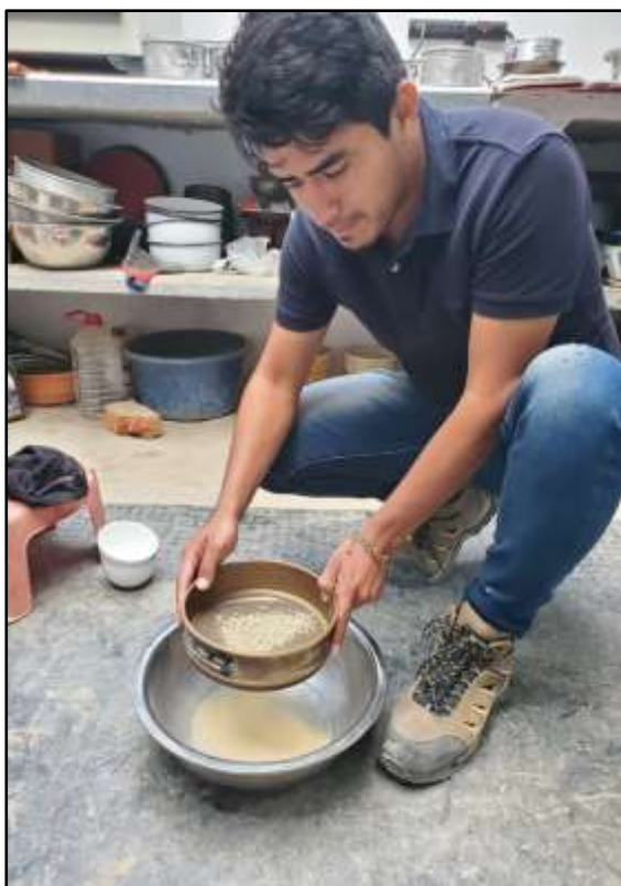
Descripción: Paso de muestras de arena con arcilla por el tamiz N°200 17 Foto N°
