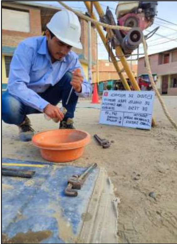
Descripción: Extracción de muestras del ensayo SPT, en sondeo "SPT-3" 2-2.45 m 10 Foto N°
