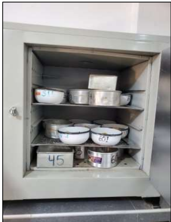
Descripción: Secado de las muestras por cada estrato en el horno a 110 +/- 5C° 16 Foto N°
