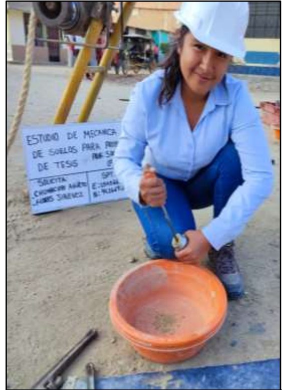
Descripción: Extracción de muestras del ensayo SPT, en sondeo "SPT-3" 5-5.35 m 11 Foto N°
