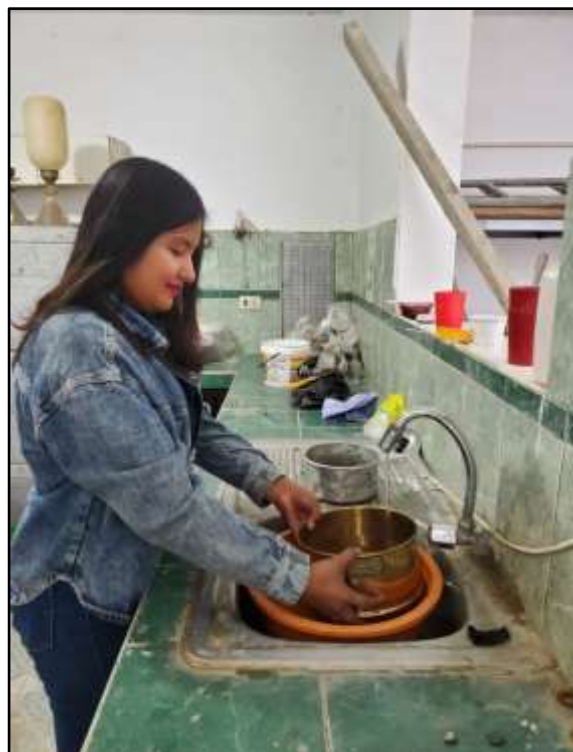
Descripción: Lavado de suelos por la malla N°200 para retirar cualquier tipo de impureza 26 Foto N°
