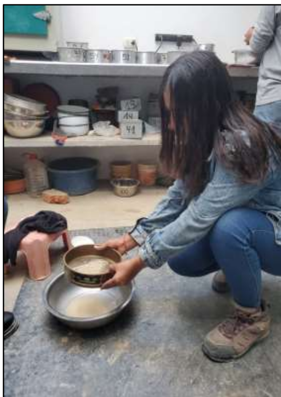
Descripción: Paso de muestras de arena con arcilla por el tamiz N°200 18 Foto N°
