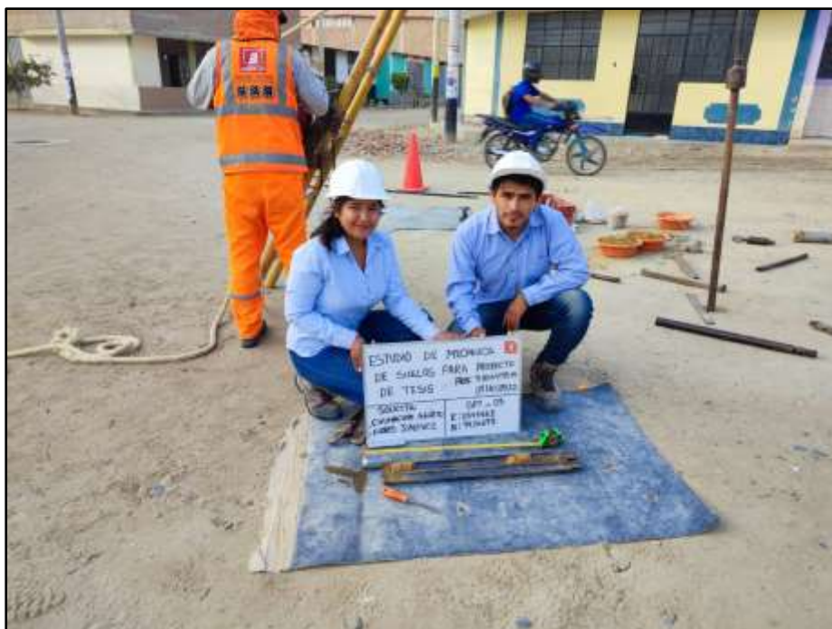
Descripción: Ensayo SPT, en sondeo "SPT-3" 4-4.45 m 09 Foto N°
