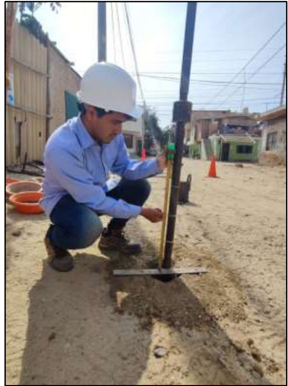
Descripción: Marcado de los 45 cm del Ensayo SPT, en sondeo "SPT-2" 05 Foto N°
