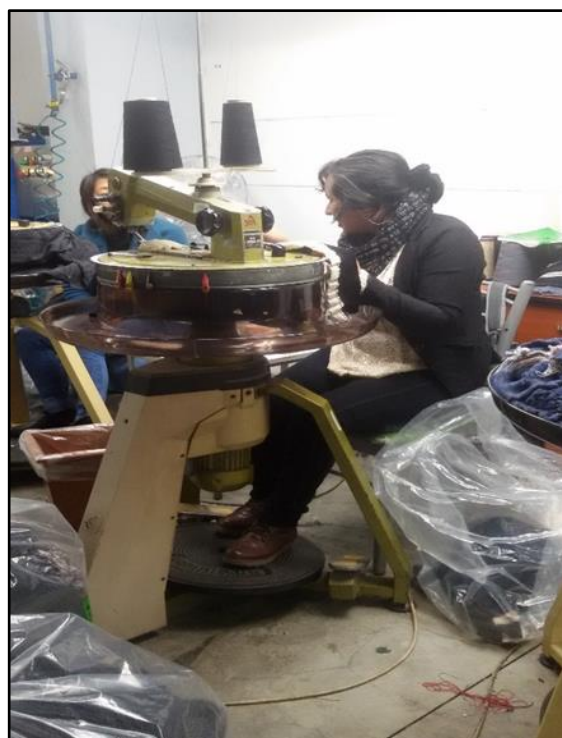
Figura N°8: Platillado de piezas.
