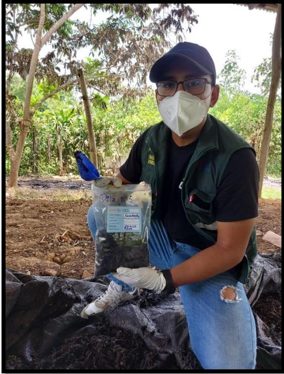
**Figura 18: Toma de muestras de las pilas para analizarlos en laboratorio.**
