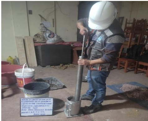
Foto 09. Compactación para ensayo de CBR.
