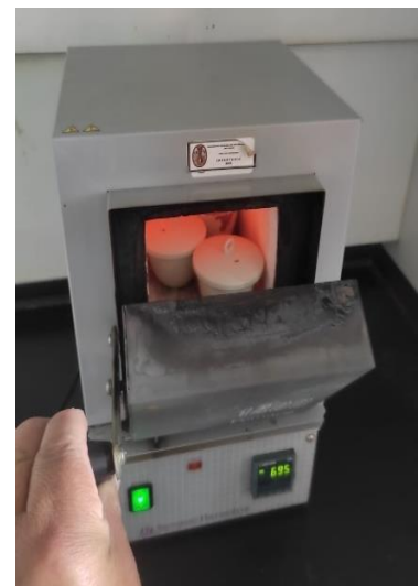
Figura 9. Calcinación de ceniza de ichu en mufla a 700°C
