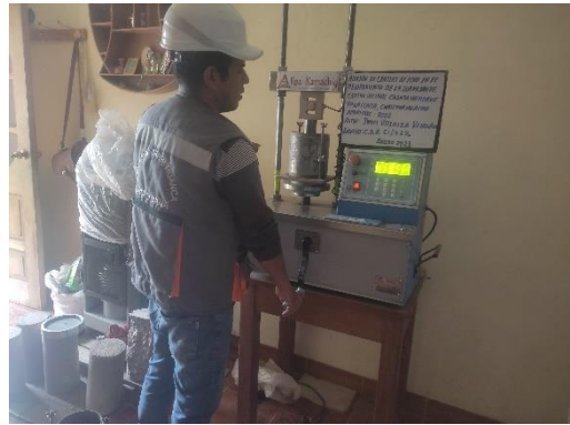
Foto 10. Ensayo de CBR.
