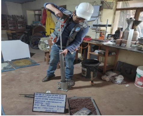
Foto 07. Compactación para ensayo de proctor.
