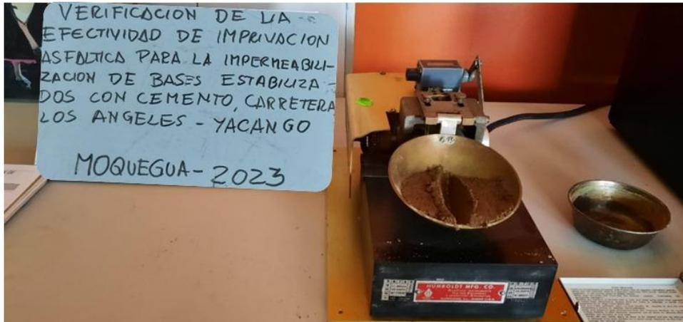
Figura 5. Proceso ensayos de límites de consistencia. Fuente: Propia
