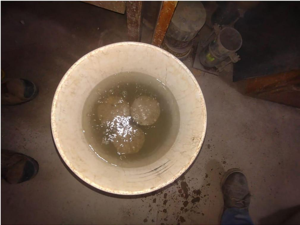
Figura 32. Saturación de las muestras. Fuente: Propia.
