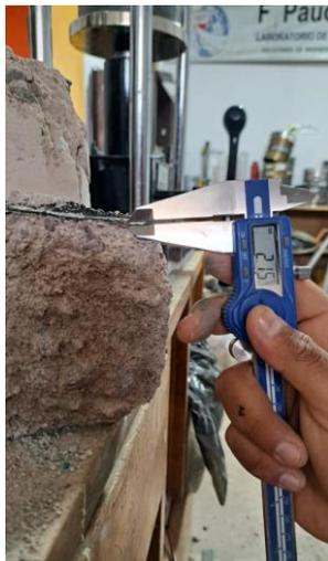
**Foto N° 23:** Medición de la penetración de imprimación asfáltica en la briqueta de suelo cemento.
