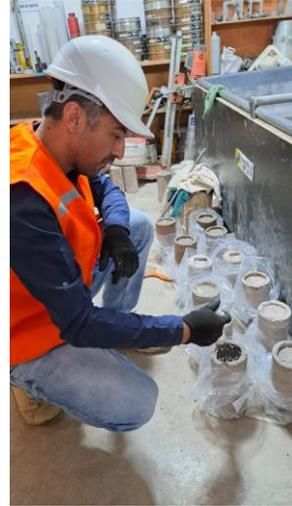
**Foto N° 18:** Aplicación de imprimación asfáltica en probetas suelo cemento.
