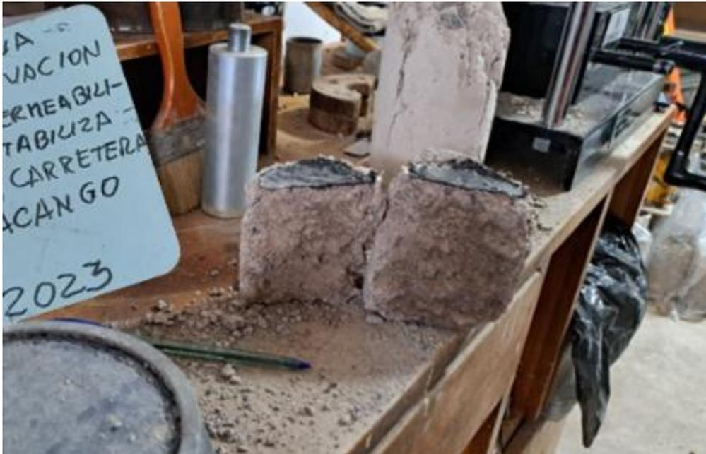
*Figura 29.* Rotura típica de briquetas para su óptima medición.
