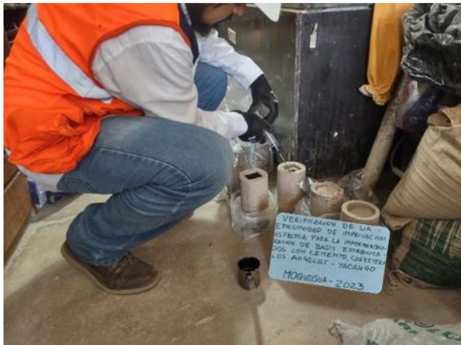
Figura 27. Aplicación de la imprimación asfáltica en las briquetas de suelo cemento. Fuente: Propia.
