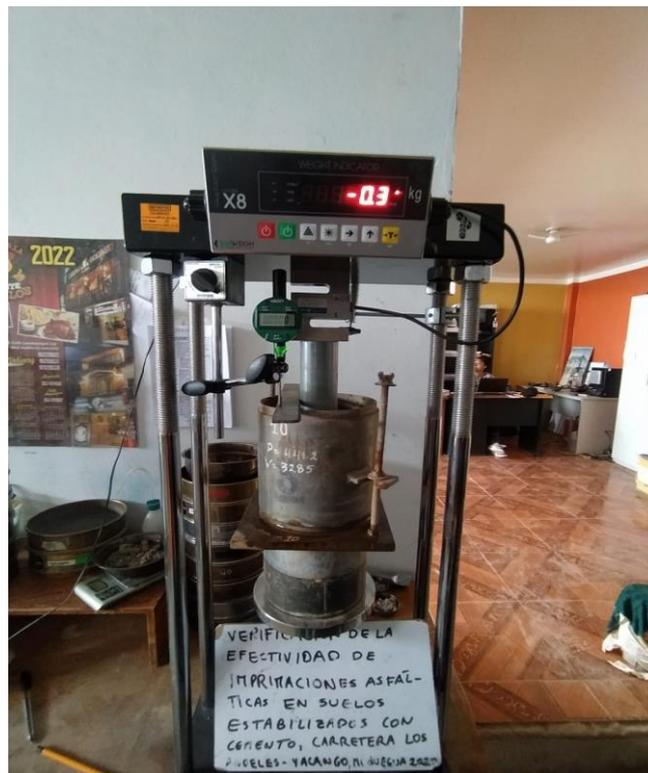
Figura 8. Proceso ensayo CBR. Fuente: Propia.
