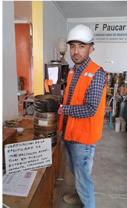
*Figura 4.* Proceso de tamizado en laboratorio
