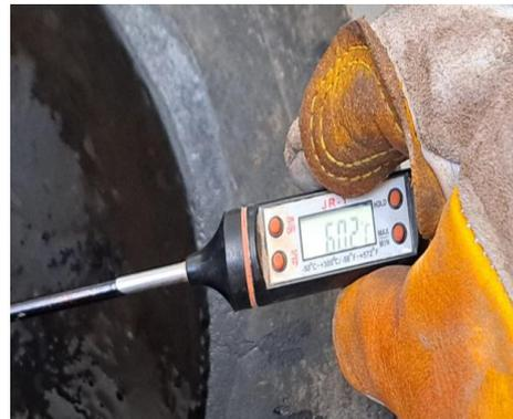
**Foto N° 16:** Temperatura alcanzada de 60°C para la aplicación de las briquetas.
