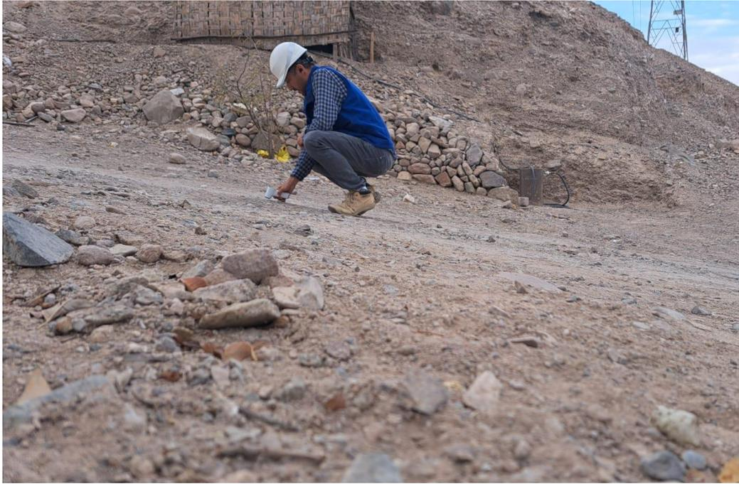
*Figura 23.* Toma de temperatura in situ en vía de intervención.
