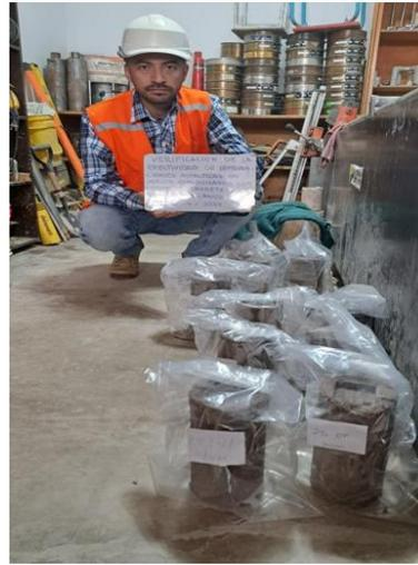
**Foto N° 14:** Proceso de fraguado y curado de briquetas.
