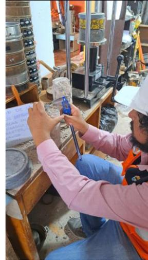
**Foto N° 22:** Medición de la penetración de imprimación asfáltica en la briqueta de suelo cemento.
