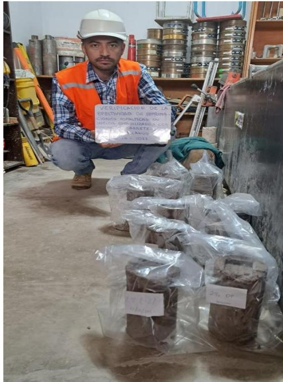
*Figura 22.* Proceso de fraguado y curado de briquetas. Fuente: Propia.
