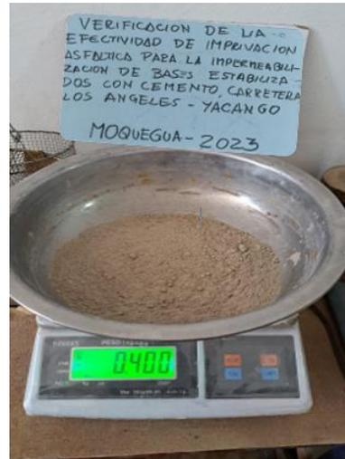
**Foto N° 10:** Dosificación del suelo para la preparación de suelo cemento.
