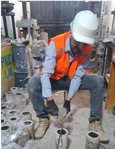
**Foto N° 19:** Proceso de rotura vertical de las briquetas para análisis de penetración.
