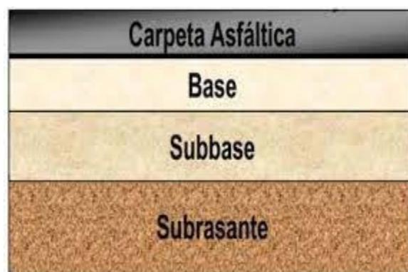
*Figura 1.* Conformación de un pavimento flexible.
