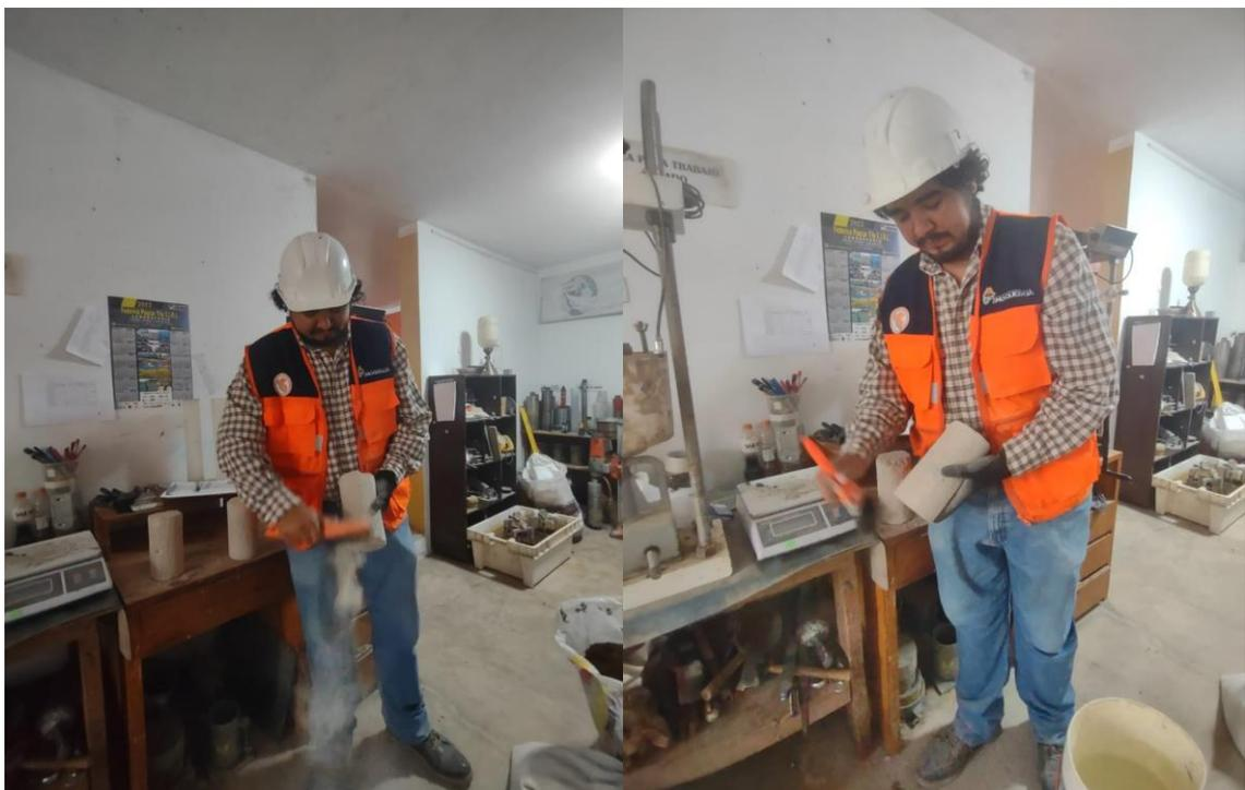
Figura 35. Cepillado y limpieza de restos con brocha de las briquetas. Fuente: Propia.
