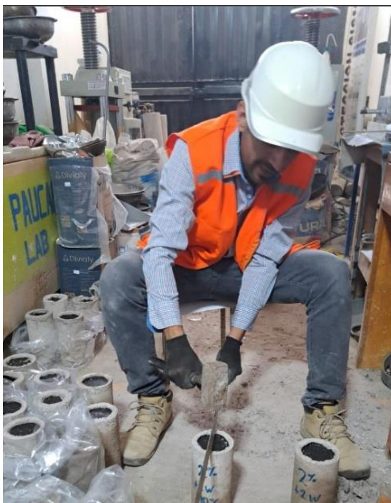
*Figura 28.* Proceso de rotura vertical de las briquetas para análisis de penetración. Fuente: Propia.
