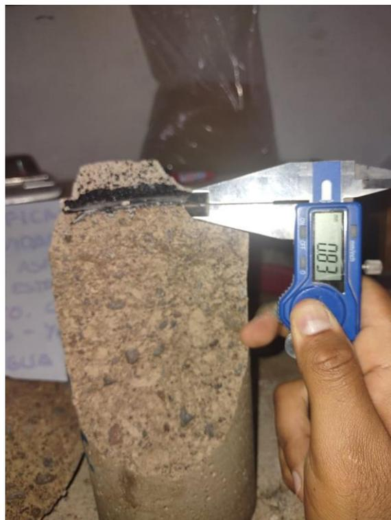
*Figura 30.* Medición de la penetración de imprimación asfáltica en la briqueta de suelo cemento. Fuente: Propia.
