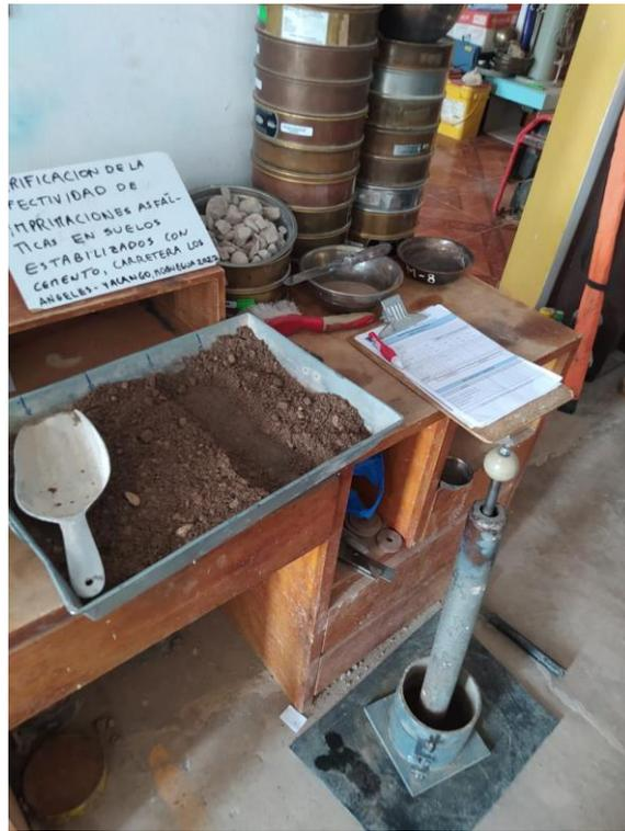
Figura 6. Proceso ensayo Proctor. Fuente: Propia
