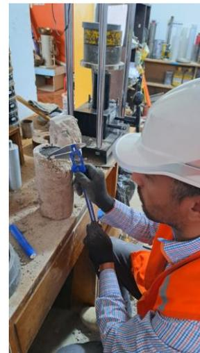
**Foto N° 24:** Medición de la penetración de imprimación asfáltica en la briqueta de suelo cemento.
