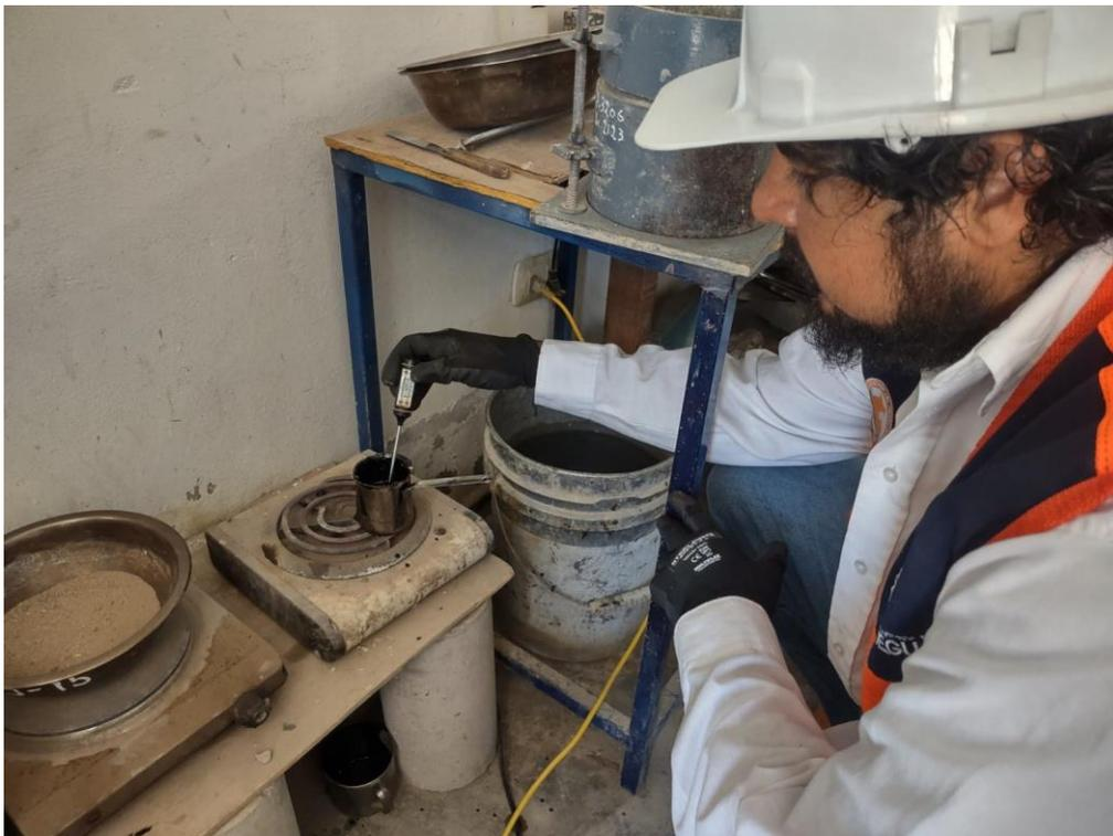
*Figura 25.* Proceso de incremento de temperatura de la emulsión asfáltica para la aplicación en las briquetas. Fuente: Propia.
