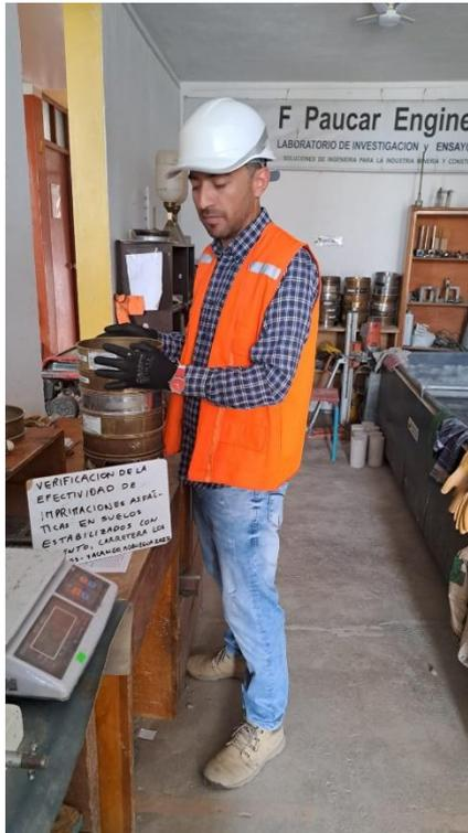
Figura 14. Tamizado del material para el análisis granulométrico. Fuente: Propia.
