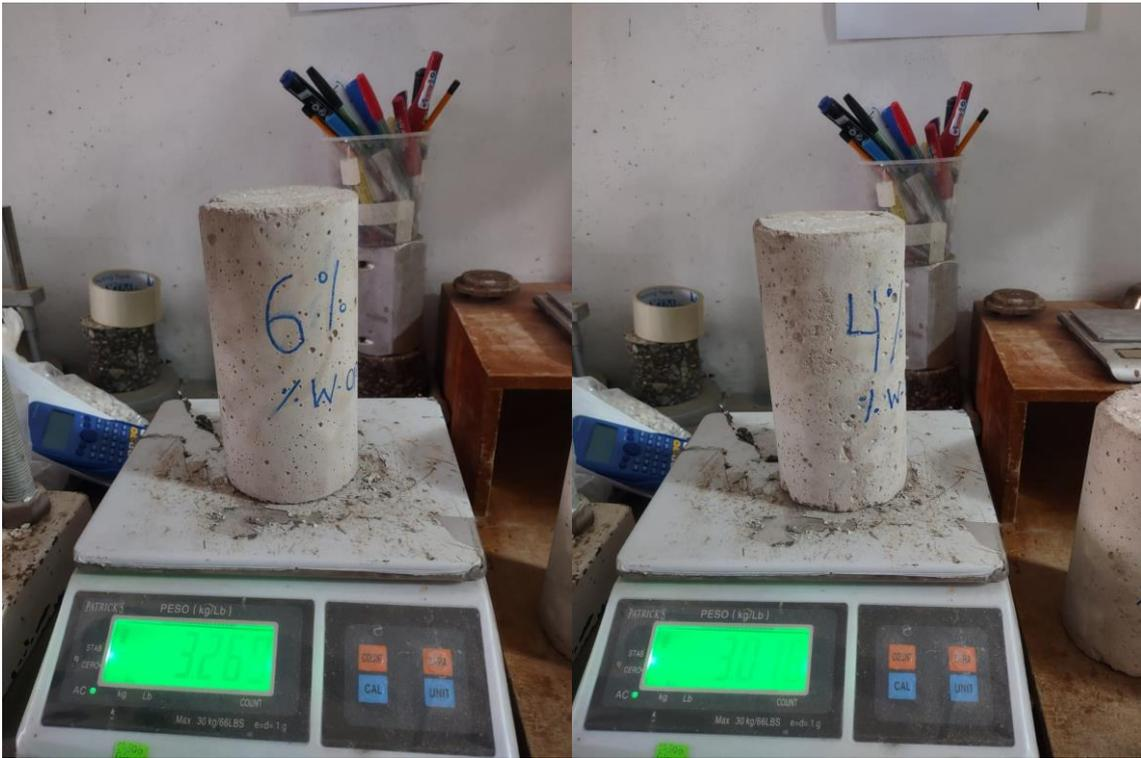
Figura 34. Toma de medidas: peso, altura y diámetro. Fuente: Propia.
