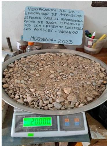
**Foto N° 09:** Dosificación del suelo para la preparación de suelo cemento.
