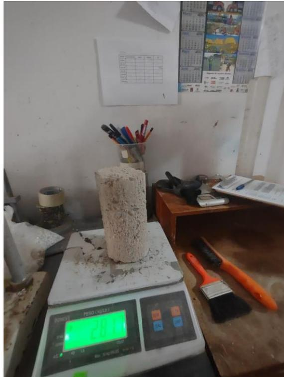
*Figura 36.* Toma de medidas de las briquetas después del cepillado.
