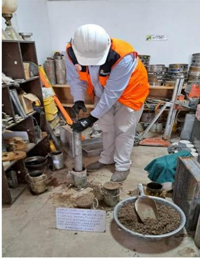
**Foto N° 13:** Vaciado de briquetas de suelo cemento en los moldes.
