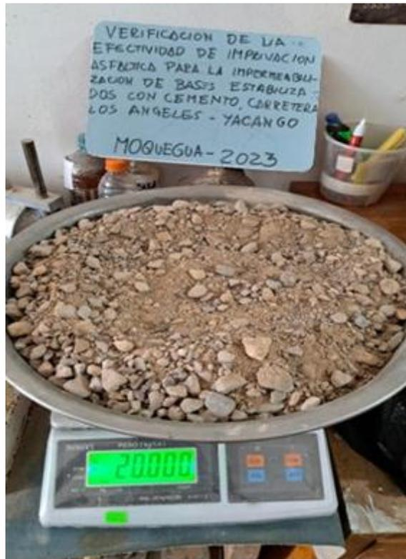
Figura 17. Dosificación de suelo para preparación de suelo cemento.
