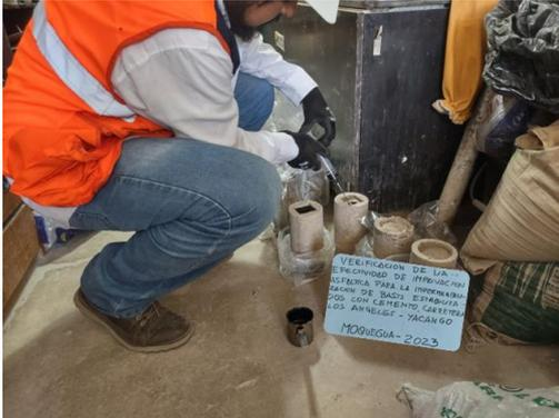
**Foto N° 17:** Aplicación de imprimación asfáltica en probetas suelo cemento.
