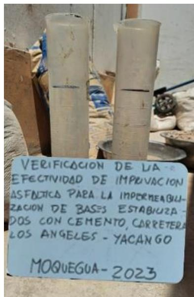
Figura 44. Control de agua (%humedad) en el diseño de suelo cemento.
