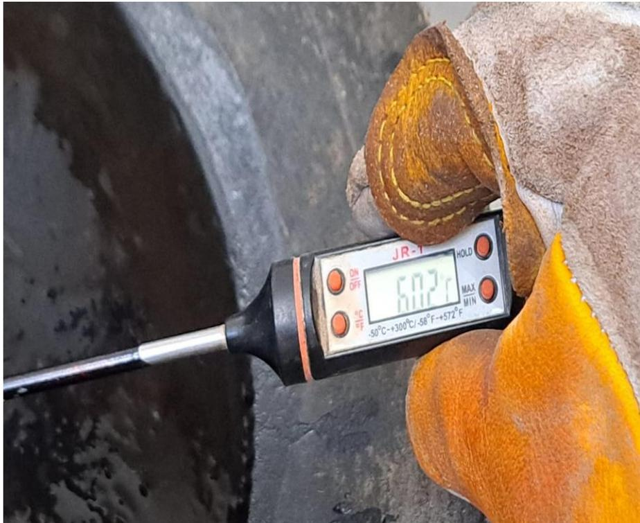
Figura 26. Temperatura alcanzada de 60°C para la aplicación de las briquetas. Fuente: Propia.
