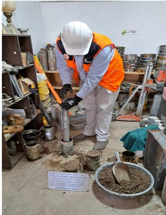
*Figura 21.* Vaciado de briquetas de suelo cemento en los moldes. Fuente: Propia.
