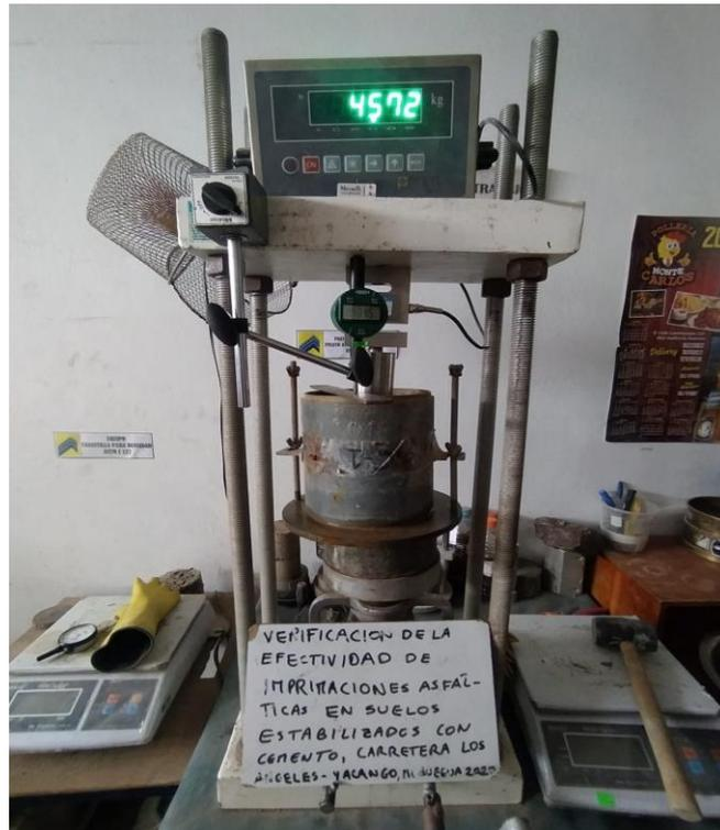
Figura 9. Proceso ensayo CBR. Fuente: Propia.
