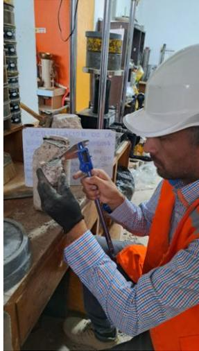
**Foto N° 21:** Medición de la penetración de imprimación asfáltica en la briqueta de suelo cemento.
