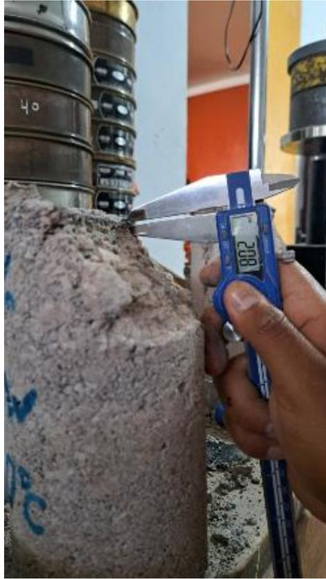
*Figura 31.* Medición de la penetración de imprimación asfáltica en la briqueta de suelo cemento. Fuente: Propia.
