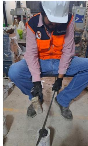
**Foto N° 20:** Proceso de rotura vertical de las briquetas para análisis de penetración.
