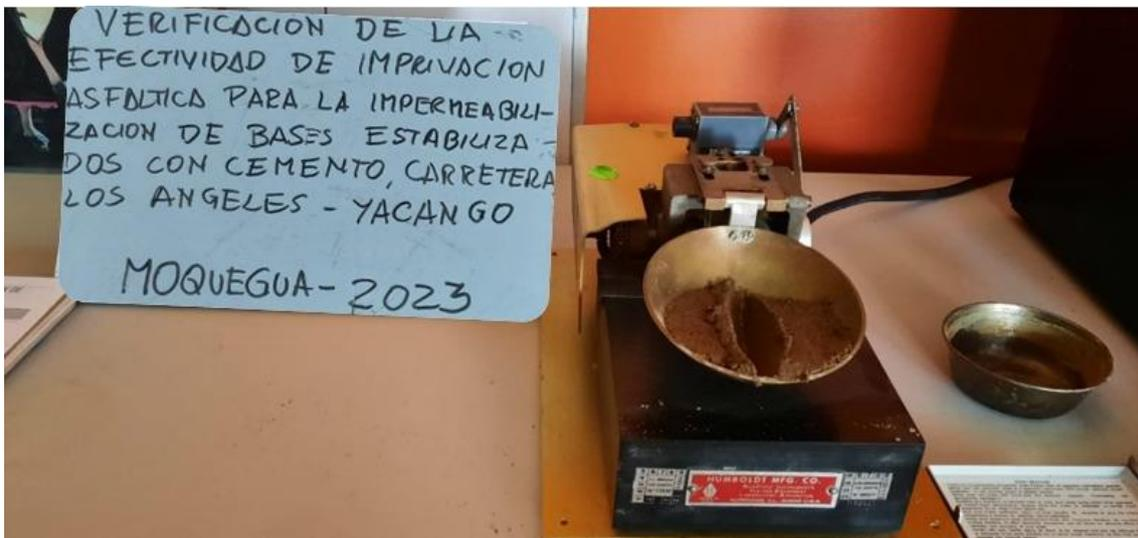
Figura 15. Ensayo de Límites de Atterberg. Fuente: Propia.
