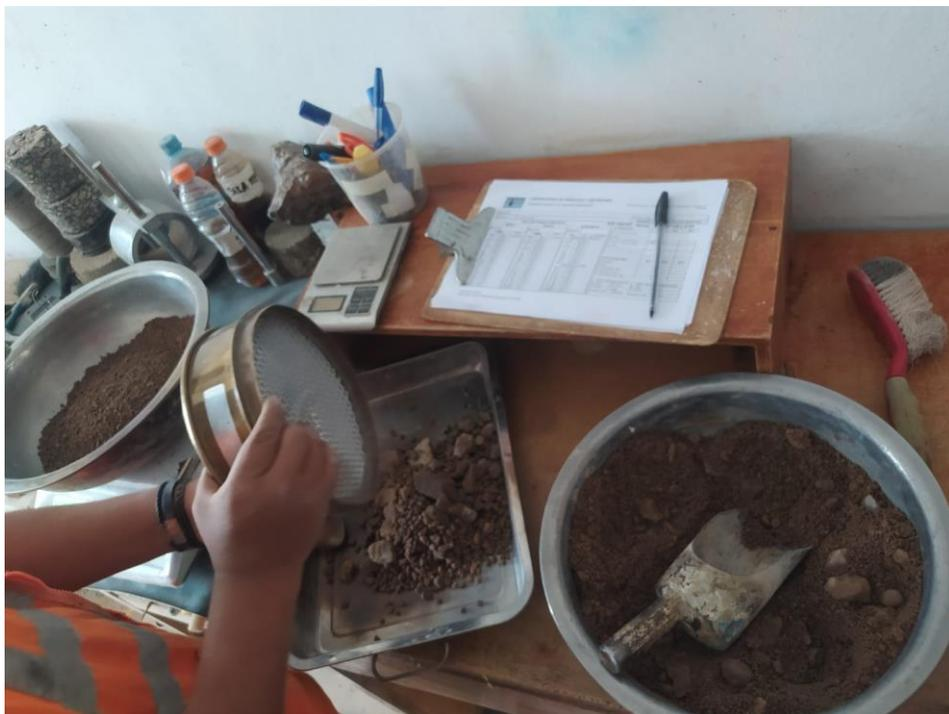
Figura 7. Proceso ensayo Proctor. Fuente: Propia.
