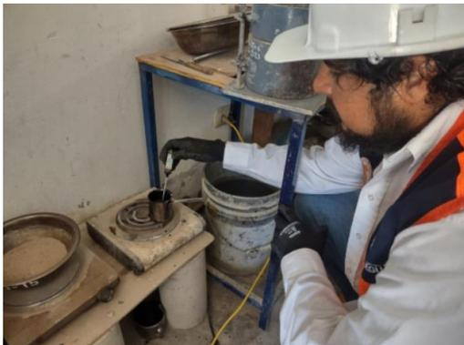
**Foto N° 15:** Calentamiento del material asfáltico para la aplicación en briquetas.
