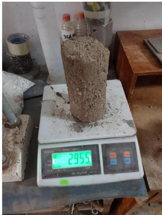
*Figura 37.* Toma de medidas de las muestras después del cepillado y después de la saturación. Fuente: Propia.
