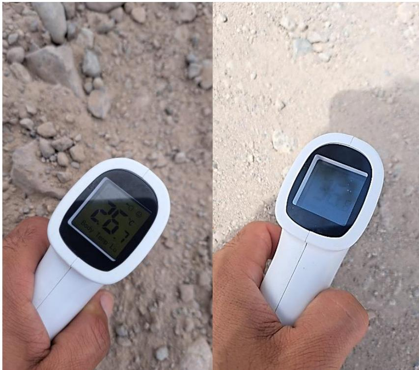
*Figura 24.* Toma de temperatura in situ en vía de intervención.
