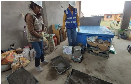
Ensayo peso unitario suelto del agregado fino
