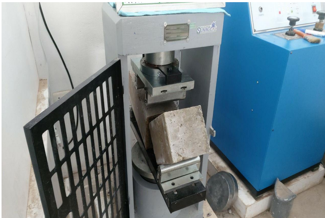
Figura 13. Ensayo a la viga sometida a resistencia a flexión de viga de concreto.
