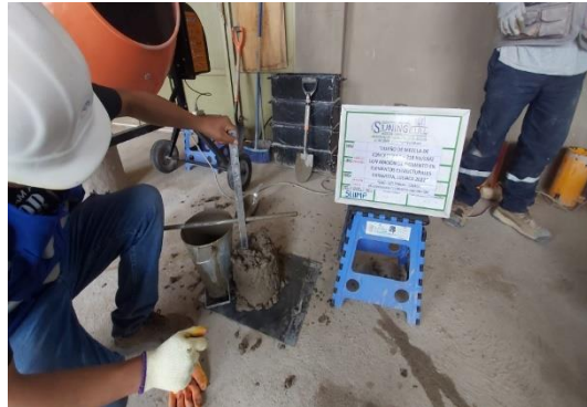
Medición del asentamiento
