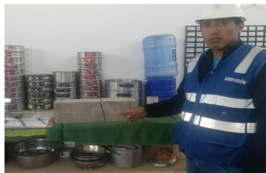
Viga sometida a flexión, cuya falla se dio en el tercio medio
