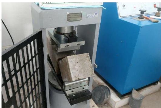
Ensayo de resistencia a flexión de las vigas de concreto.
