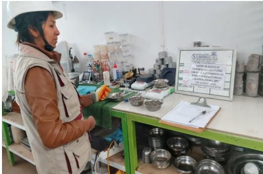
Pesado de la muestra para ensayo de contenido de Humedad de AF y AG
