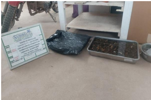
Muestra de agregado grueso sumergido en agua para ensayo de densidad, densidad relativa y absorción
