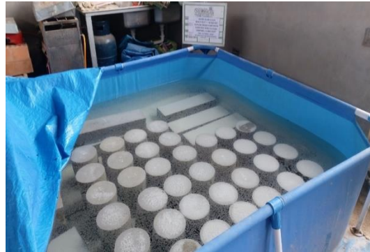
Curado de briquetas y vigas de concreto f'c=210\text{kg/cm}^2 con adición de pigmento en un 0%, 5%, 7.5% y 10%
