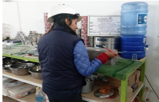
Medición los tercios de la viga de concreto
