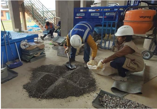
Selección de la muestra por medio del cuarteo
