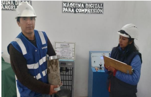
Rotura de briquetas de concreto
