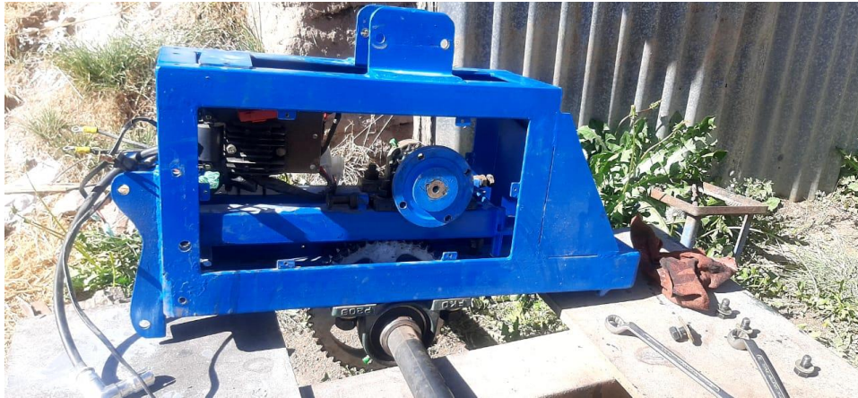
Figura 34: Montaje del Sistema de Transmisión
