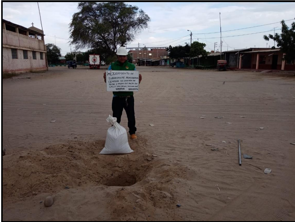
Figura 9. Calicata en sitio C-01
