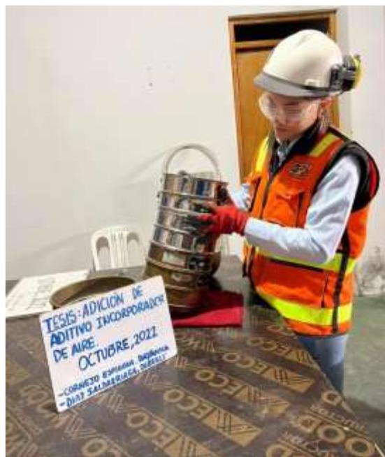
Figura 18. Ensayo Granulométrico (Fuente Propia)
