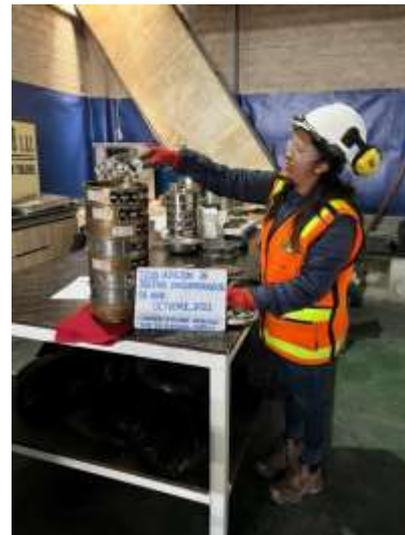
**Foto N° 08:** Realizar el tamizado de la muestra seca
