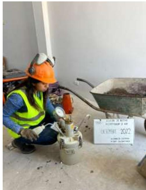
**Foto N° 16:** Incorporación de líquido para medir contenido de vacíos
