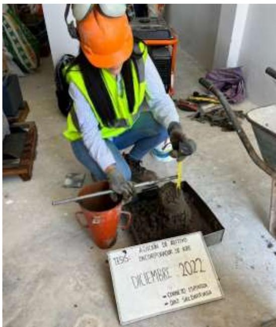
Figura 24. Realización de Slump (Fuente Propia)
