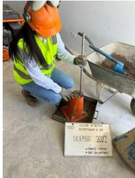
**Foto N° 14:** Aplicación de 3 capas y 25 golpes entre capas.
