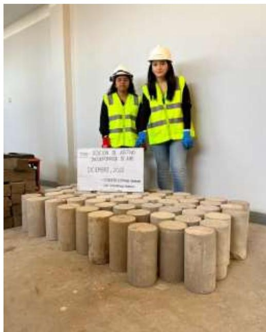
Figura 31. Probetas curadas (Fuente Propia)
