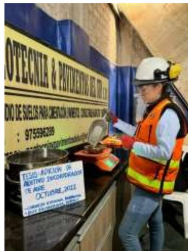
**Foto N° 10:** Peso de la muestra para ensayo, 300gramos.
