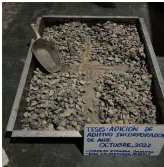
*Figura 13. Cuarteo de Muestra Agregado Grueso (Fuente Propia)*
