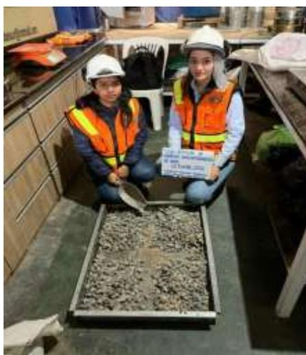
Figura 15. Cuarteo de Muestra Agregado Fino (Fuente Propia)
