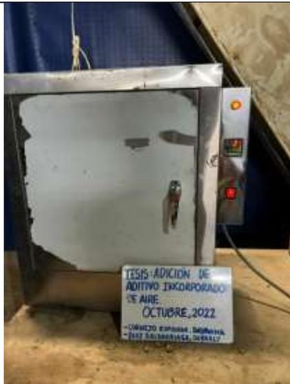
**Foto N° 07:** Secado de la muestra, temperatura  $110\text{ }^{\circ}\text{C} \pm 5\text{ }^{\circ}\text{C}$
