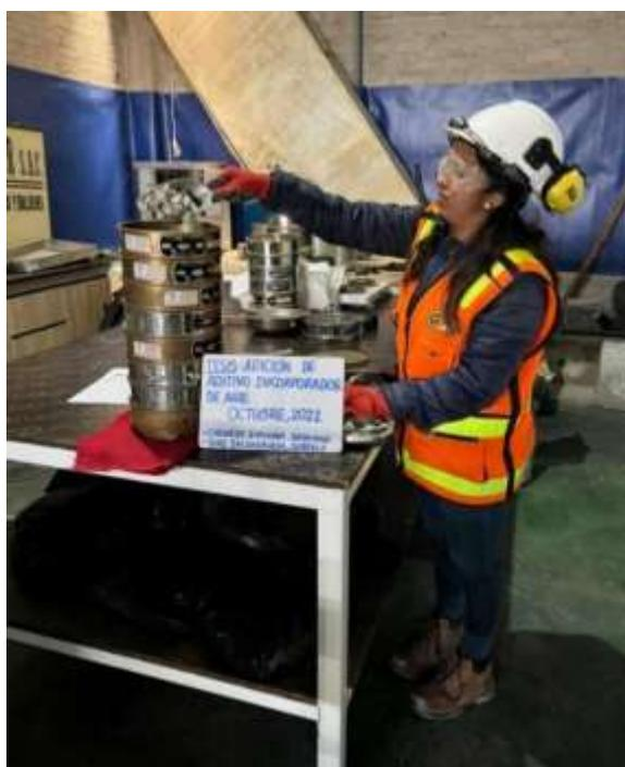
*Figura 16.* Ensayo Granulométrico (Fuente Propia)
