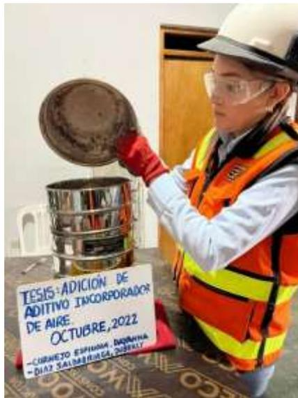
Figura 17. Ensayo Granulométrico (Fuente Propia)
