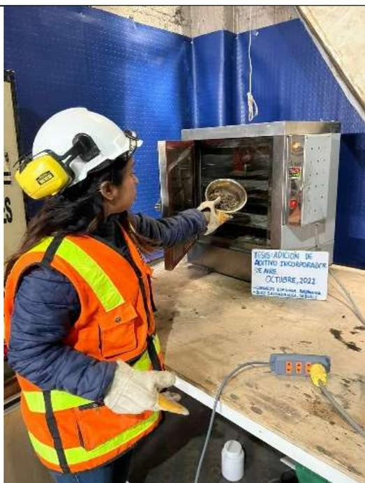
**Foto N° 11:** Secado de la muestra, temperatura  $110\text{ }^{\circ}\text{C} \pm 5\text{ }^{\circ}\text{C}$
