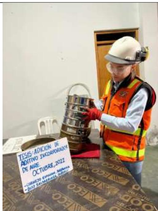
**Foto N° 12:** Realizar el tamizado de la muestra seca
