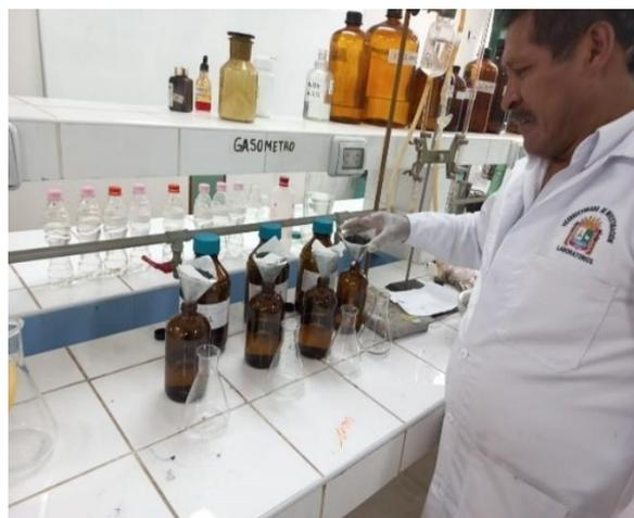
Figura 24. Filtración del agua subterránea por las dosis de carbón con hematita.
