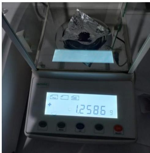
Figura 16. Pesaje del carbón activado con hematita triturada.
