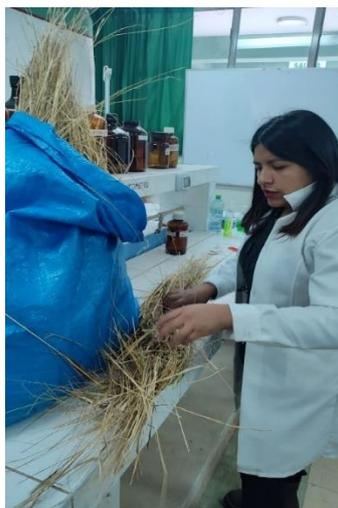
Figura 9. Selección de la biomasa para la determinación de humedad.
