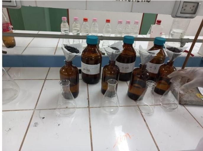
Figura 25. Filtración final para llevar a analizar la nueva concentración.
