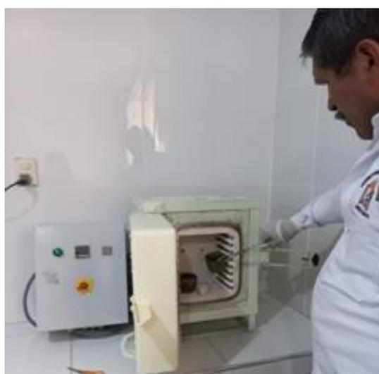
Figura 14. Secado del carbón oxidado.
