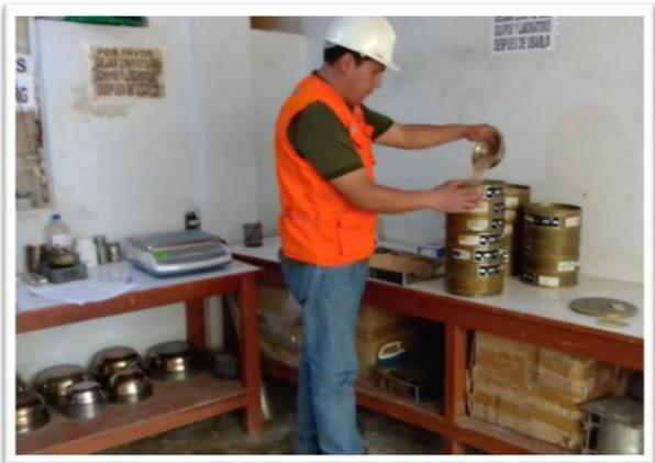
Evidencias fotográficas 7 y 8, ensayo: granulometría de agregados.
