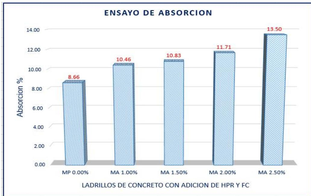
Figura 34: Gráfico resumen del ensayo de absorción de los ladrillos de concreto de la muestra patrón y con adición de 1.00%=(0.75%HPR + 0.25%FC), 1.50% =(1.00%HPR + 0.50%FC), 2.00% =(1.25%HPR + 0.75%FC), 2.50% =(1.50%HPR + 1.00%FC), hoja de pino radiata (HPR) y fibra de capulí (FC).
