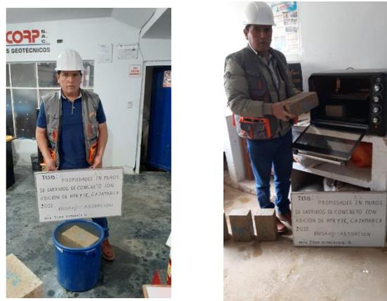
Figura 33: Ensayo físico de absorción en ladrillos de concreto; grupos: patrón y adicionados con 1.00%, 1.50%, 2.00% y 2.50% de HPR y FC.
