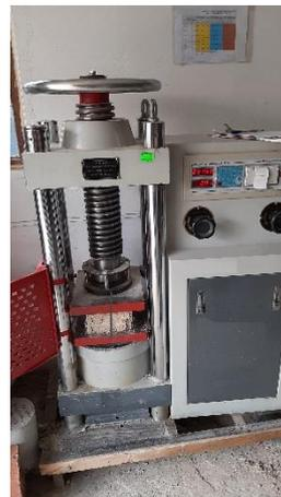
Figura 38: Ensayo resistencia a la compresión en ladrillos de concreto a los 14 días; grupos: patrón y adicionados con 1.00%, 1.50%, 2.00% y 2.50% de HPR y FC.
