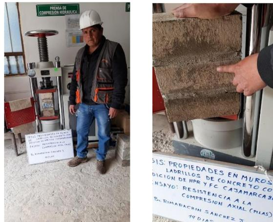
Figura 44: Ensayo resistencia a la compresión axial en ladrillos de concreto a los 14 días; grupos: patrón y adicionados con 1.00%, 1.50%, 2.00% y 2.50% de HPR y FC.
