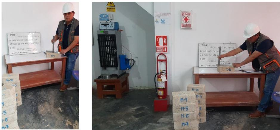
Figura 31: Ensayo físico de alabeo en ladrillos de concreto; grupos: patrón y adicionados con 1.00%, 1.50%, 2.00% y 2.50% de HPR y FC.
