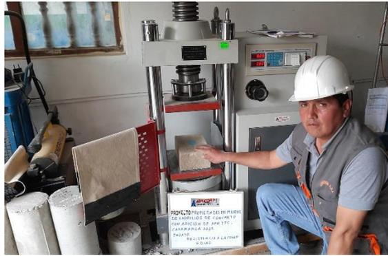
Figura 37: Ensayo resistencia a la compresión en ladrillos de concreto a los 7 días; grupos: patrón y adicionados con 1.00%, 1.50%, 2.00% y 2.50% de HPR y FC.
