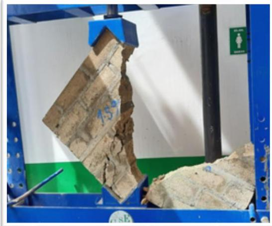
Evidencias fotográficas 40 y 41, ensayo: resistencia a la compresión diagonal, 14 días.
