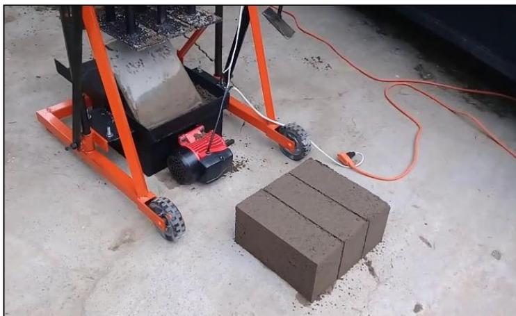
Figura 9. Fabricación semi industrial de ladrillo de concreto.
