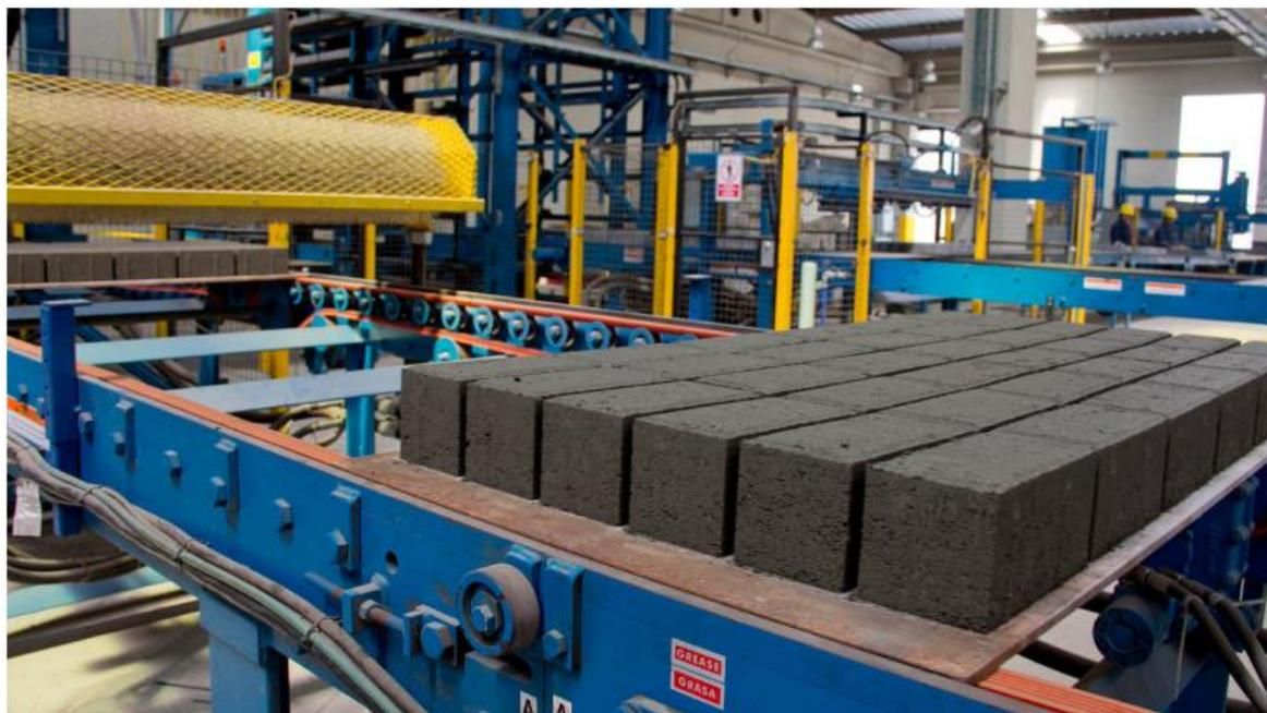
Figura 10. Fabricación industrial de ladrillos de concreto.
