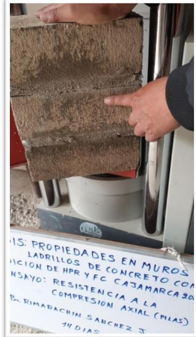
Evidencias fotográficas 34, 35 y 36, ensayo: resistencia a la compresión axial, 14 días.
