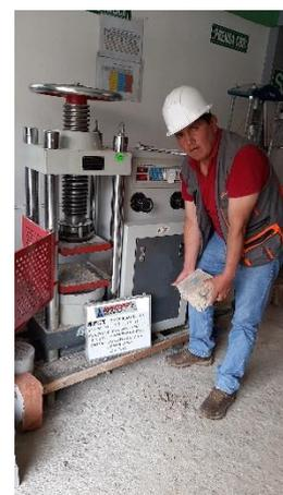
Figura 39: Ensayo resistencia a la compresión en ladrillos de concreto a los 28 días; grupos: patrón y adicionados con 1.00%, 1.50%, 2.00% y 2.50% de HPR y FC.
