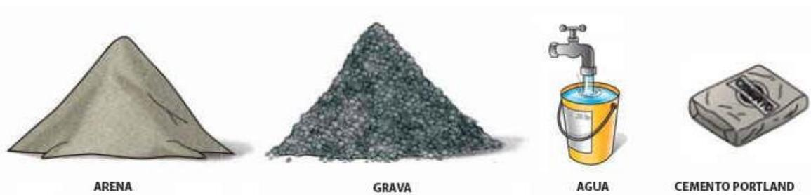
Figura 7. Material para ladrillo convencional de concreto.
