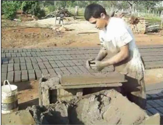
Figura 8. Elaboración artesanal de ladrillo de concreto.
