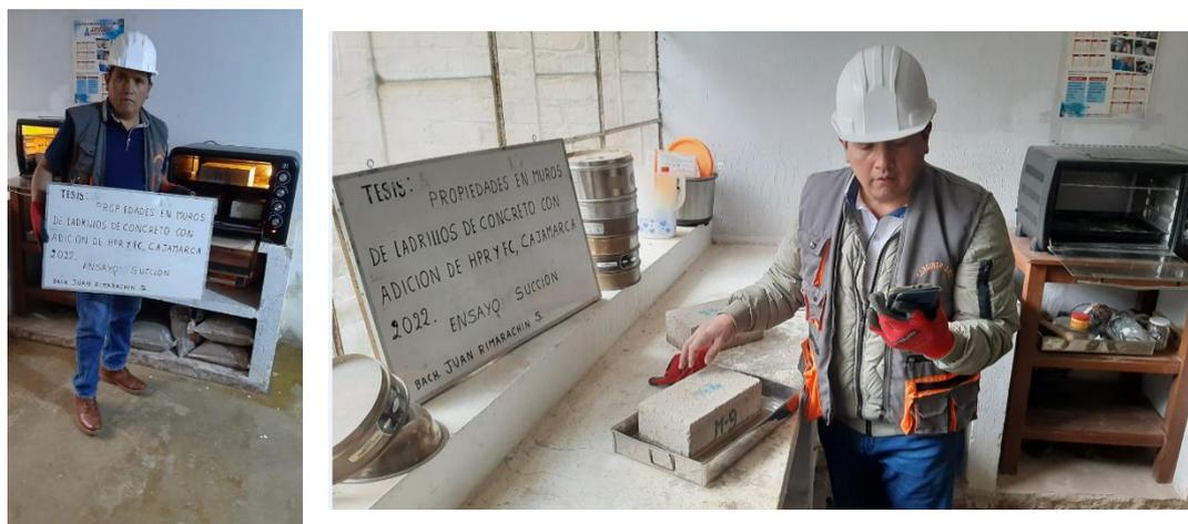
Figura 35: Ensayo físico de succión en ladrillos de concreto; grupos: patrón y adicionados con 1.00%, 1.50%, 2.00% y 2.50% de HPR y FC.
