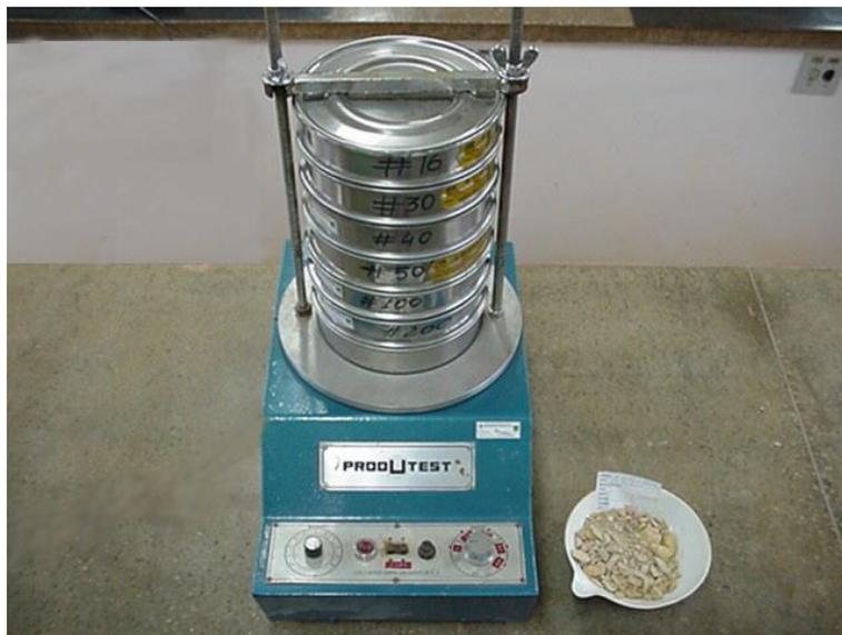
Figura 15. Ensayo de granulometría de agregados
