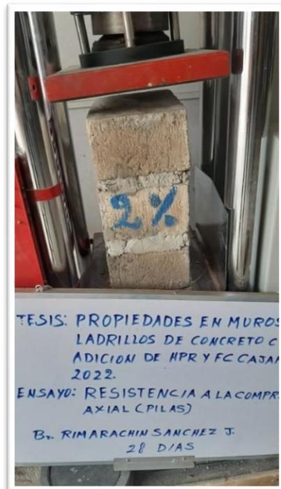
Evidencias fotográficas 37, 38 y 39, ensayo: resistencia a la compresión axial, 28 días.
