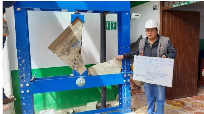
Figura 47: Ensayo resistencia a la compresión diagonal en muretes de ladrillos de concreto a los 14 días; grupos: patrón y adicionados con 1|,00%, 1.50%, 2.00% y 2.50% de HPR y FC.
