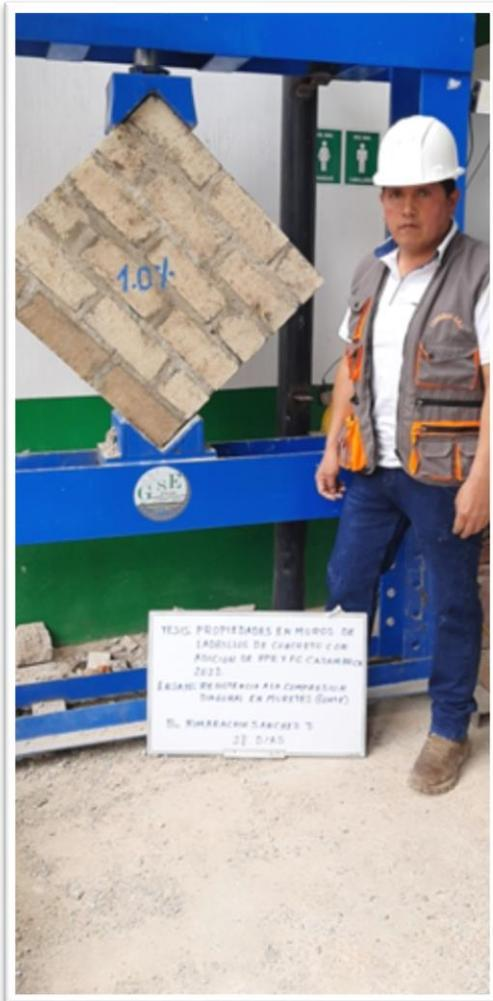
Evidencias fotográficas 42 y 43, ensayo: resistencia a la compresión diagonal, 28 días.
