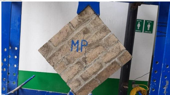
Figura 48: Ensayo resistencia a la compresión diagonal en muretes de ladrillos de concreto a los 28 días; grupos: patrón y adicionados con 1|,00%, 1.50%, 2.00% y 2.50% de HPR y FC.
