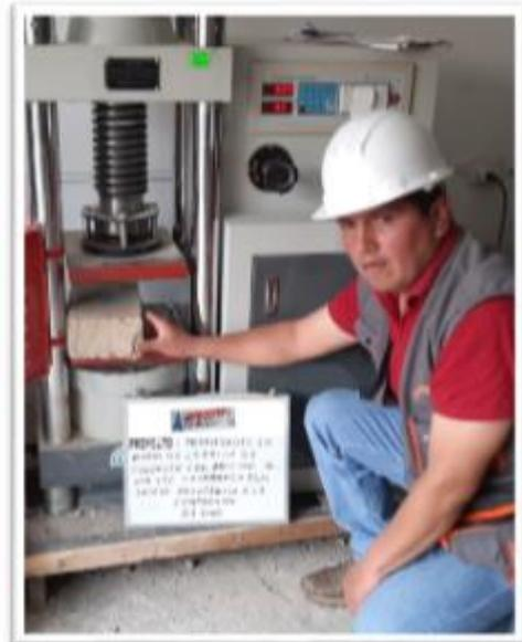
Evidencias fotográficas 27, 28 y 29, ensayo: resistencia a la compresión simple, 7, 14 y 28 días.
