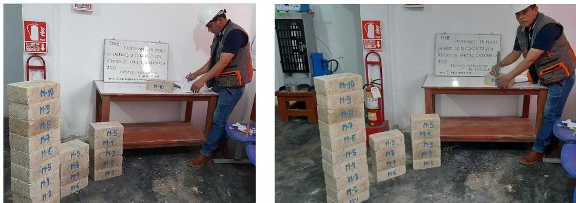
Figura 29: Ensayo físico de absorción en ladrillos de concreto; grupos: patrón y adicionados con 1.00%, 1.50%, 2.00% y 2.50% de HPR y FC.
