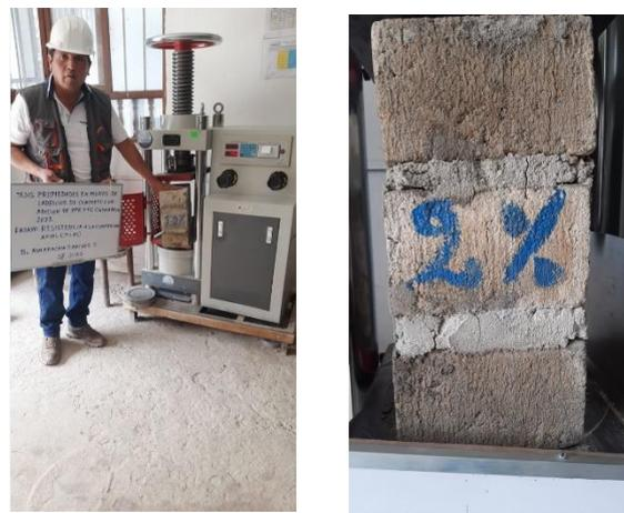
Figura 45: Ensayo resistencia a la compresión axial en ladrillos de concreto a los 28 días; grupos: patrón y adicionados con 1.00%, 1.50%, 2.00% y 2.50% de HPR y FC.
