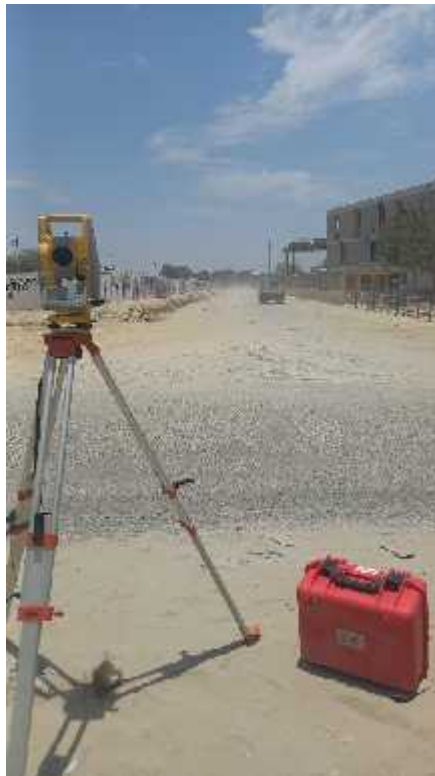
FIGURA N°10: Equipos utilizados para realizar levantamiento topográfico.
