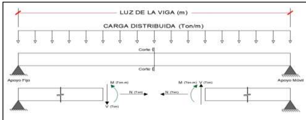
Figura 3. Representación del momento de arqueo, de las potencias de corte y de las potencias de cubo en el interior de un componente subyacente de tipo barra.
