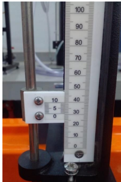
Figura 8. Vernier tomando medida de 30.9 mm.
