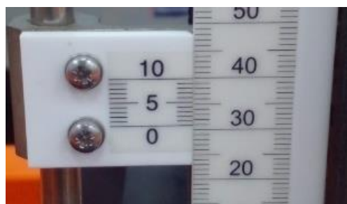
Figura 9. Vernier tomando medida de 30.9 mm. (zoom de figura 8)
