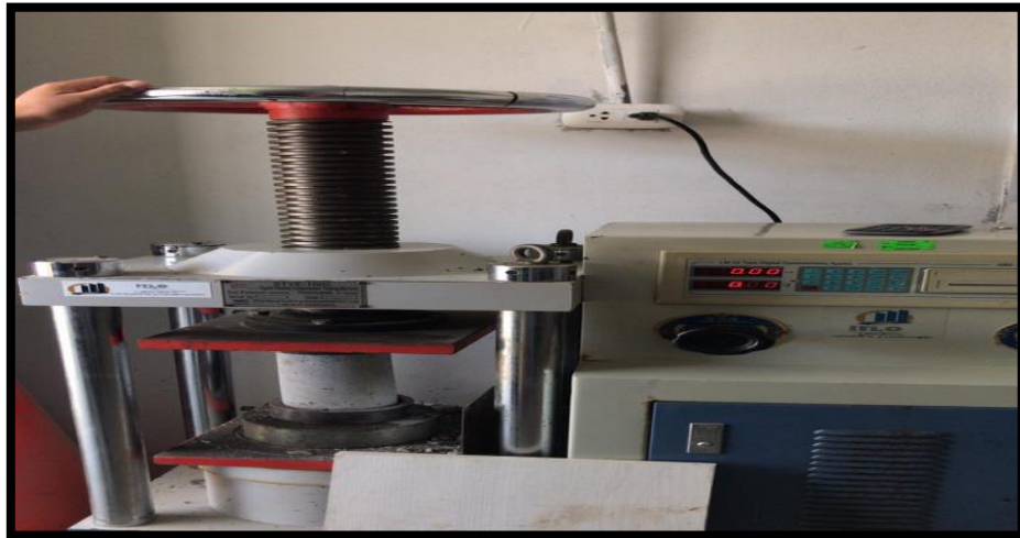
Imagen N ° 12.Ruptura de probetas
