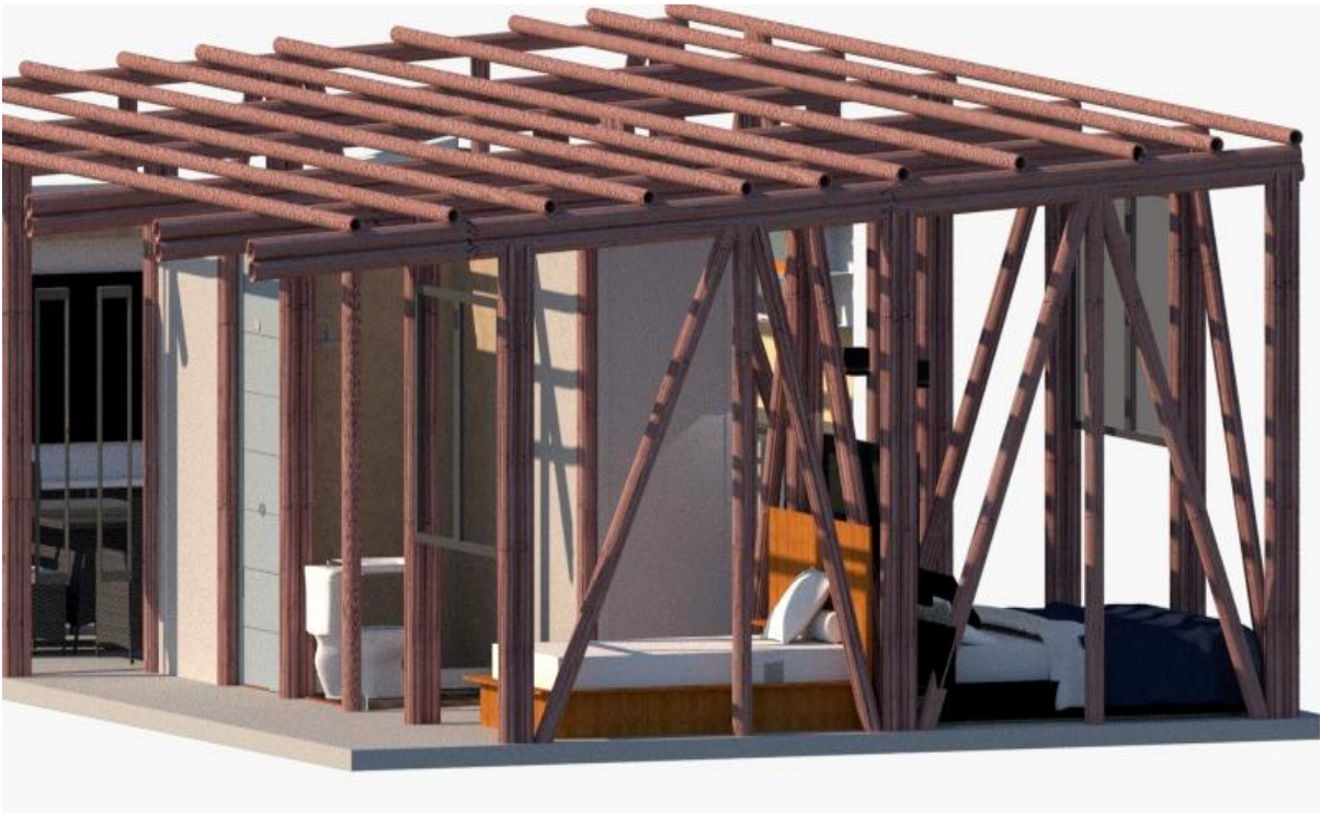
Vista de estructura de vivienda a base de bambú
