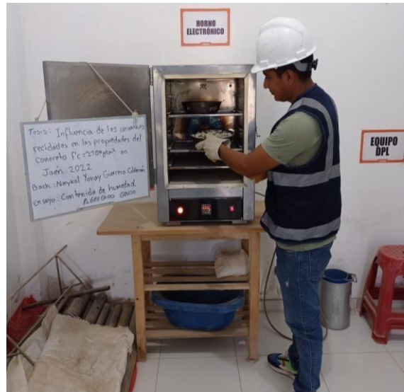
Foto 08: Ensayo de humedad de agregados
