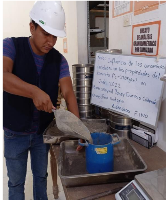
Foto 10: Ensayo de peso unitario de agregados
