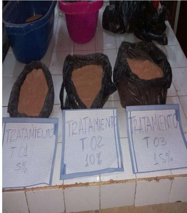
Foto 06: Polvo de cerámico reciclado para los diferentes tratamientos
