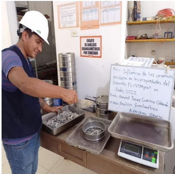
Foto 07: Ensayo de granulometría de agregados
