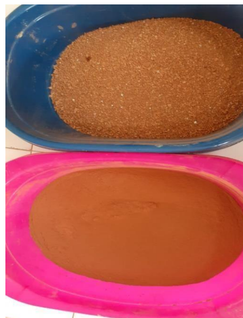
Foto 04: Polvo de cerámico reciclado luego del tamizado
