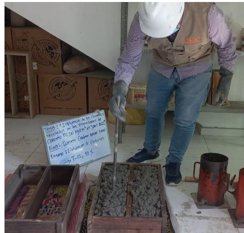
Foto 16: Elaboración probetas flexión
