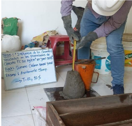
Foto 13: Medición de asentamiento
