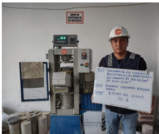
Foto 18: Ensayo de flexión del concreto
