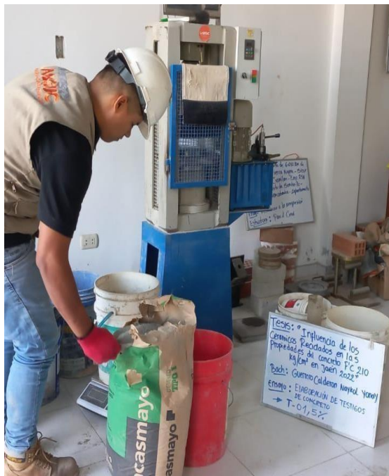
Foto 11: Pesado de materiales para concreto
