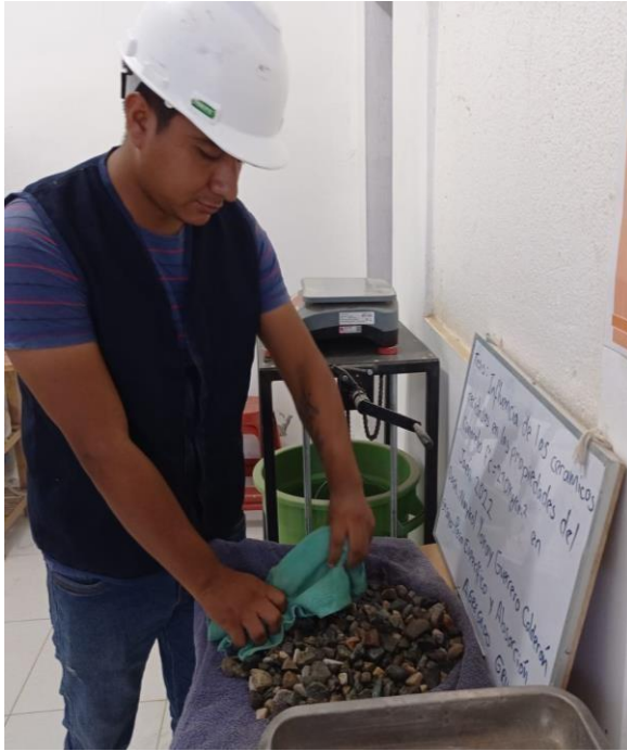
Foto 09: Ensayo de densidad y absorción
