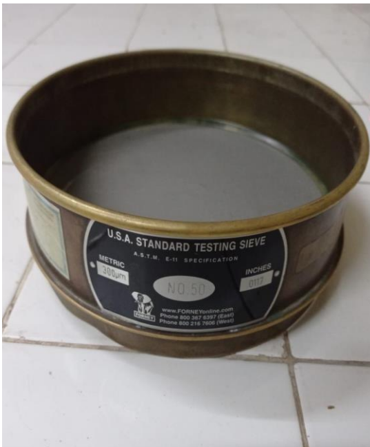
Foto 03: Malla N° 50 para tamizado del cerámico reciclado
