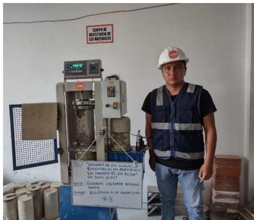
Foto 17: Ensayo de compresión del concreto
