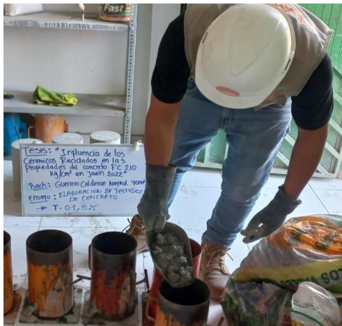
Foto 15: Elaboración probetas compresión
