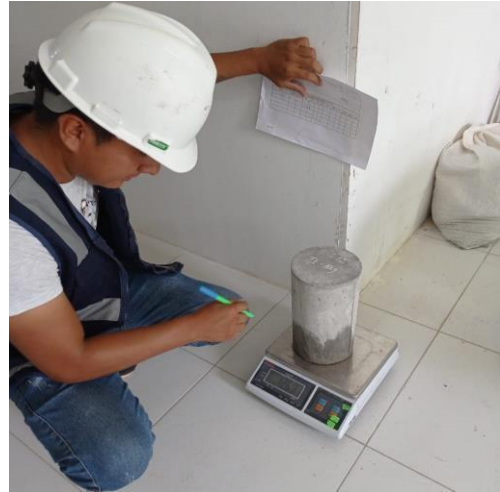
Foto 14: Pesando probetas para peso específico
