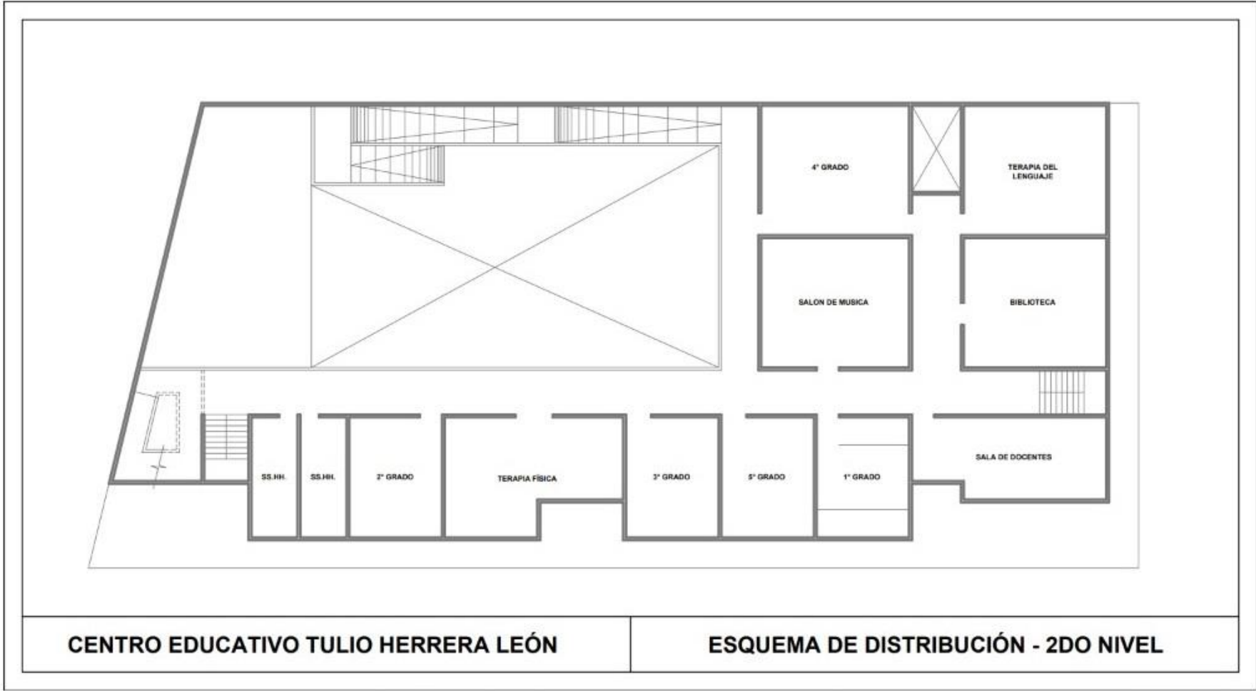
Figura 20: Distribución del 2do nivel
