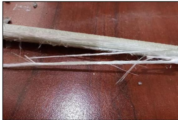
**Imagen 14 y 15.** Varilla de fibra de vidrio después del ensayo a tracción.
