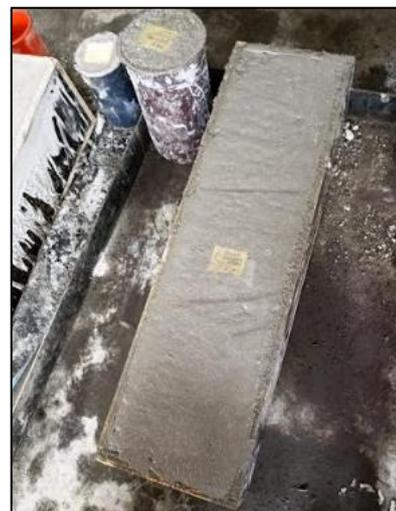
**Imagen 17.** Vaciado de viga con fibra de vidrio.
