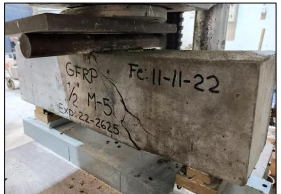
**Imagen 25 y 26.** Ensayo a flexión en vigas de fibra de vidrio con sección de 1/2”.
