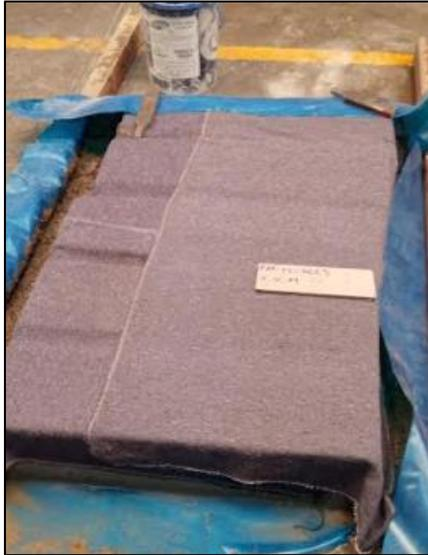
**Imagen 18.** Curado de viga con fibra de vidrio.
