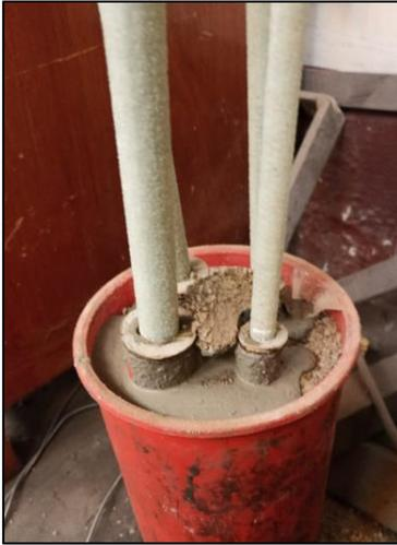
**Imagen 12.** Preparación de la fibra para el ensayo a tracción.
