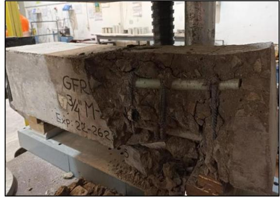
**Imagen 23 y 24.** Ensayo a flexión en vigas de fibra de vidrio con sección de 3/4”.
