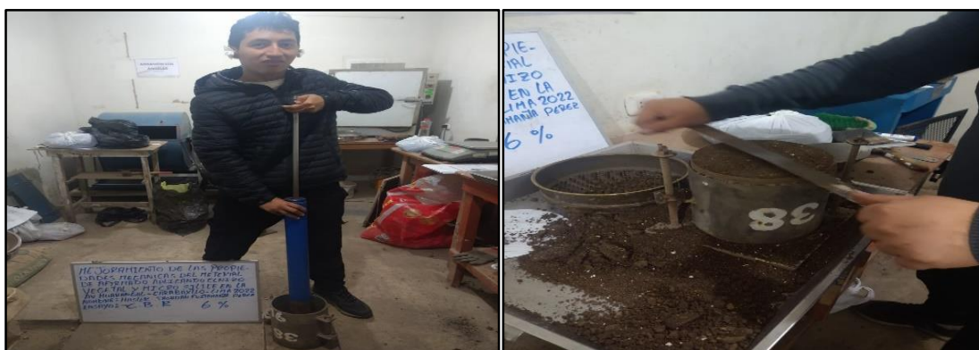
Figura 21. Compactación del suelo 5 capas cada 56 golpes
