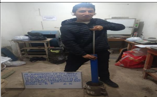
Imagen 7. Compactación del suelo cada 5 capas cada 56 golpes con pisón natural Fuente: Elaboración propia.
