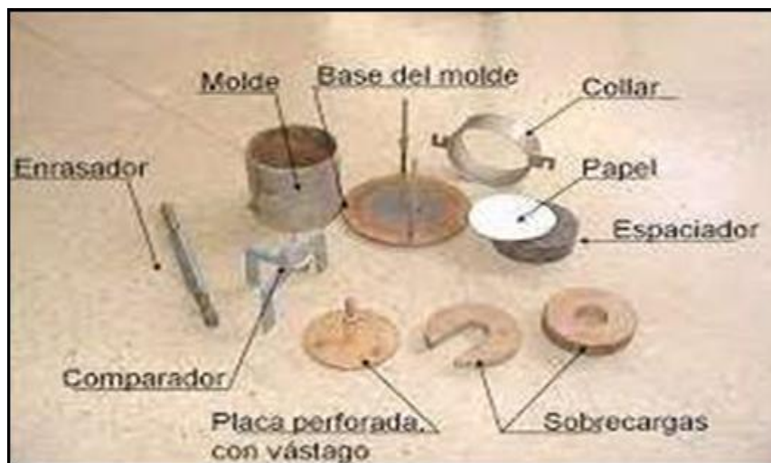
Figura 7. Materiales para el ensayo de CBR
