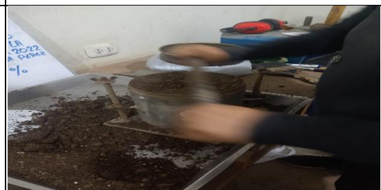
Imagen 8. Colocación de la última capa para el molde del CBR Fuente: Elaboración propia
